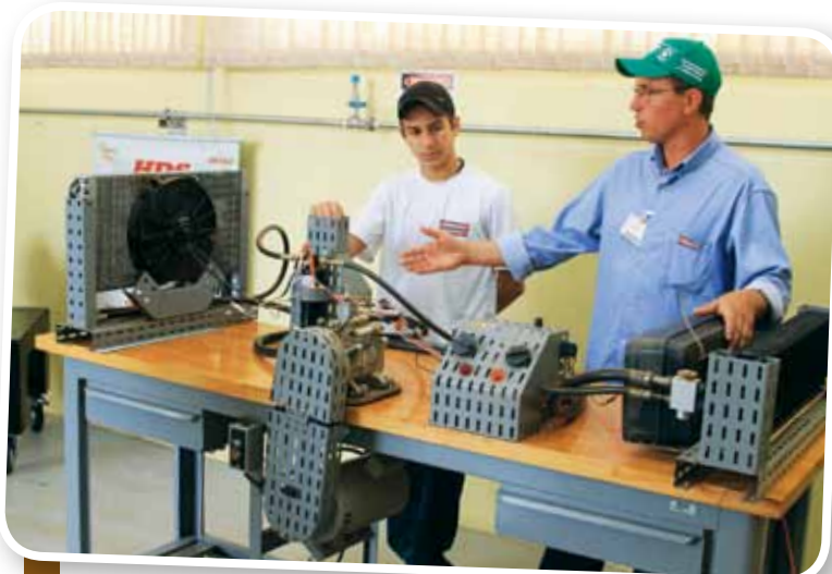
Bancada com vários modelos de ar condicionado de tratores e caminhões
