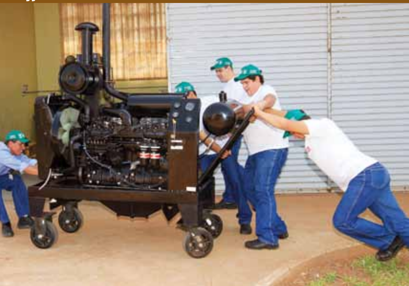
Bancada com o motor de trator Valtra MWM 6 cilindros, onde os alunos aprendem a regular e consertar
