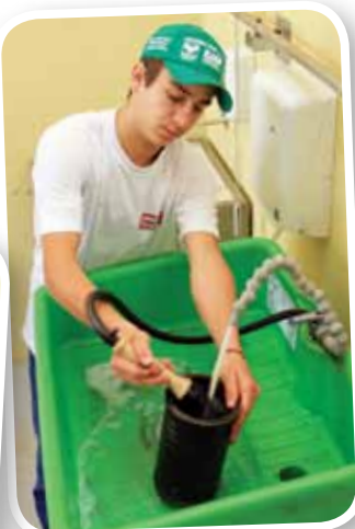
BIO-CIRCLE: máquina de lavagem de peças pelo sistema de bioremediação, totalmente natural, que substitui o uso de solventes tóxicos
