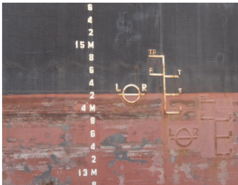
Figura 25. Marcas no casco do navio, utilizadas para o cálculo do volume embarcado. Fonte: ESALQ-LOG (2013).
