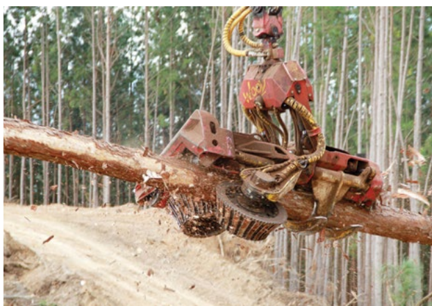
Foto 3 - Após a movimentação das toras, a máquina faz a limpeza dos galhos e o corte de acordo com as especificações (de comprimento e diâmetro) - quatro ou cinco metros. Ela também organiza essa madeira na beira da estrada para facilitar o transporte para os caminhões.
