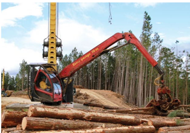
Foto 2 - O operador de dentro da cabine da torre divide com a equipe que está na base o içamento das toras por cabos aéreos ao longo da encosta até o local onde a máquina está instalada.
