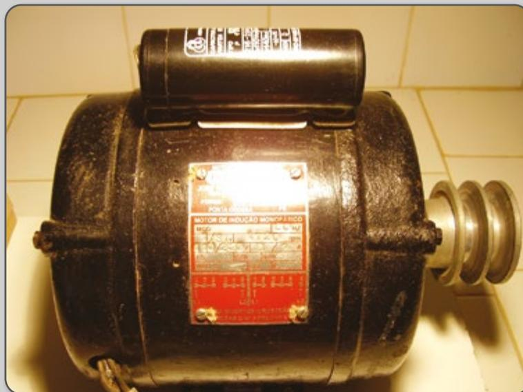
O sistema de partida é automático e funciona com capacitores eletrolíticos. Esses motores possuem dois enrolamentos distintos: **enrolamento auxiliar** para ajudar na partida (é desligado automaticamente depois) e o **enrolamento principal** que permanece ligado durante todo o tempo de funcionamento do motor.
