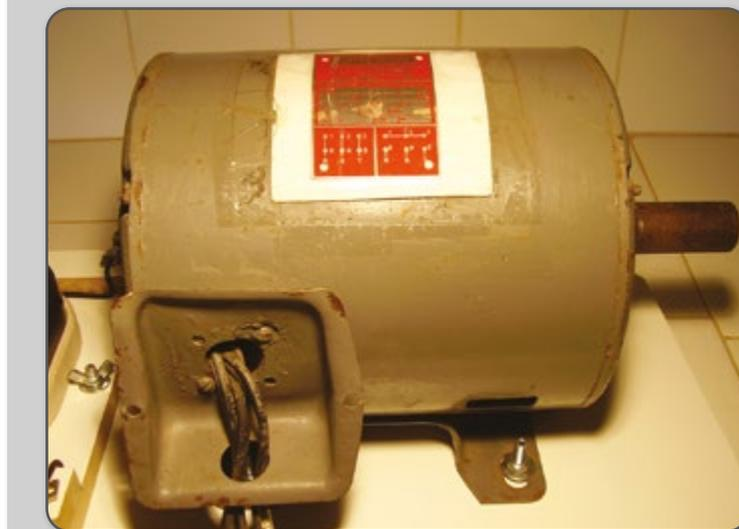
Os motores trifásicos podem ser instalados em duas ligações diferentes: **ligação triângulo** (220V), e **ligação estrela** (380V).
