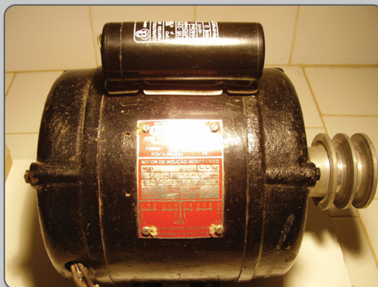
Figura 23 – Motor elétrico monofásico (presença de capacitor).
