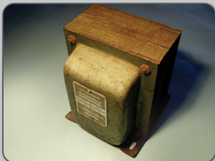
2 Transformador de força.
