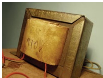
2. Transformador de aparelhos eletrônicos.
