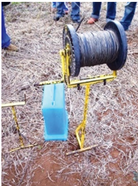
Figura 29 – Montagem de um equipamento de cerca elétrica simples.
