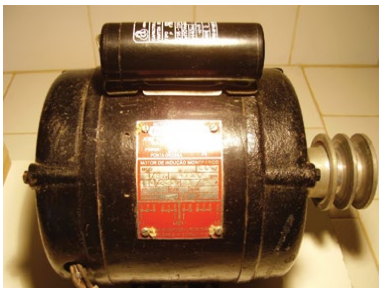
Figura 23 – Motor elétrico monofásico (presença de capacitor).
