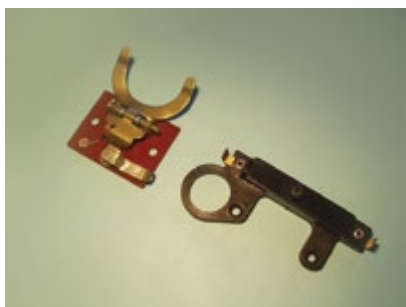
1. Platinados de motores.
