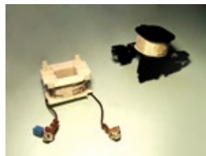
4. Bobinas de contactores.
