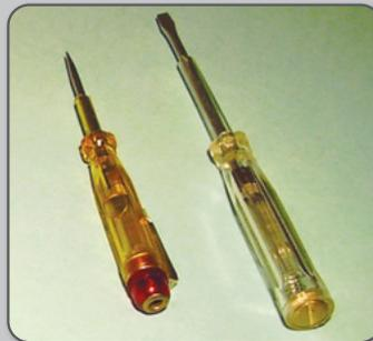
**Lâmpada de prova:** é um teste simples usado para verificar tensões de redes e continuidade de circuitos.
