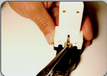
**23** Colocar a porca de fixação no segundo soquete (com porta starter).
