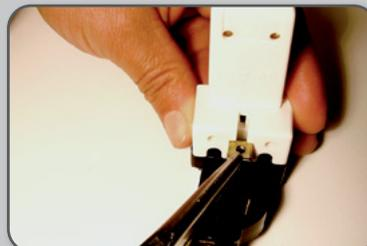
**23** Colocar porca de fixação no segundo soquete (com porta starter).
