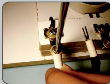
**4** Fixar um dos terminais do cabo de força no terminal de entrada da chave.
