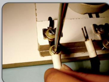
**5** Fixar um dos terminais do cabo de força no terminal de entrada da chave.
