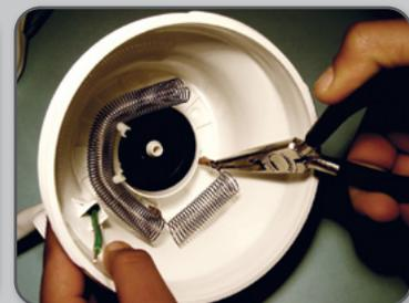
**10** Colocando a resistência nova.
