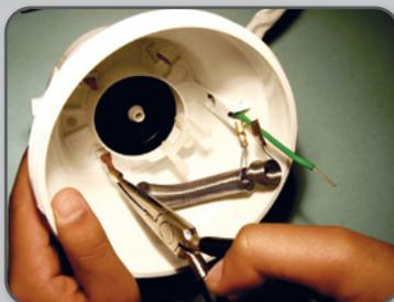
**8** Colocando a resistência nova.
