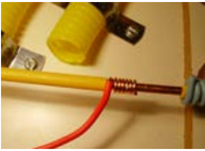
10. Fio vermelho fixado na rede.
