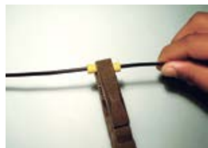
3. Inserir as pontas dos fios e apertar com alicate.
