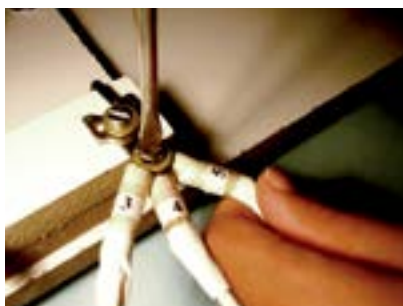
Figura 150 – Fazendo a inversão da rotação (trocar terminal do motor 5 pelo 6).
