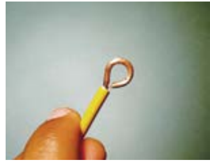
3. Anel com a ponta para a direita.
