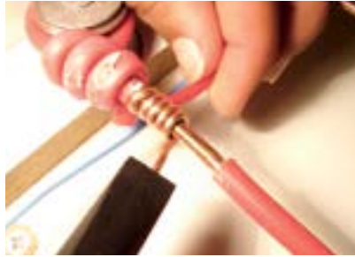
10. Fixar o fio vermelho com alicate.
