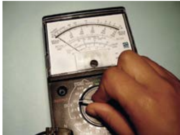
Figura 26 – Posicionando o seletor de funções no ponto 10DCV.
