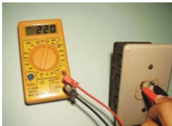
Figura 37 – Medindo tensões em redes de corrente alternada (220V).
