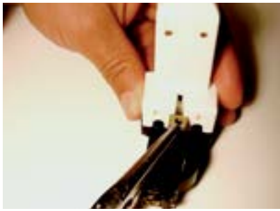
35. Colocar a porca de fixação no segundo soquete (com porta-starter).
