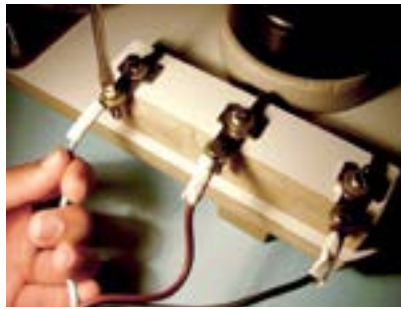
5. Fixar o cabo de força nos 3 terminais de entrada na chave.
