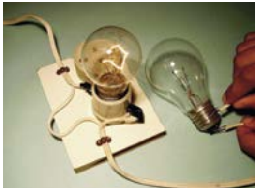
Figura 50 – Lâmpada de prova acesa indica que existe continuidade (lâmpada boa).
