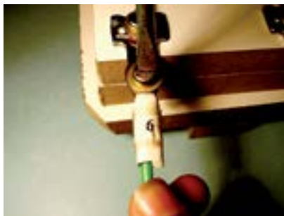
Figura 158 – Instalando um motor elétrico trifásico na rede de 380V (tensão maior ou em estrela).
