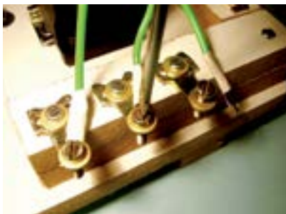
10. Fixar fio L2 do contactor no terminal de entrada do meio.
