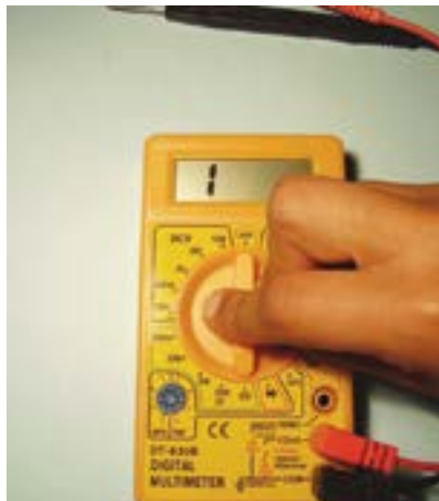
Figura 42 – Posicionando o seletor de funções em 200 \Omega .
