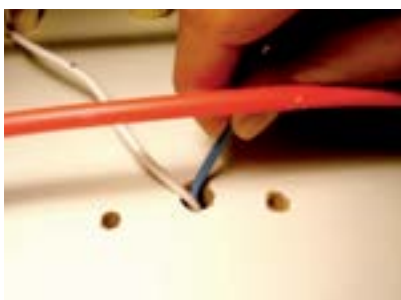
13. Introduzir fio azul junto com o branco no furo.
