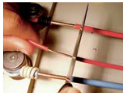
6. Desencapar a ponta do fio vermelho (10cm).
