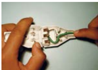
7. Alojjar fio terra no canal.
