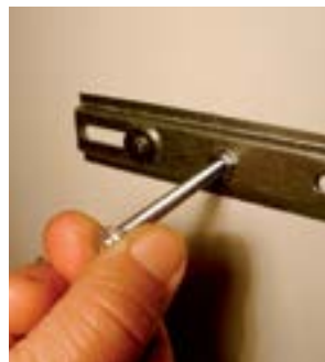
41. Retirar a porca da ponta do parafuso.
