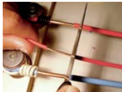
6. Descapar a ponta do fio vermelho (10cm).
