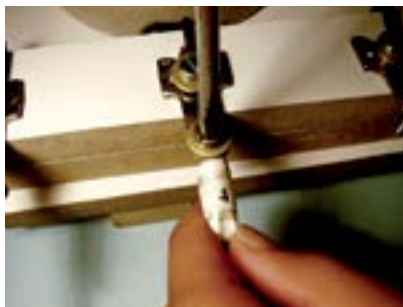
Figura 158 – Instalando um motor elétrico trifásico na rede de 380V (tensão maior ou em estrela).
