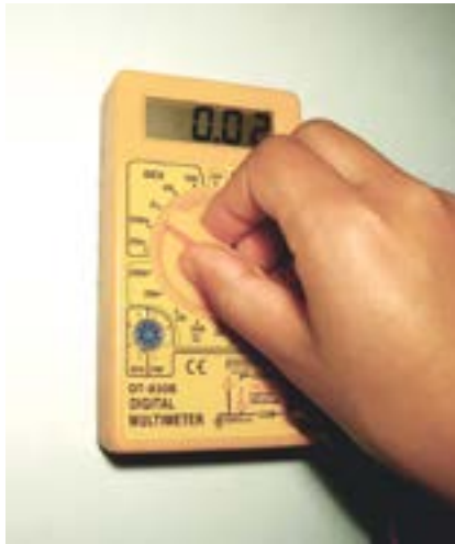
Figura 33 – Posicionando o seletor de funções em 20DCV.
