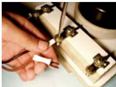
Figura 159 – Fazendo a inversão da rotação (trocar de lugar dois fios nos terminais na entrada da chave).
