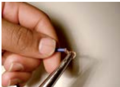
40. Fazer anel (olhal) nas pontas dos fios azuis do reator.
