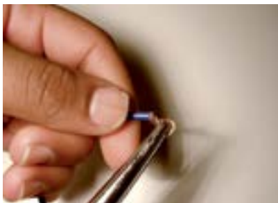
28. Fazer anéis (olhais) nas pontas dos fios azuis do primeiro reator.
