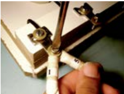
Figura 152 – Instalando um motor elétrico monofásico na rede de 220V (tensão maior ou em série).
