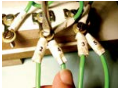
20. Fixar os terminais 2 e 4 do motor no terminal de saída do meio.
