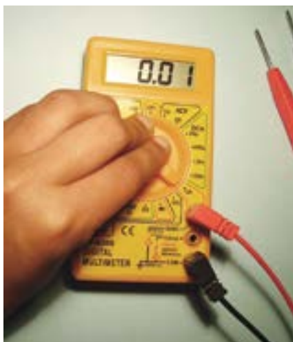
Figura 39 – Posicionando o seletor de funções em 10A.
