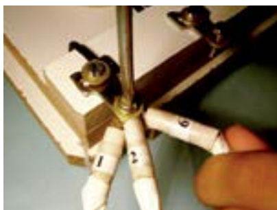
Figura 150 – Fazendo a inversão da rotação (trocar terminal do motor 5 pelo 6).
