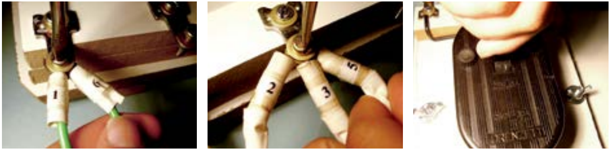
Figura 153 – Fazendo a inversão da rotação (trocar terminal do motor 5 pelo 6).
