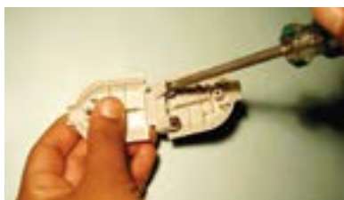
5. Soltar parafuso de fixação.
