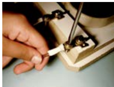
Figura 159 – Fazendo a inversão da rotação (trocar de lugar dois fios nos terminais na entrada da chave).
