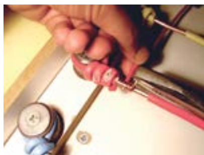
4. Fixar fio vermelho com alicate.
