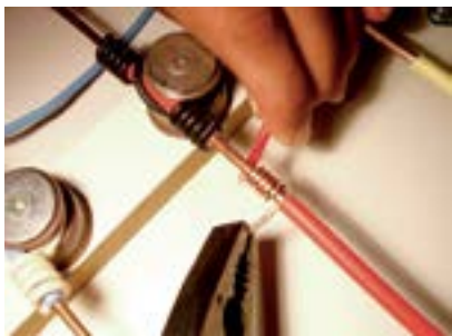
7. Fixar fio vermelho com alicate.
