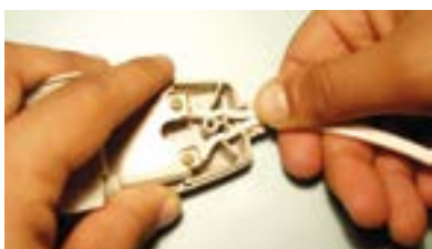
16. Alojamento dos cabos no plugue.
