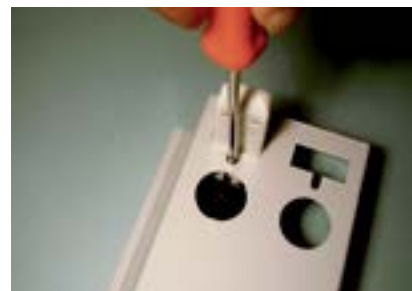
25. Fixar o segundo soquete (com porta starter) na calha.
