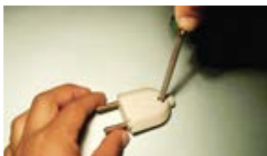
2. Retirar parafuso do plugue macho.
