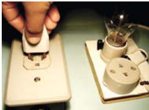
Figura 56 – Conectando o pino da lâmpada de prova a uma tomada energizada.
