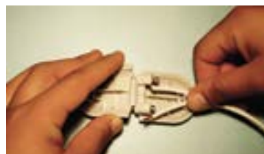
6. Fixar os cabos nos pinos.
