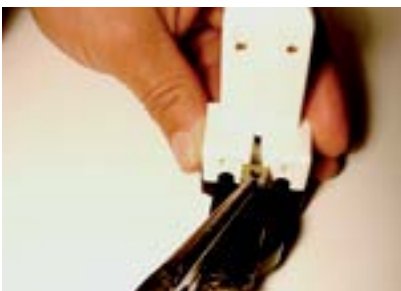
23. Colocar a porca de fixação no segundo soquete (com porta starter).
