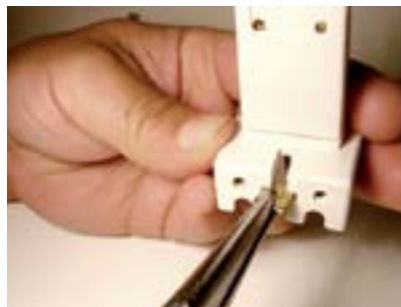
20. Colocar a porca de fixação no primeiro soquete.
