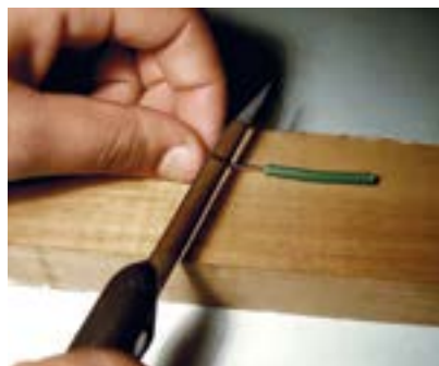
2. Retirar a capa da ponta do fio.
