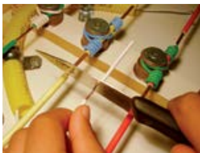
2. Descascar a ponta do fio (5cm).
