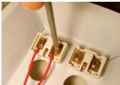
26. Fixar os fios vermelhos do primeiro reator no soquete.
