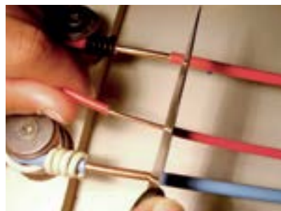
6. Desencapar a ponta do fio vermelho (10cm).
