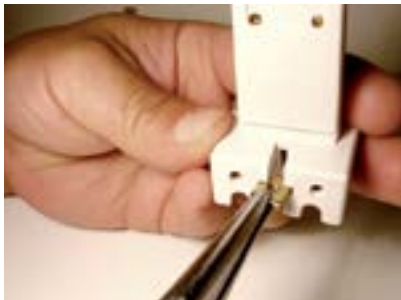
32. Colocar a porca de fixação no primeiro soquete.
