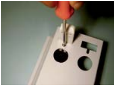
35. Fixar o segundo soquete na calha com parafuso.
