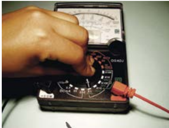
Figura 29 – Posicionando o seletor de funções em x1.
