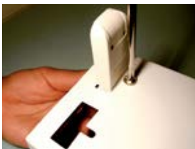
22. Fixar o primeiro soquete na calha com parafuso.
