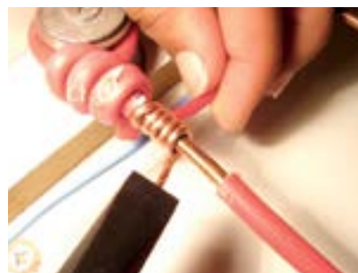
9. Fixar fio vermelho com alicate.
