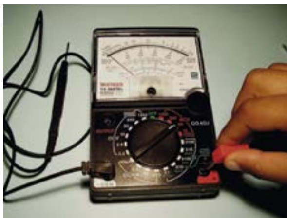
Figura 25 – Conectando as pontas de prova nos bornes.
