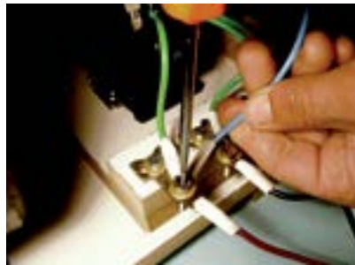
23. Fixar fio azul no terminal de entrada (L3).
