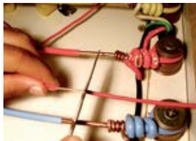
15. Desencapar a ponta do fio vermelho (10cm).
