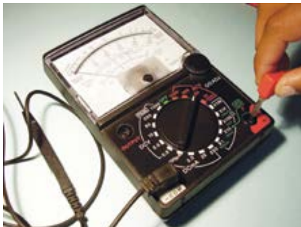
Figura 22 – Conectando as pontas de prova nos bornes.
