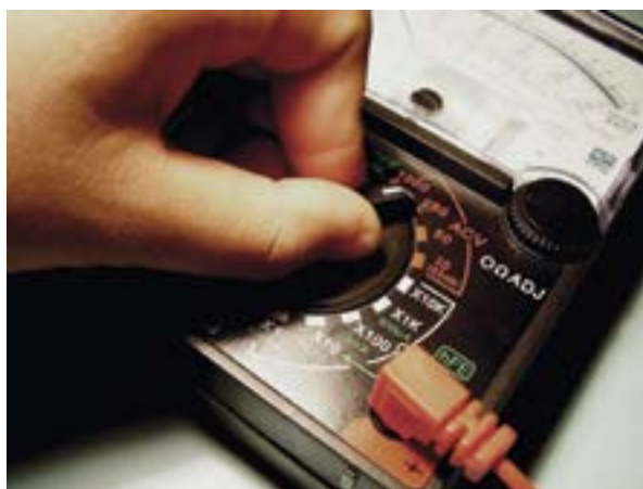
Figura 23 – Posicionando o seletor de funções no ponto de 250ACV.
