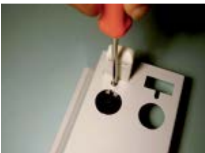
25. Fixar o segundo soquete (com porta starter) na calha.
