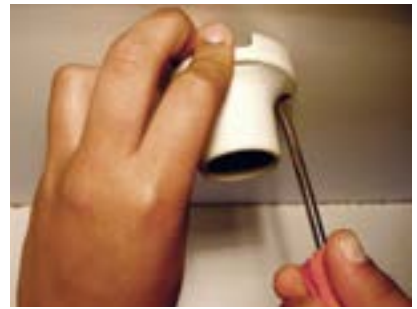
18. Fixar bocal com dois parafusos e porcas.
