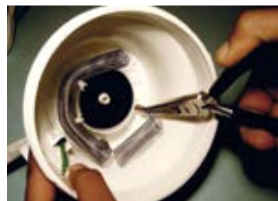
10. Colocando a resistência nova.
