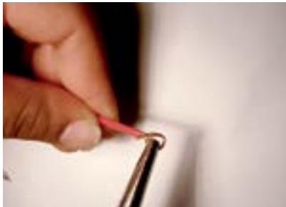
25. Fazer anéis (olhais) nas pontas dos fios vermelhos do primeiro reator.
