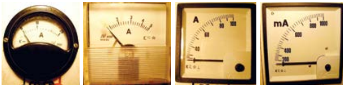
Figura 16 – Amperímetros analógicos de diversas capacidades e miliamperímetro.
