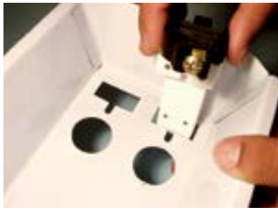
36. Introduzir o segundo soquete (com porta-starter) na calha.
