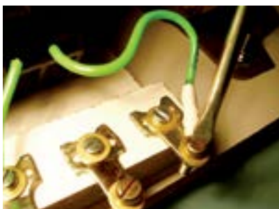
16. Fixar fio do T3 no terminal de saída direito.
