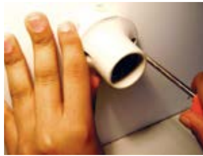
32. Fixar bocal com 2 parafusos e porcas.
