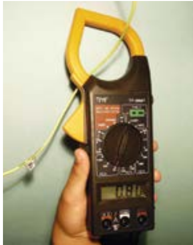
Figura 45 – Medindo a corrente alternada de um circuito com amperímetro alicate (0,80A).
