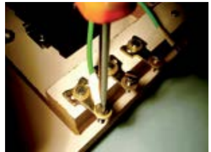
9. Fixar fio L3 do contactor no terminal de entrada esquerdo.
