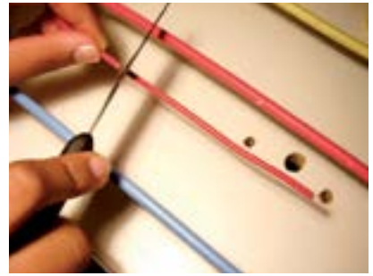
3. Desencapar a ponta do fio vermelho (10cm).
