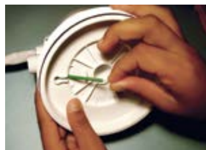
13. Endireitando fio terra.
