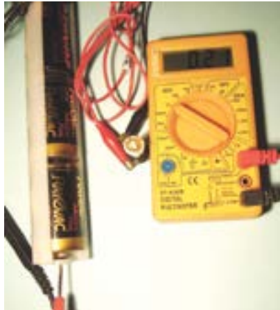
Figura 40 – Medindo corrente contínua de uma lâmpada de 4,5V (0,210A).
