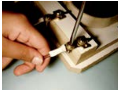
2. Fios trocados de lugar para inverter a rotação.
