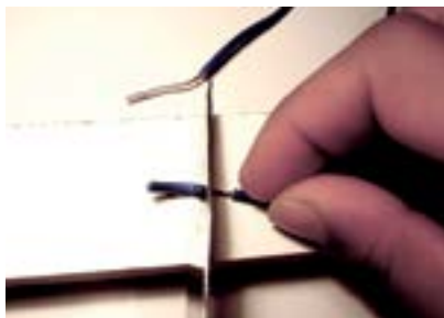
27. Desencapar as pontas dos fios azuis do reator (2,5cm).
