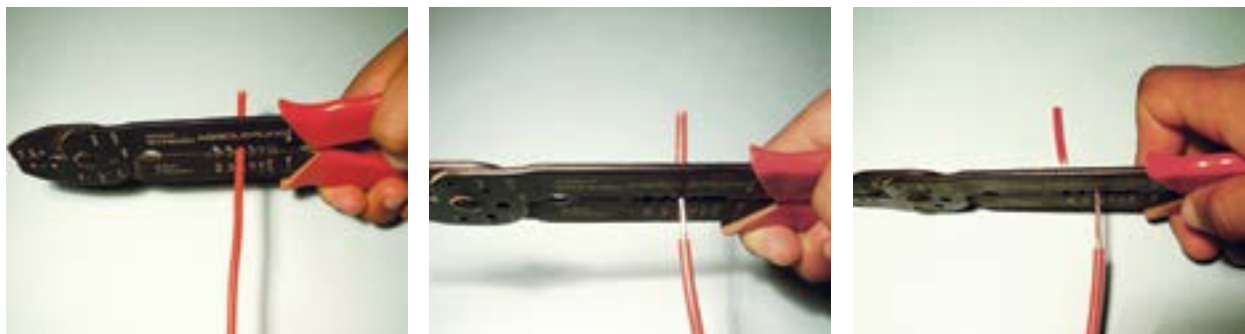
Figura 61 – Desencapando a ponta de condutores com alicates descascadores de fios.
