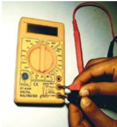
Figura 41 – Conectando as pontas de provas nos bornes.
