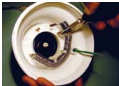
9. Colocando a resistência nova.
