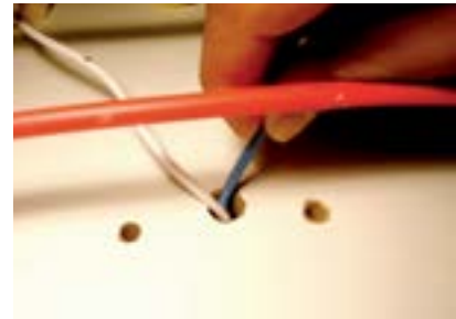
13. Introduzir fio azul junto com o branco no furo.
