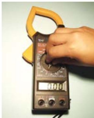
Figura 44 – Posicionando o seletor de funções do amperímetro alicate em 20ACA.
