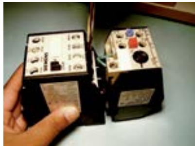
5. Fixar o relê térmico no contactor.
