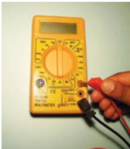
Figura 38 – Conectando as pontas de prova nos bornes.
