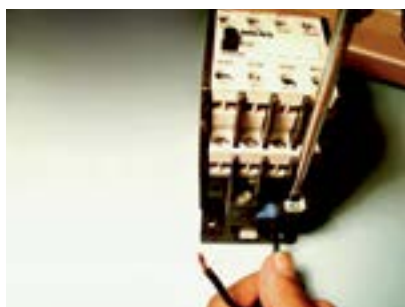
1. Fixar fio no A2 do contactor.
