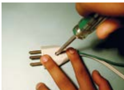
8. Colocar o parafuso no plugue.
