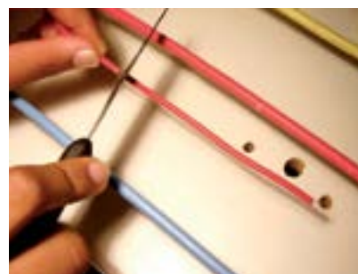
3. Descapar a ponta do fio vermelho (10cm).
