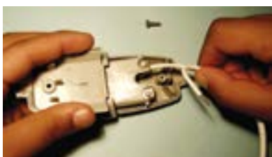
13. Soltar parafuso de fixação.
