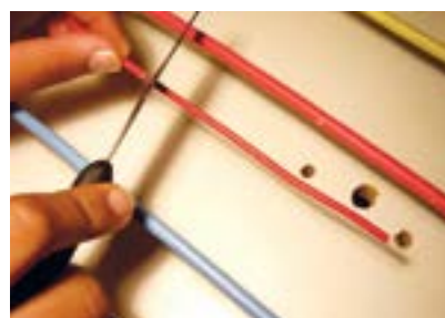
3. Desencapar a ponta do fio vermelho (10cm).
