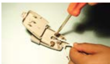
14. Fixar cabos nos pinos.
