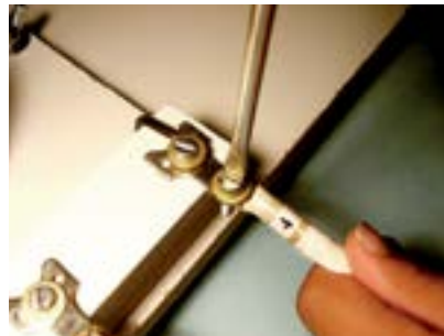
Figura 152 – Instalando um motor elétrico monofásico na rede de 220V (tensão maior ou em série).
