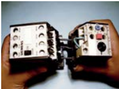
4. Acoplar o relê térmico ao contactor.
