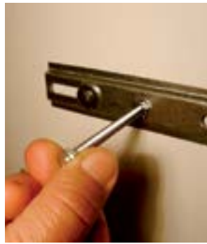
51. Retirar a porca da ponta do parafuso.
