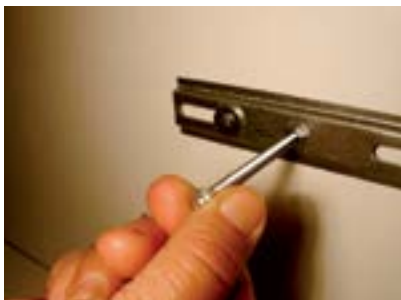
48. Retirar a porca da ponta do parafuso.
