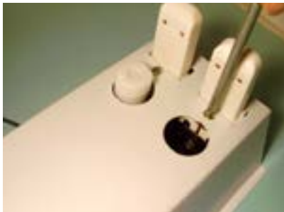
39. Fixar o soquete da segunda lâmpada (com porta starter).
