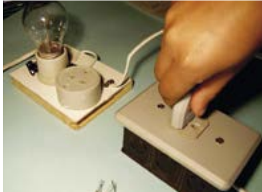
Figura 49 – Conectando o pino da lâmpada de prova numa tomada energizada.
