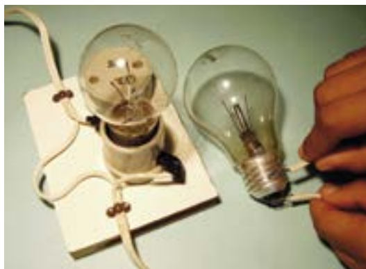
Figura 51 – Lâmpada de prova apagada indica que não existe continuidade (lâmpada queimada).
