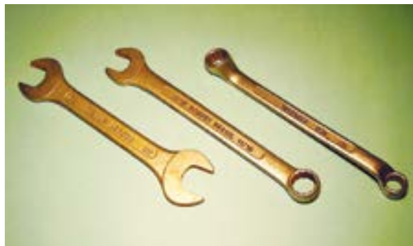
Figura 12 – Chaves fixas (de boca, combinada e estriada).
