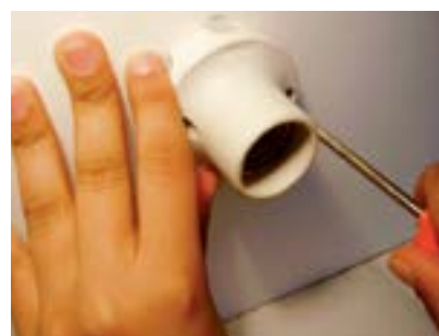
12. Fixar bocal com 2 parafusos e porcas.
