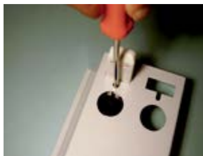
23. Fixar o segundo soquete na calha com parafuso.
