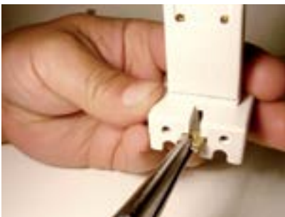
32. Colocar a porca de fixação no primeiro soquete.
