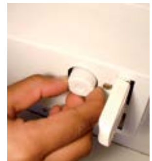
43. Colocar starter no porta starter e girar para a direita.
