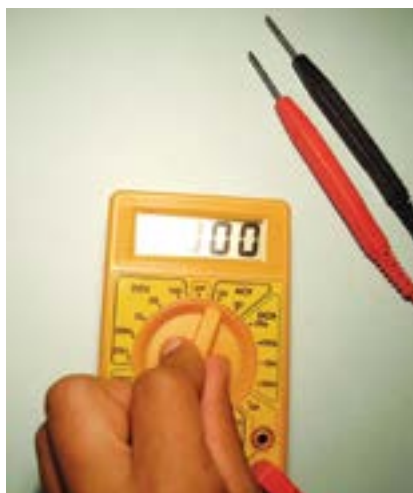
Figura 36 – Posicionando o seletor de funções em 750ACV.
