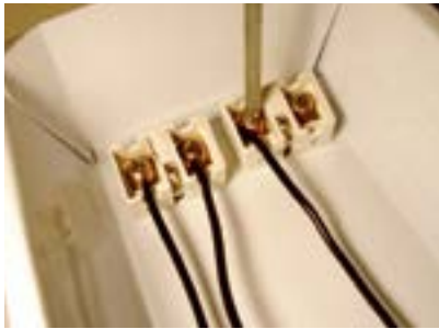
42. Fixar fio no primeiro soquete da segunda lâmpada.
