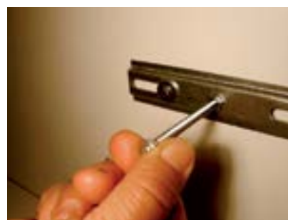
47. Retirar a porca da ponta do parafuso.
