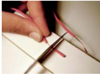
36. Desencapar as pontas dos fios vermelhos do reator (2,5cm).
