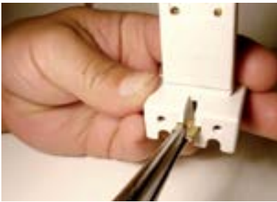
20. Colocar a porca de fixação no primeiro soquete.
