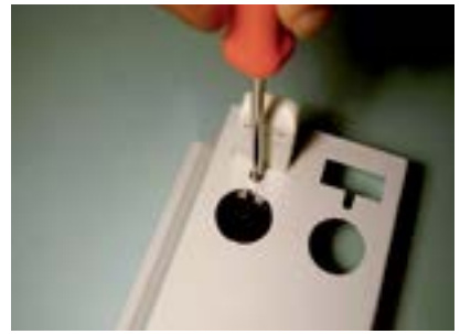
37. Fixar o segundo soquete (com porta-starter) na calha.
