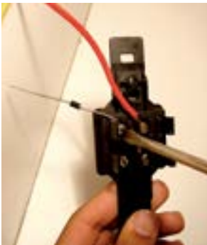
13. Fixar um dos terminais do diodo no parafuso de cima do interruptor.
