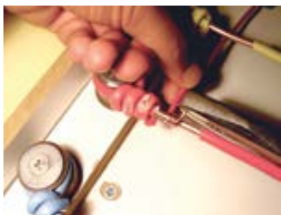
4. Fixar fio vermelho com alicate.
