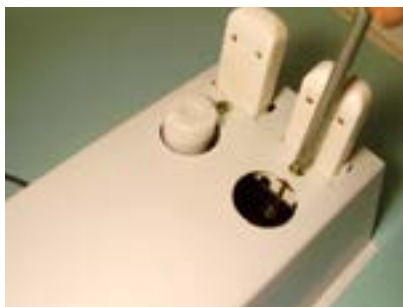
37. Fixar segundo soquete (com porta starter) da segunda lâmpada.
