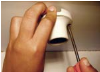
19. Fixar bocal com dois parafusos e porcas.
