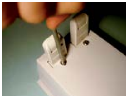
36. Fixar primeiro soquete da segunda lâmpada com parafuso.
