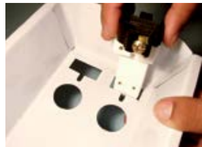
24. Introduzir o segundo soquete (com porta starter) na fenda da calha.
