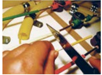
21. Desencapar a ponta do fio (5cm).
