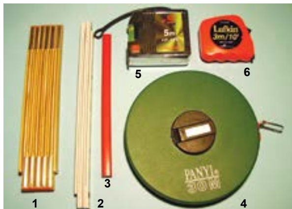
1 e 2. Metros de carpinteiro. 3. Lápis de carpinteiro. 4. Trena de 30m. 5. Trena de bolso com nível. 6. Trena de bolso.
