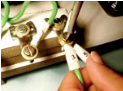
19. Fixar os terminais 3 e 5 do motor no terminal de saída direto.
