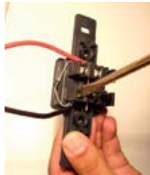
14. Fixar o outro terminal do diodo juntamente com o fio preto no parafuso de baixo do interruptor.
