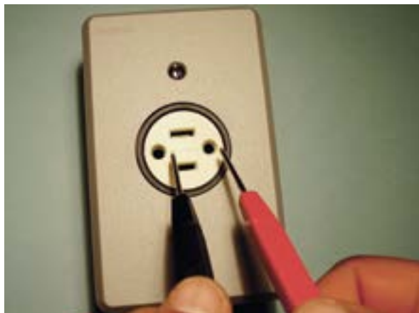
Figura 24 – Medindo tensões de redes de corrente alternada.
