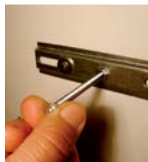
36. Retirar a porca da ponta do parafuso.
