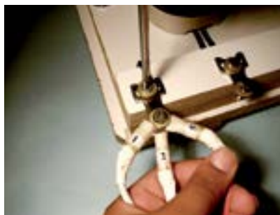
2. Fixar os 3 terminais no terminal esquerdo na saída da chave.
