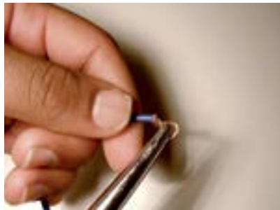
29. Fazer anel (olhal) nas pontas dos fios azuis do reator.
