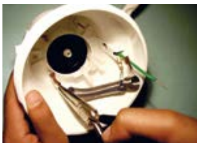
8. Colocando a resistência nova.
