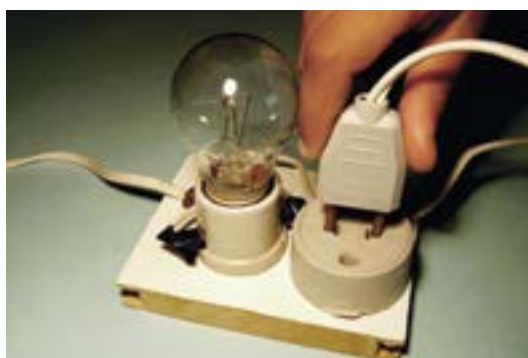
Figura 54 – Conectando o pino da lâmpada de prova na sua própria tomada.
