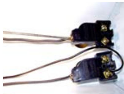
41. Fixar o fio no segundo porta starter.
