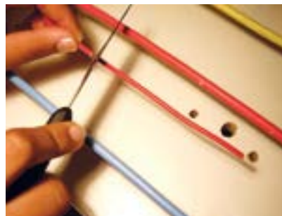
3. Desencapar a ponta do fio vermelho (10cm).
