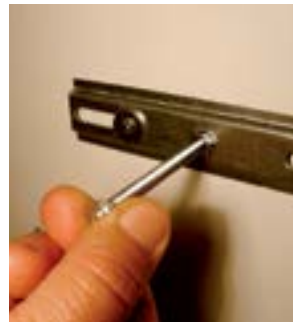
39. Retirar a porca da ponta do parafuso.
