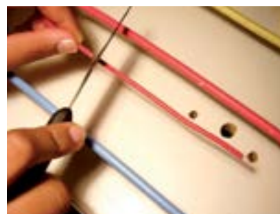
3. Desencapar a ponta do fio vermelho (10cm).
