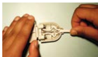
9. Cabos alojados no plugue.
