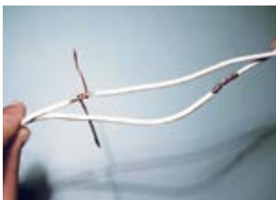
5. Ajustar as emendas puxando os cabos.
