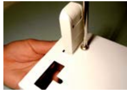
22. Fixar o primeiro soquete na calha com parafuso.
