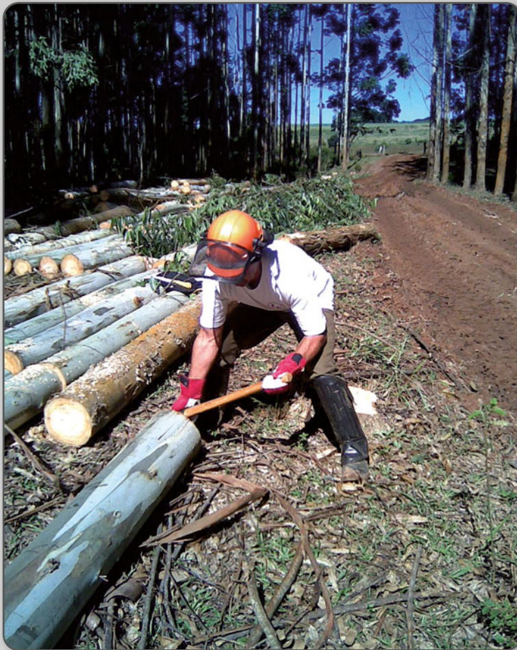
Figura 8 – Movimentação de madeira com machado (deslocamento lateral).
