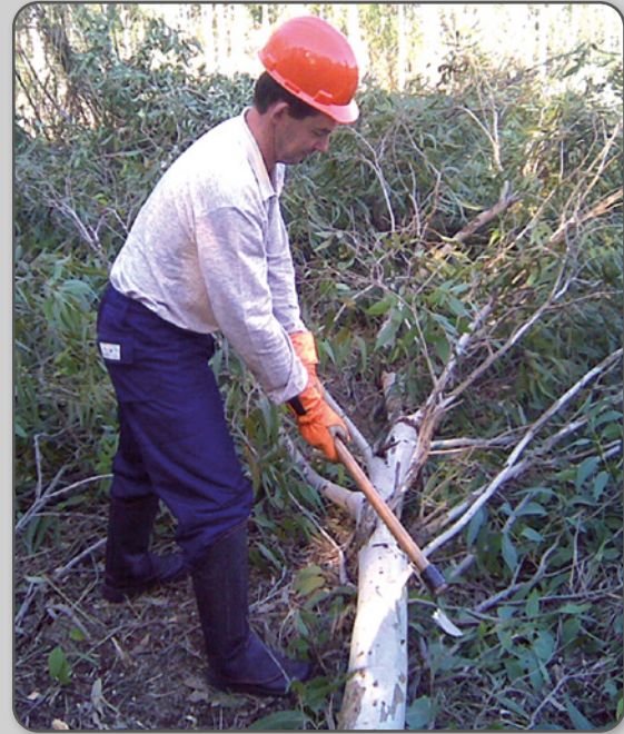
Figura 6 – Posicionamento e empunhadura correta durante desgalhamento com machado.
