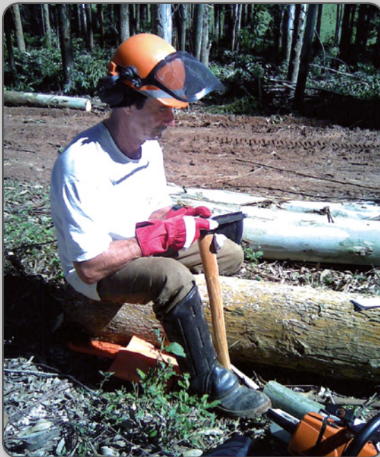
Figura 5 – Procedimento recomendado para afiação do machado.
