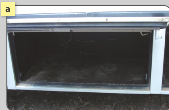
Figura 17 – Locais adequados para transporte em veículos de ferramentas manuais de corte: a) Bagageiro (ônibus de transporte de trabalhadores) e b) Reboque em veículo de transporte rural.
