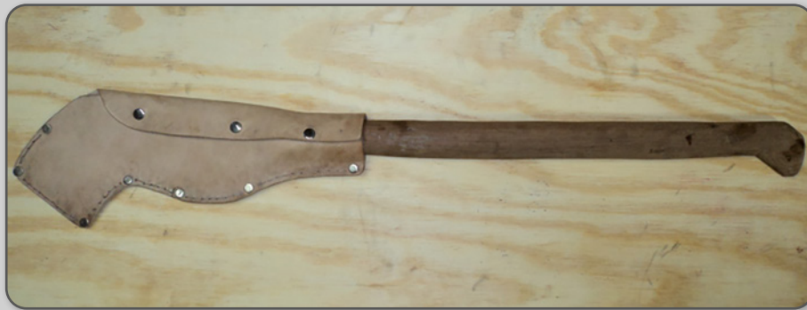
Figura 16 – Proteção do fio de corte da foice.
