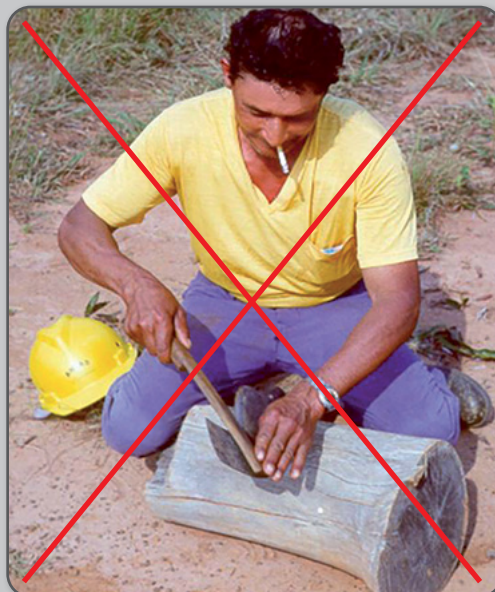
Figura 13 – Procedimentos incorretos para afiar a foice.
