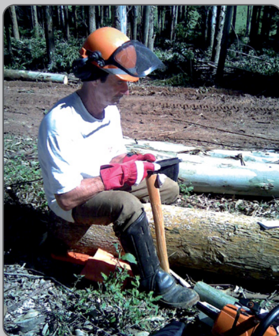
Figura 5 – Procedimento recomendado para afiação do machado.
