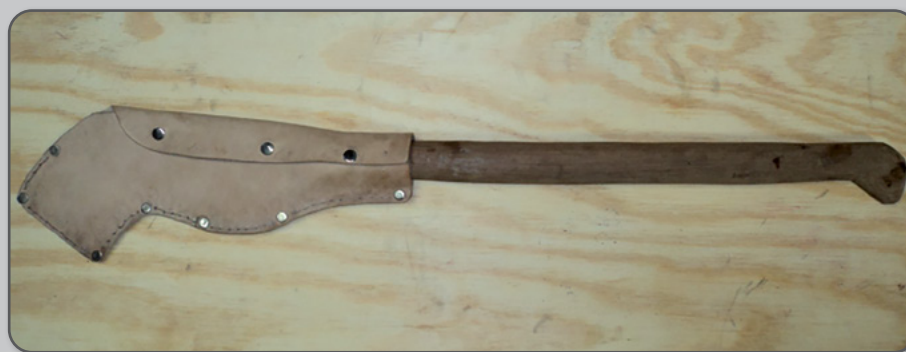
Figura 16 – Proteção do fio de corte da foice.
