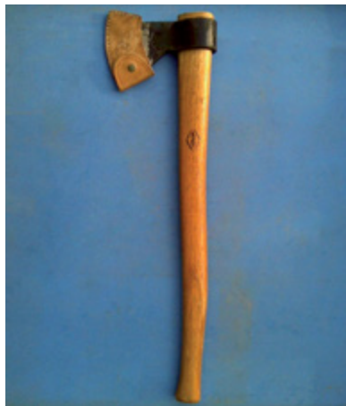
Figura 10 – Machado com bainha protetora.
