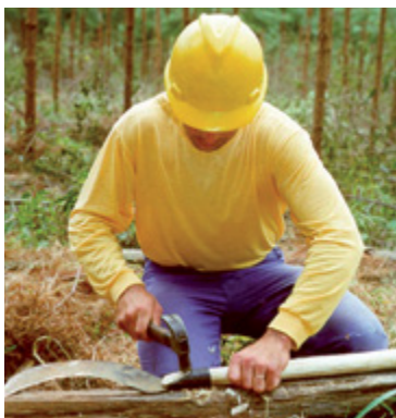
Figura 12 – Trabalhador realizando o encabamento da foice.
