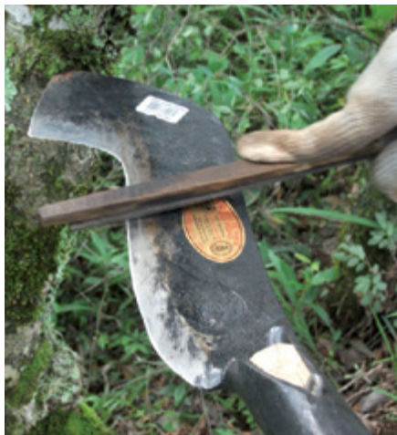
Figura 15 – Procedimentos corretos para afiação da foice.
