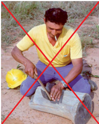
Figura 16 – Procedimentos incorretos para afiar a foice.
