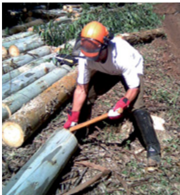
Figura 8 – Movimentação de madeira com machado (deslocamento lateral).
