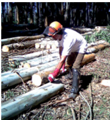
Figura 9 – Movimentação de madeira com machado (deslocamento longitudinal).
