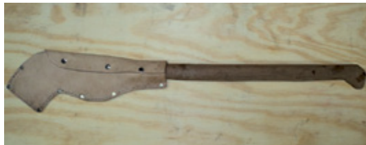
Figura 19 – Proteção do fio de corte da foice.
