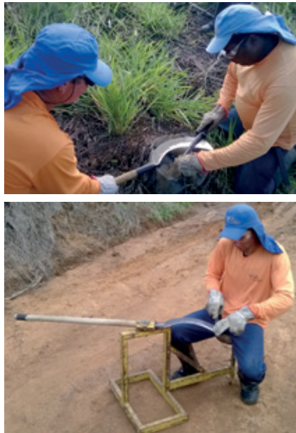
Figura 14 – Procedimentos para afiação de despalme (em dupla ou cavalete).
