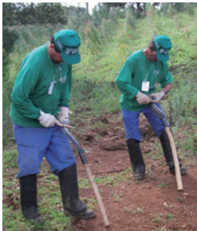
Figura 15 – Procedimentos corretos para afiação da foice.
