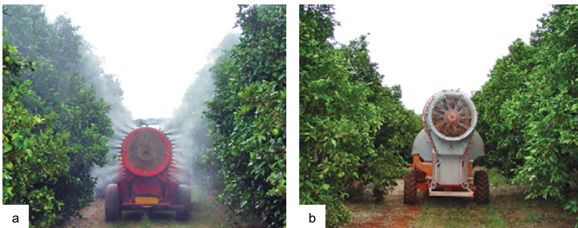
Figura 14 – Turbina muito baixa para a cultura (a), turbina na altura adequada (b).
