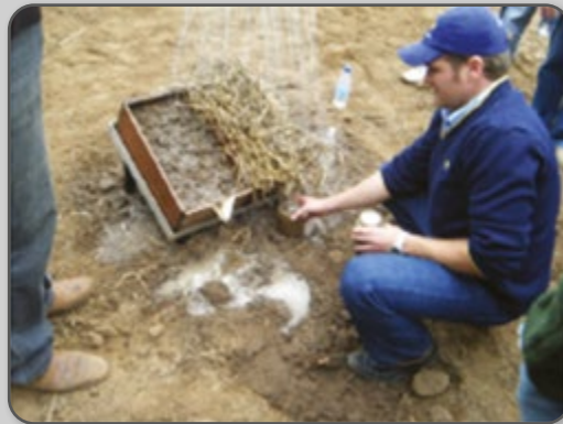
Figura 40 – Teste comparativo de perdas de água e solo.
