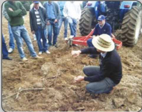
Figura 20 – Verificação da compactação do solo, pelo uso de haste de ferro e penetrógrafo.
