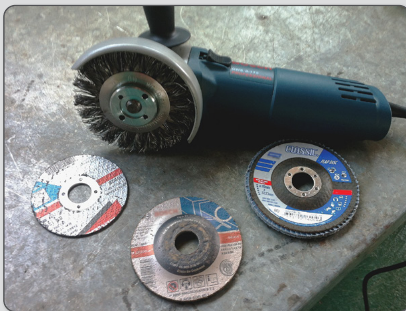
Figura 9 – Esmerilhadeira e discos abrasivos, indicados para a limpeza das peças a soldar.
