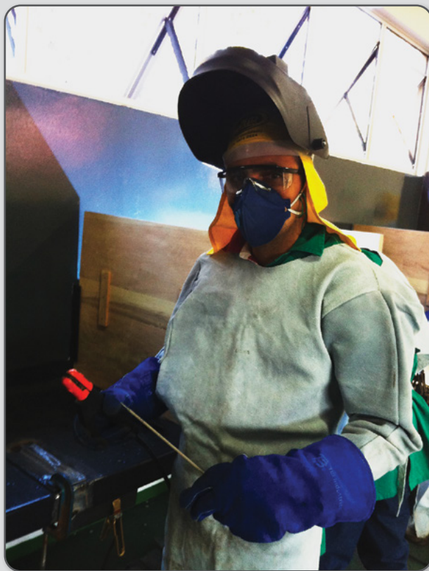
Figura 3 – Equipamentos de Proteção Individual (EPI) que devem ser utilizados durante a soldagem.
