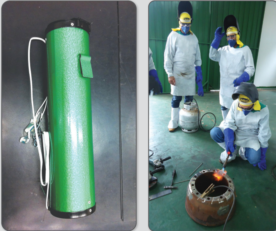
Figura 10 – Estufa portátil para pré-aquecimento dos eletrodos revestidos (esquerda) e aquecimento de peça com maçarico (direita).
