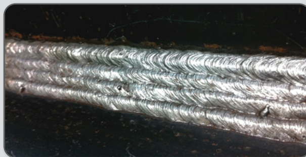
Figura 17 – Solda boa em junta em ângulo.
