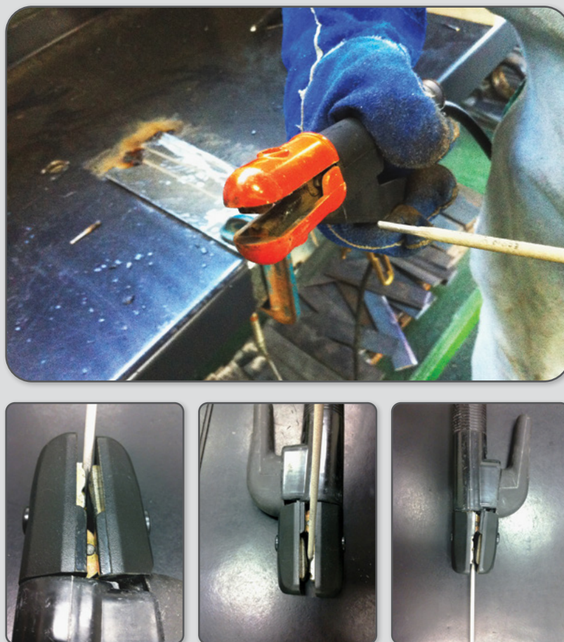
Figura 8 – Colocação do eletrodo revestido no porta-eletrodo e diferentes posições de trabalho.
