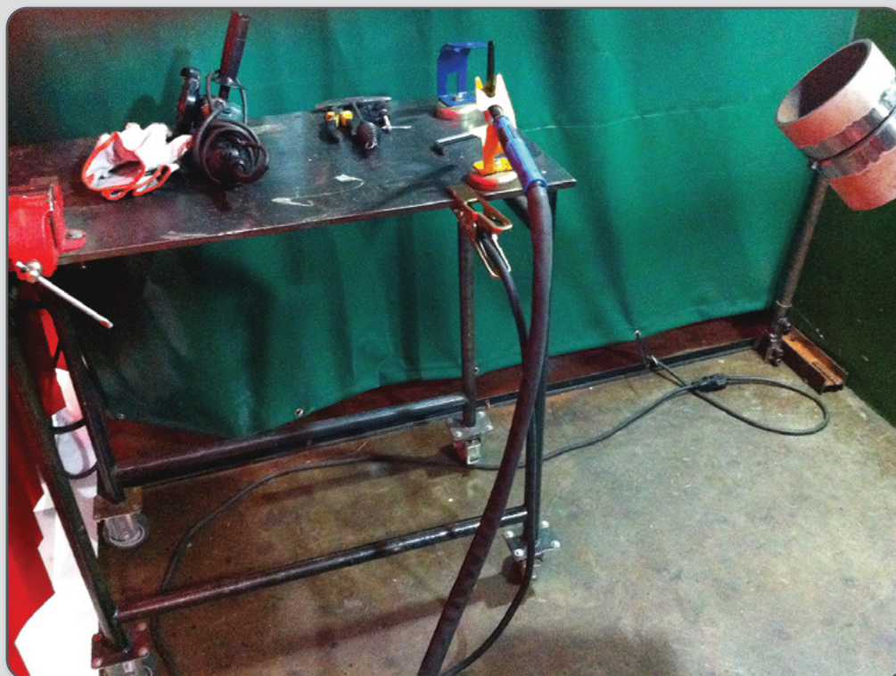
Figura 4 – Bancada com ferramentas e materiais para trabalhos de soldagem.
