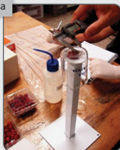
Figura 6 – Determinação da firmeza pelo método do aplanador.
