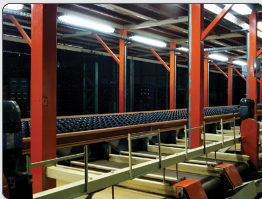
Figura 27 – Esteira de classificação eletrônica usada em tomates.
