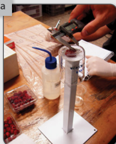
Figura 6 – Determinação da firmeza pelo método do aplanador.
