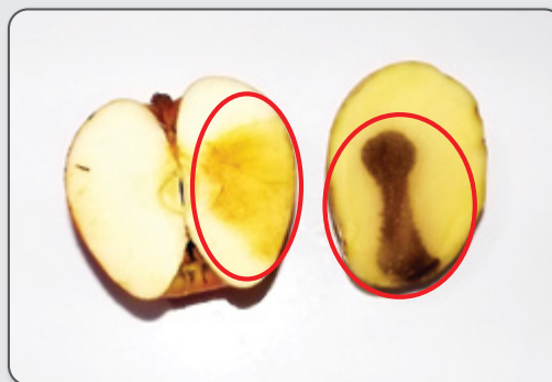
Figura 7 – Teste de iodo-amido negativo para maçã (a) e positivo para batata (b), mostrando a presença de amido.
