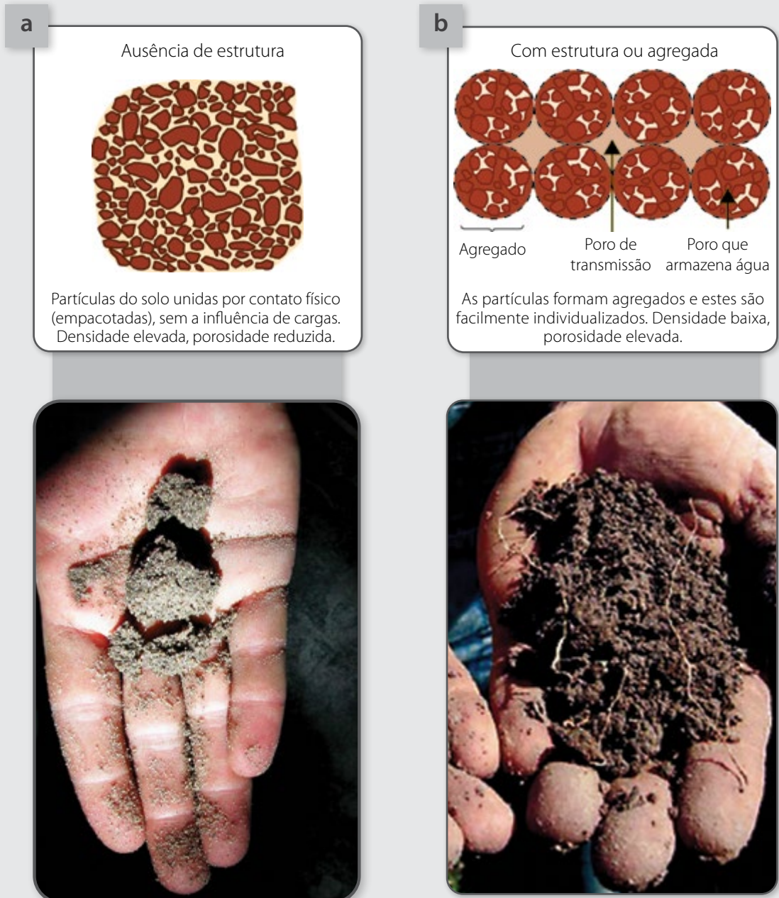
Figura 24 – Partículas do solo com ausência de estrutura (A) e com estrutura ou agregadas (B).
