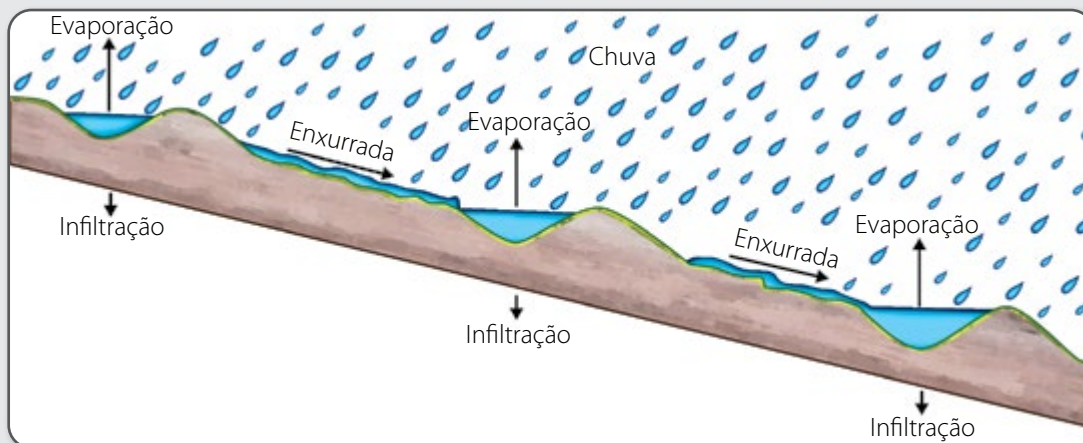
Figura 61 – Representação esquemática de uma área terraceada mostrando o parcelamento da rampa e a retenção das águas da enxurrada.
