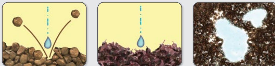
Figura 52 – Com ausência de cobertura, as gotas de chuva podem salpicar as partículas do solo até 60 cm de altura (a). A cobertura de resíduos amortece a queda das gotas de chuva e reduz ou elimina o salpicamento erosivo (b). Pequenos diques naturais são formados e causam o represamento do escoamento superficial (c). O sedimento é depositado nestas pequenas poças de água e permanece no campo.
