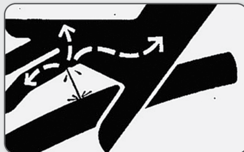
Figura 4 – Risco da pressão de fluidos hidráulicos.
