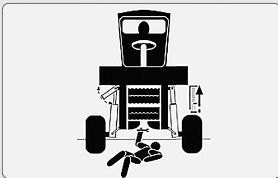
Figura 3 – Uso de travas de segurança da máquina.
