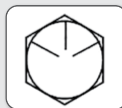
Figura 66 – Parafuso SAE J429 grau 5.2.
