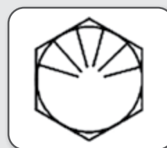
Figura 68 – Parafuso SAE J429 grau 8.2.
