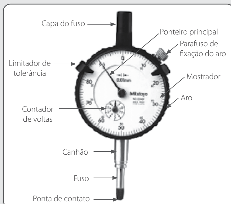
Figura 34 – Relógio comparador (ou comparador centesimal).
