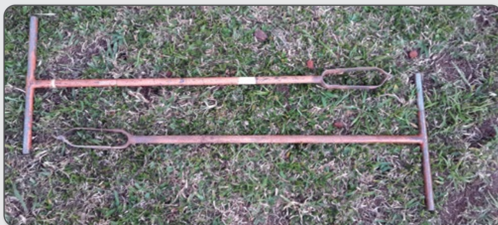
Figura 27 – Trado holandês para coleta de solo atingindo até 1 m de profundidade.
