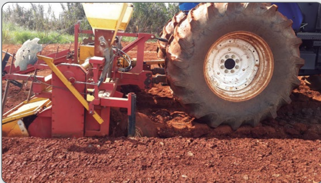
Figura 4 – Incorporação de fertilizante orgânico sólido (dejeito de bovinos) em área de sistema de preparo convencional do solo para plantio de hortaliças, utilizando enxada rotativa.
