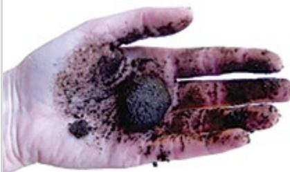
O comportamento das bolas e das fitas formadas pelos solos define a textura de campo. Não determine a textura do solo apenas pelo comprimento da fita.
