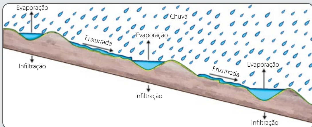
Figura 57 – Representação esquemática de uma área terraceada mostrando o parcelamento da rampa e a retenção das águas da enxurrada.
