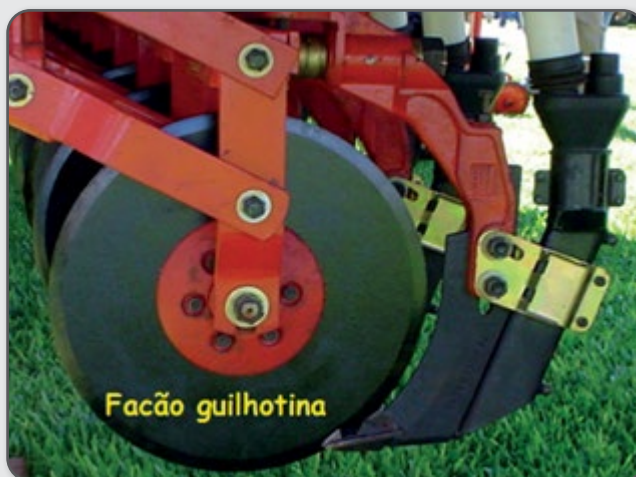
Figura 10 – Conjunto de disco liso com facão, tipo guilhotina.
