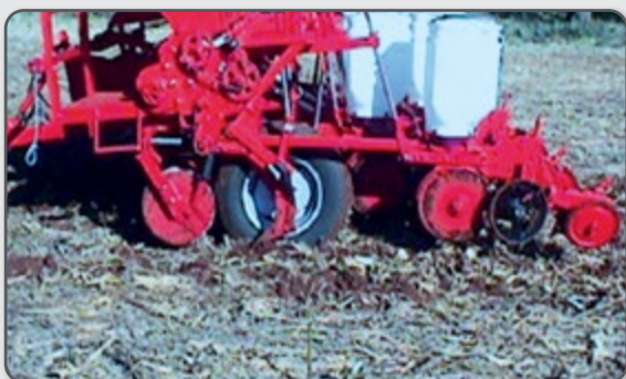
Figura 11 – Sistema com disco de corte, facão para deposição de adubo e disco duplo para deposição de sementes.
