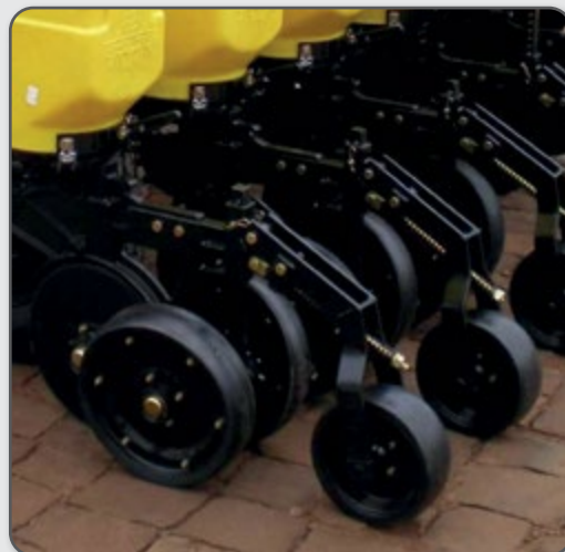
Figura 12 – Disco duplo para deposição de sementes, limitador de profundidade e compactador.
