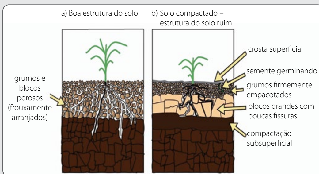
Figura 60 – Plantas crescendo em: (a) solo com estrutura adequada para o cultivo; e (b) solo com os três tipos de compactação.
