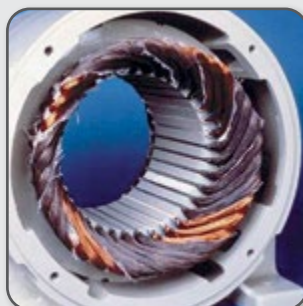
b) Motor trifásico queimado.
