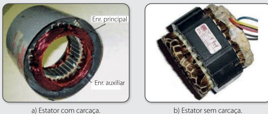
Figura 5 – Estatores de motores monofásicos de fase auxiliar.
