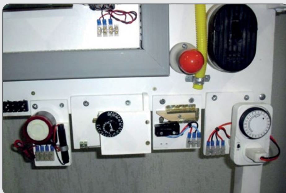
Figura 101 – Dispositivos diversos de acionamento de motores.
