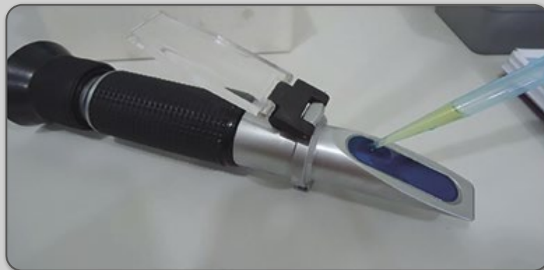
Figura 16 – Refratômetro de proteínas séricas e leitura de uma amostra de soro de bezerro com 48 horas de vida.
