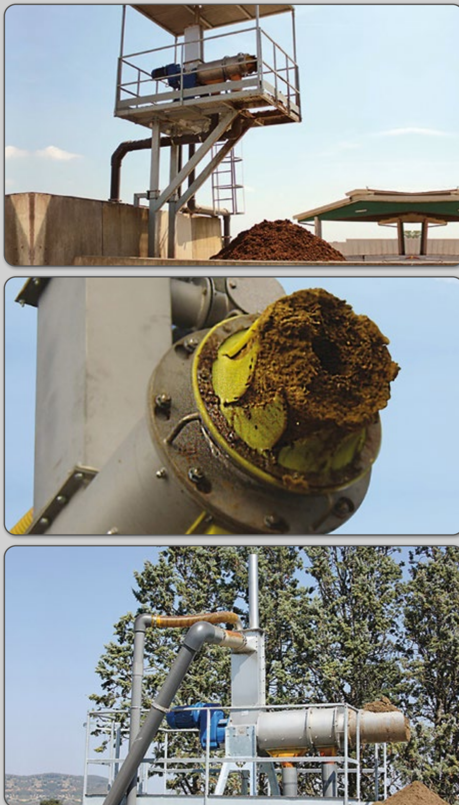
Figura 62 – Detalhes do funcionamento de prensas de roscas separadoras.
