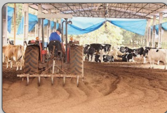
Figura 56 – Equipamentos para revolver a cama.
