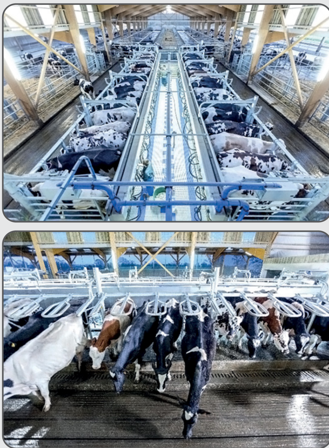
Figura 12 – Sala de ordenha com contenções paralelas.
