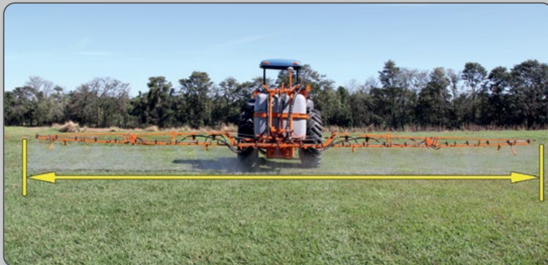
Figura 35 – Representação da largura de trabalho de um pulverizador em operação.
