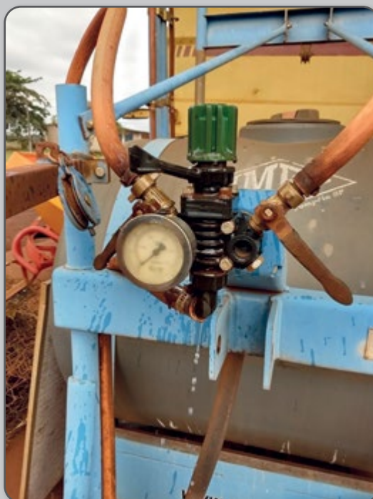
Figura 57 – Comando de pulverização com vazamento.
