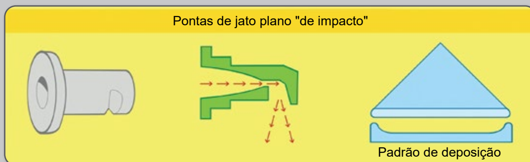
Figura 44 – Funcionamento e padrão de deposição de pontas de jatos planos de impacto.
