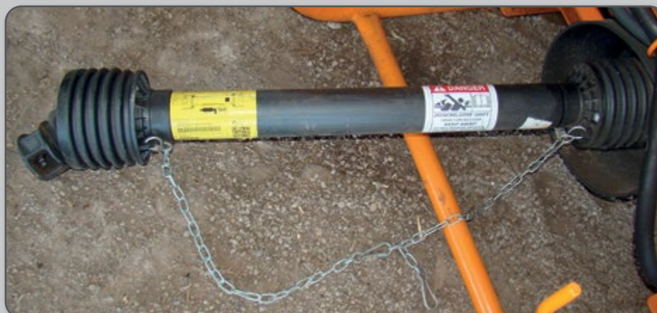
Figura 27 – Eixo cardan devidamente protegido.
