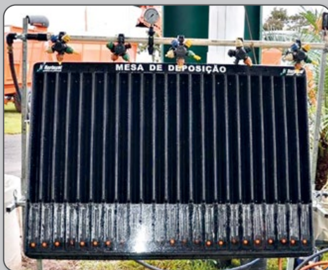
Figura 68 – Mesa de canaletas usada para avaliar a uniformidade da distribuição da barra.
