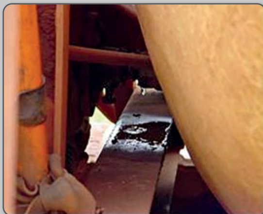
Figura 59 – Vazamentos no eixo do agitador mecânico e no filtro de linha.
