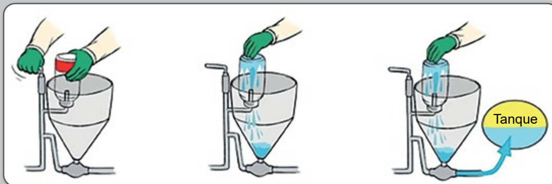
Figura 22 – Lavagem de embalagens vazias sob pressão, utilizando o incorporador de produtos.
