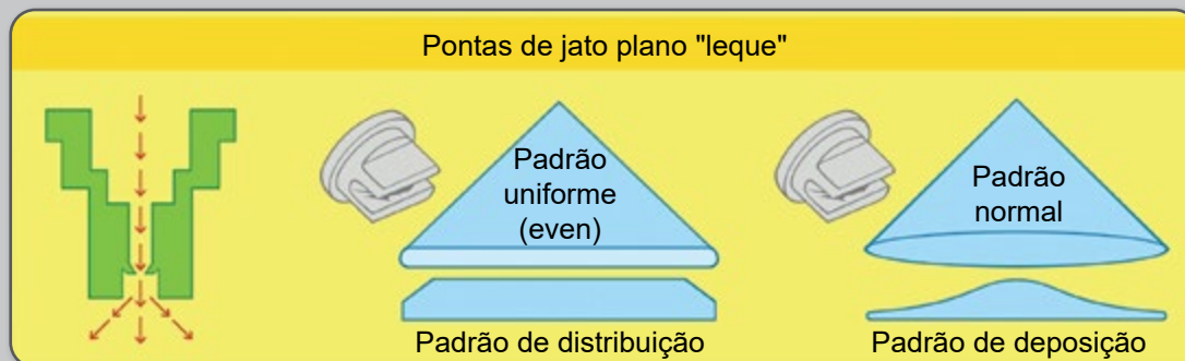
Figura 41 – Pontas de jatos planos de padrão uniforme e de padrão normal.
