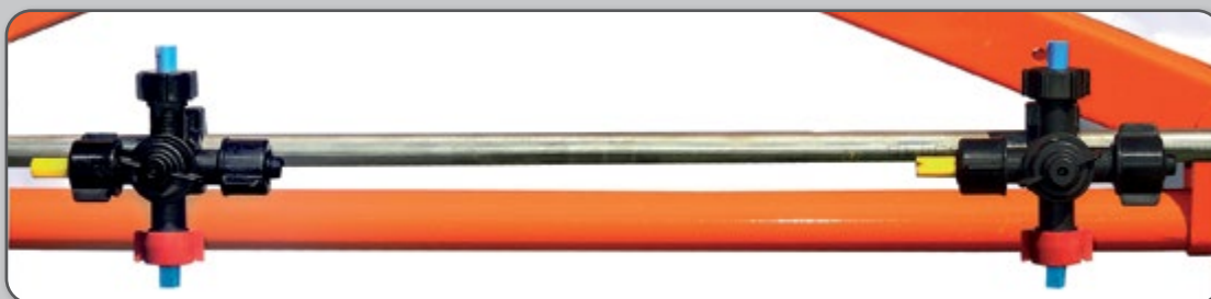
Figura 32 – Tubulação rígida portando bicos múltiplos quadrijet.
