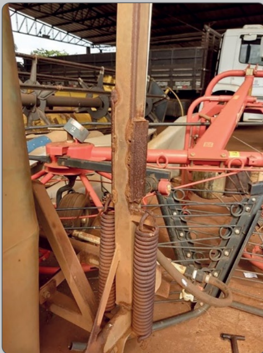
Figura 55 – Barra de pulverização com reparo estrutural visível.
