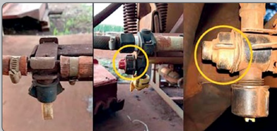
Figura 62 – Porta bico sem antigotejador (esquerda), com antigotejador em destaque modelo 1 (centro) e com antigotejador em destaque modelo 2 (direita).
