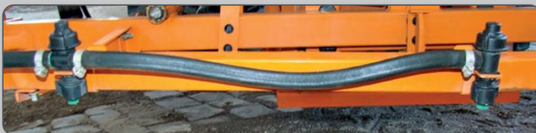
Figura 33 – Tubulação flexível interligando porta-bicos simples com antigotejador.
