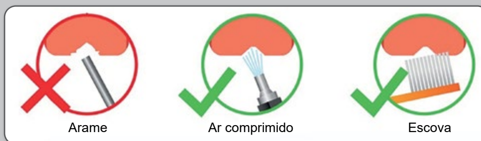
Figura 51 – Indicação dos meios ou instrumentos que devem ser evitados ou utilizados para uma correta limpeza de pontas de pulverização.
