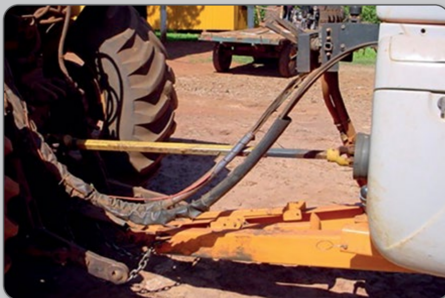
Figura 65 – Tomada de potência do pulverizador sem proteção.
