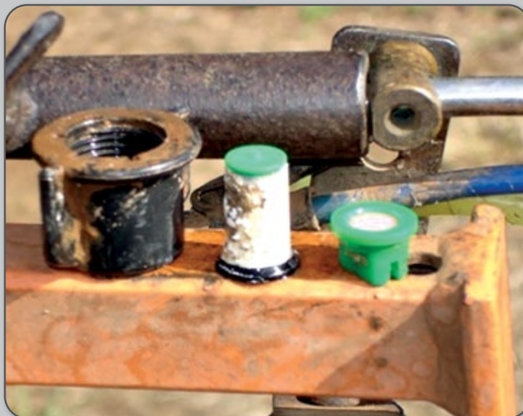
Figura 58 – Filtro de bico obstruído.
