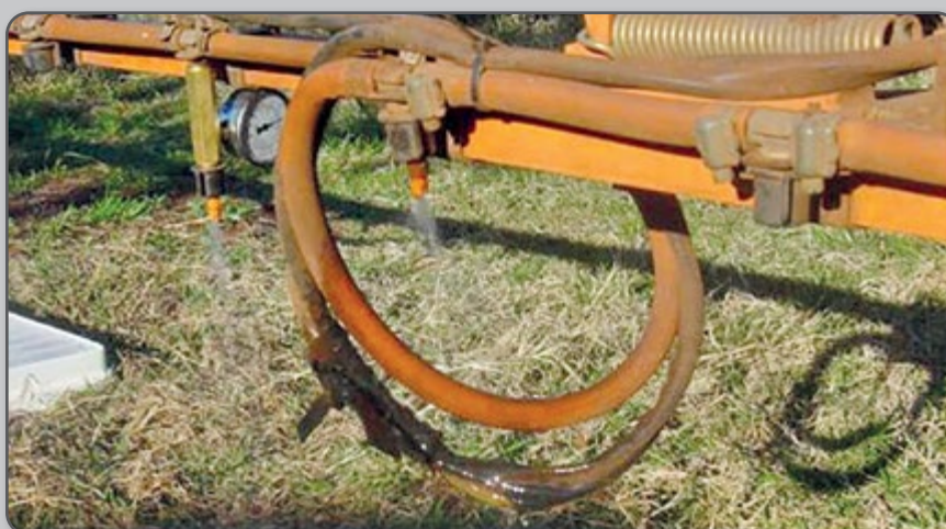
Figura 61 – Mangueira localizada entre a projeção do jato e o alvo.
