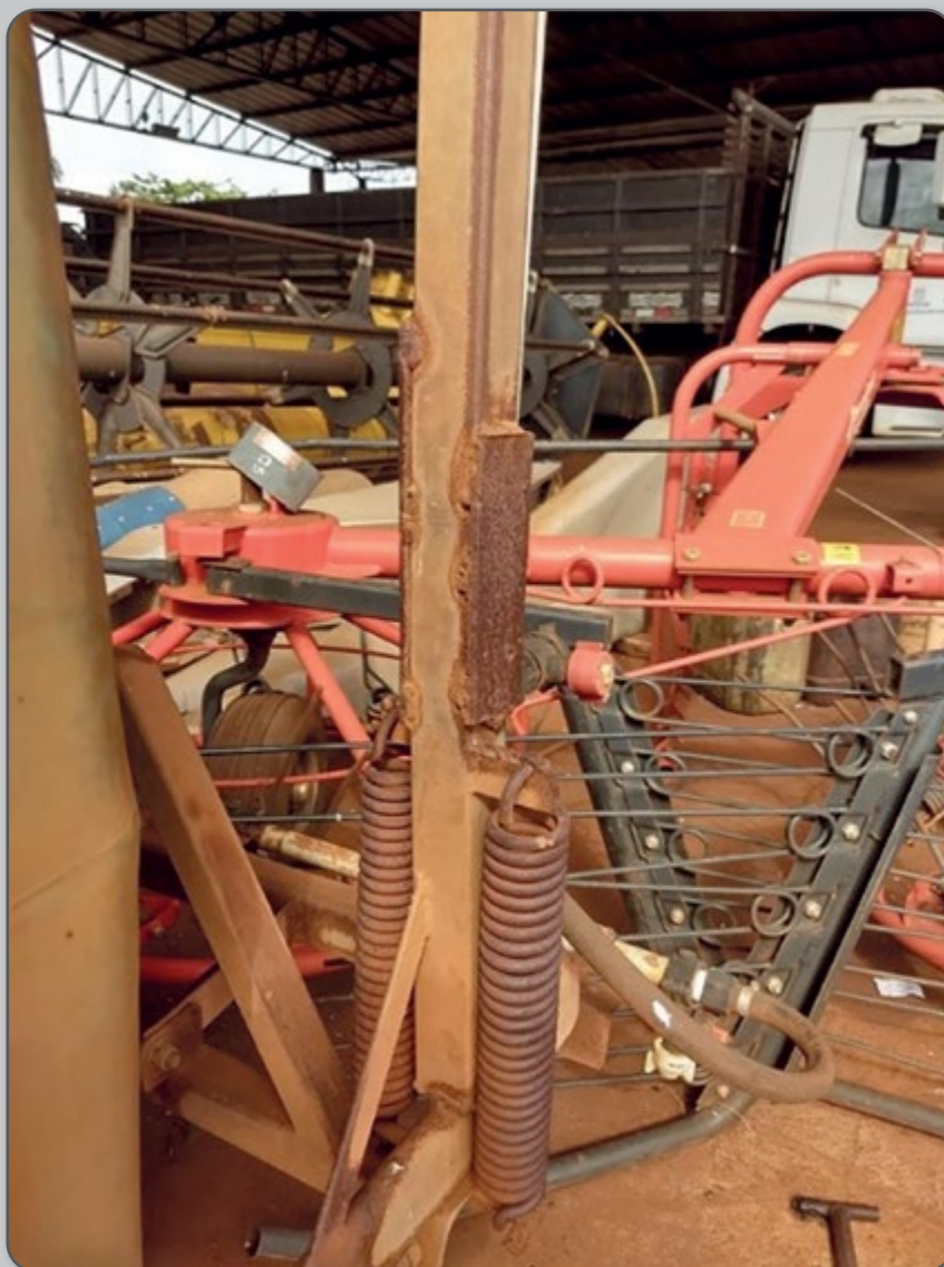
Figura 55 – Barra de pulverização com reparo estrutural visível.
