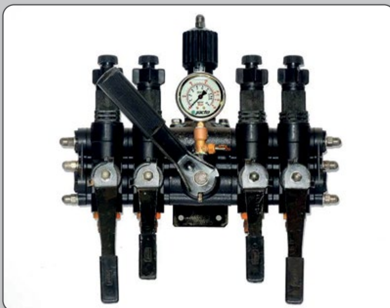
Figura 28 – Comando manual de pulverizador (quatro seções).
