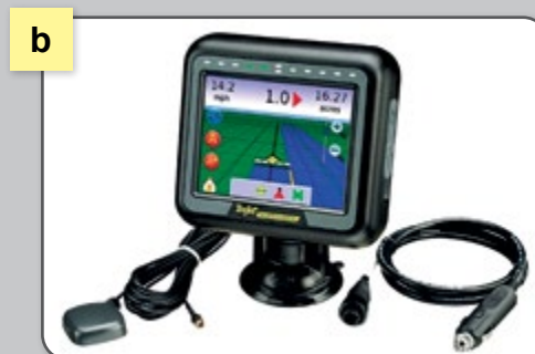
Figura 30 – Comandos eletrônicos: (a) comando para cinco seções de barra e (b) tela e sensores de um controlador eletrônico de pulverização.
