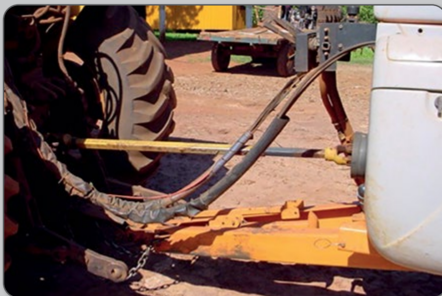
Figura 65 – Tomada de potência do pulverizador sem proteção.
