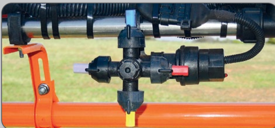
Figura 76 – Pulverizador com sistema de abertura e fechamento automático de bicos de forma individualizada.
