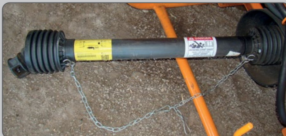
Figura 27 – Eixo cardan devidamente protegido.
