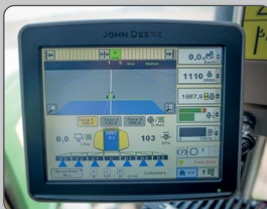
Figura 71 – Exemplo de controlador indicando a taxa de aplicação e a pressão de pulverização.
