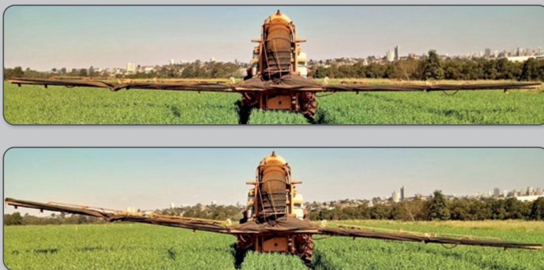
Figura 39 – Barra com paralelismo (superior) e com falta de paralelismo (inferior). Nota-se a extremidade direita tocando as plantas e a extremidade esquerda demasiadamente alta, ocasionando risco de deriva.
