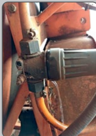
Figura 59 – Vazamentos no eixo do agitador mecânico e no filtro de linha.
