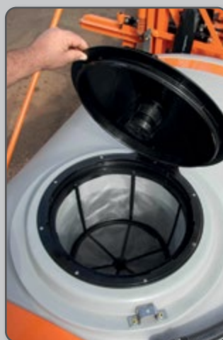
Figura 19 – Tampa superior do tanque com coador.
