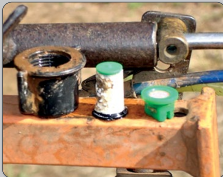
Figura 58 – Filtro de bico obstruído.
