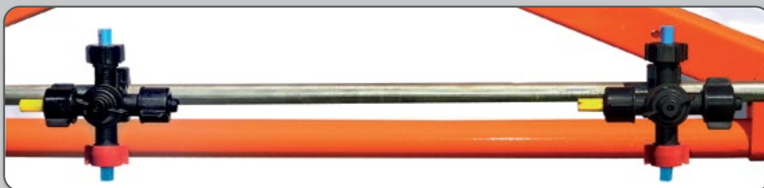
Figura 32 – Tubulação rígida portando bicos múltiplos quadrijet.
