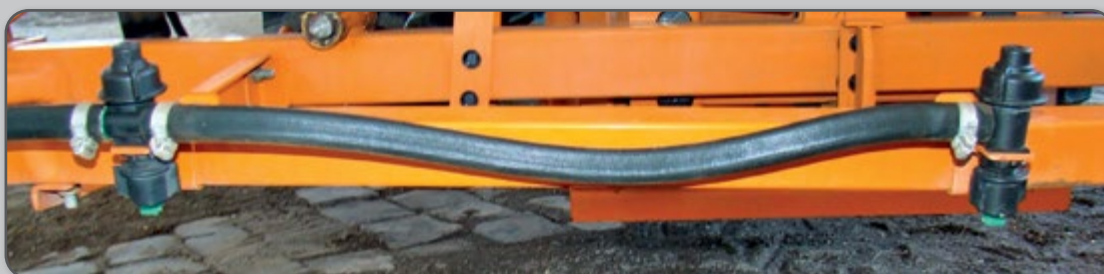
Figura 33 – Tubulação flexível interligando porta-bicos simples com antigotejador.
