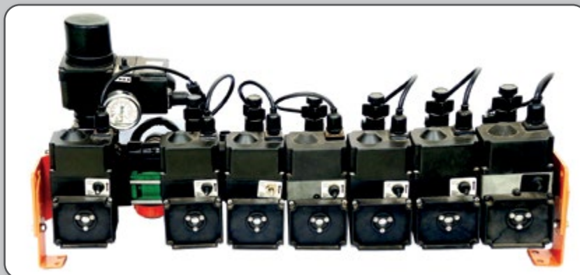
Figura 29 – Comando elétrico de pulverizador (seis seções).
