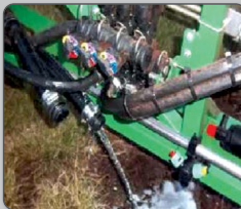
Figura 54 – Ilustração da limpeza dos mangotes de retorno ou corte de secção da barra
