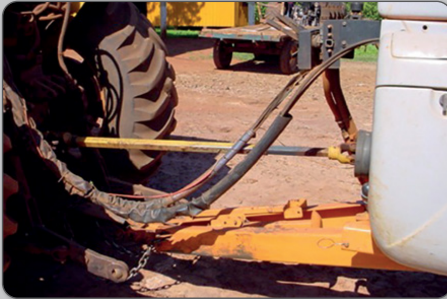
Figura 65 – Tomada de potência do pulverizador sem proteção.
