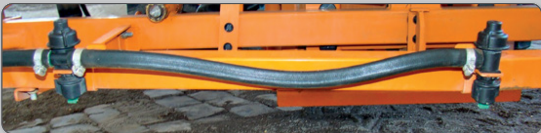
Figura 33 – Tubulação flexível interligando porta-bicos simples com antigotejador.
