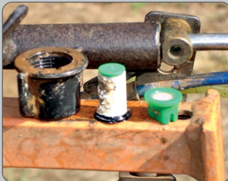
Figura 58 – Filtro de bico obstruído.
