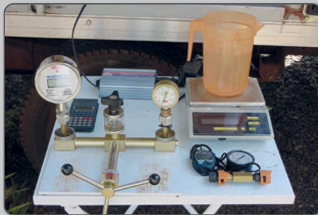
Figura 66 – Bomba hidráulica para comparação de diferenças entre manômetros.
