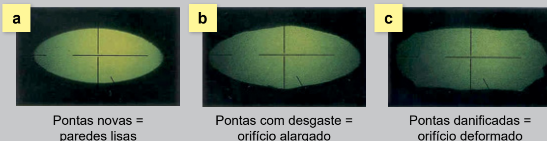
Figura 49 – Ilustração de diferentes níveis de desgaste em pontas de pulverização.
