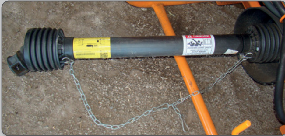
Figura 27 – Eixo cardan devidamente protegido.
