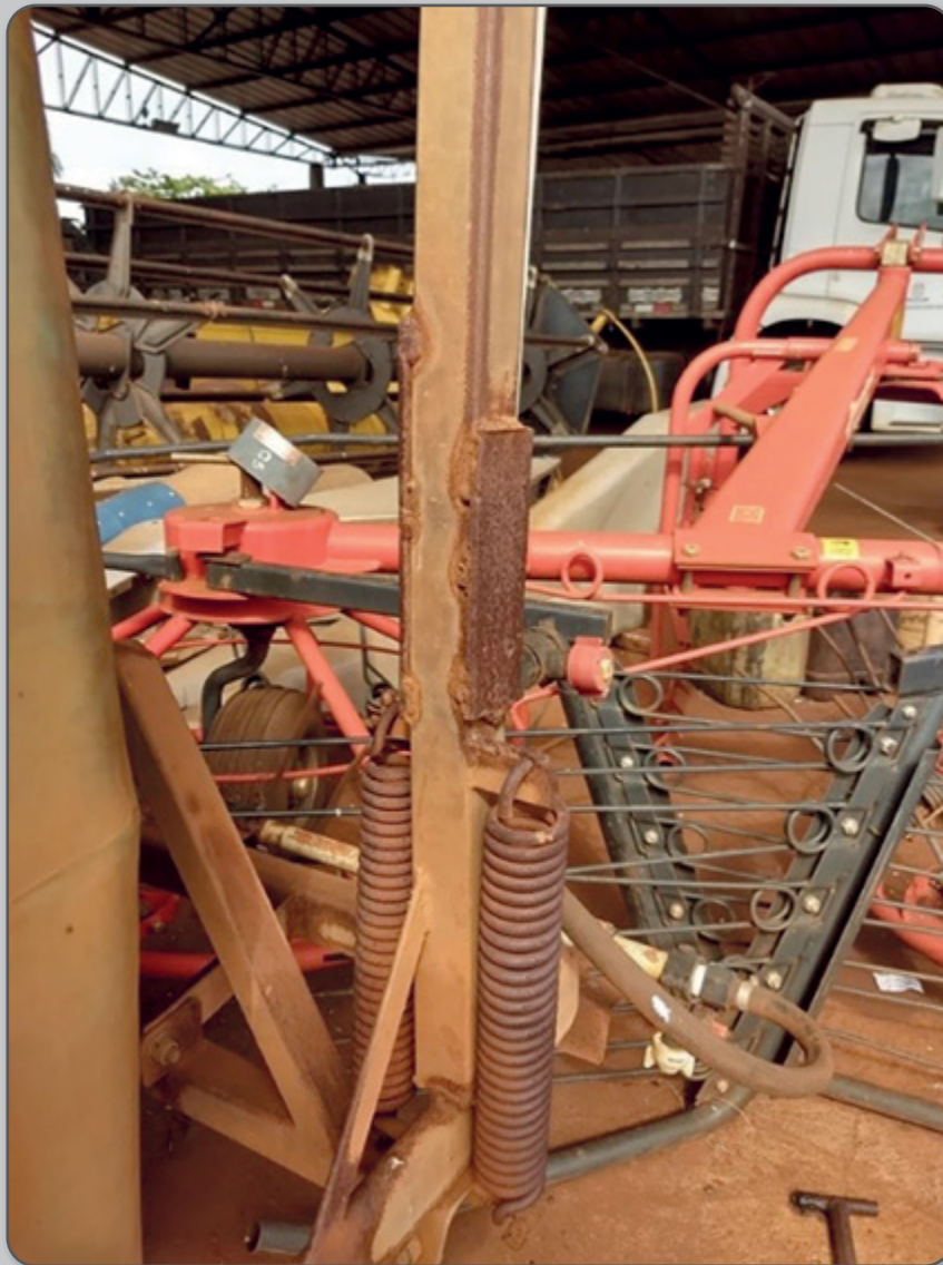
Figura 55 – Barra de pulverização com reparo estrutural visível.
