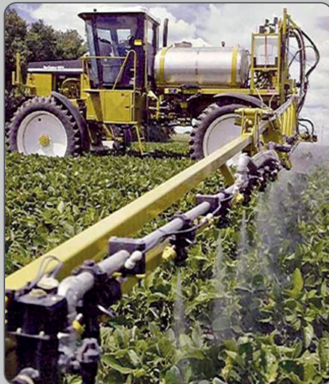
Figura 80 – Sistema de injeção direta nas barras.
