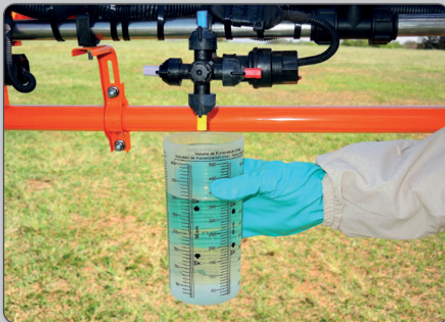
Figura 53 – Coleta de água em cada ponta utilizando coletor graduado.
