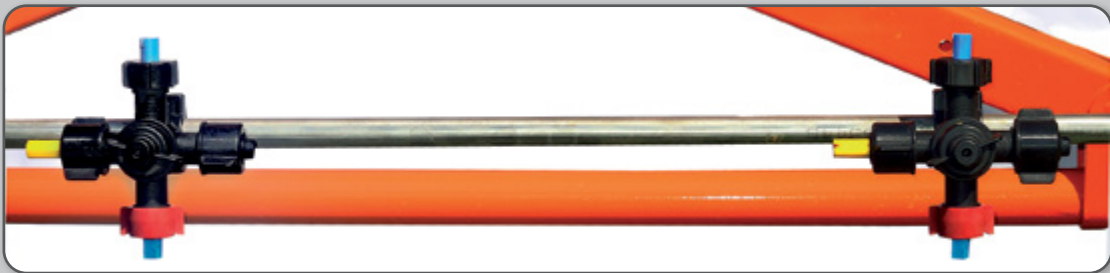
Figura 32 – Tubulação rígida portando bicos múltiplos quadrijet.
