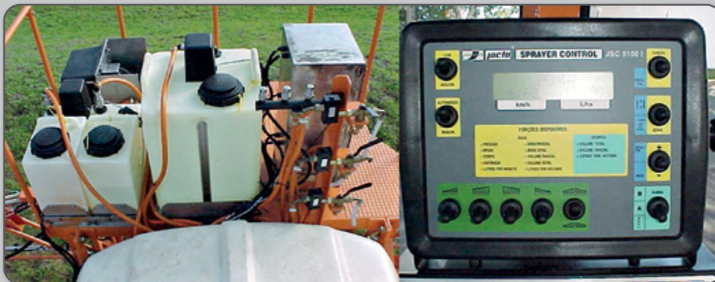
Figura 79 – Sistema de injeção direta central.
