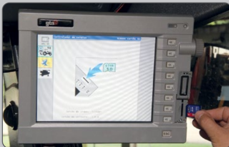
Figura 48 – Carregamento ou extração de dados no monitor via cartão de memória.
