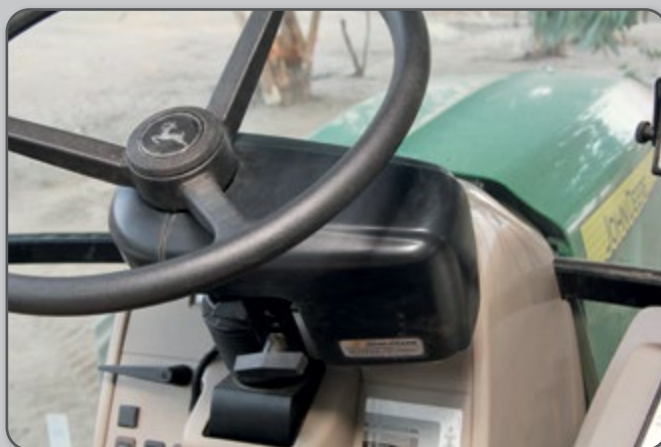
Figura 31 – Atuador elétrico instalado na barra de direção.
