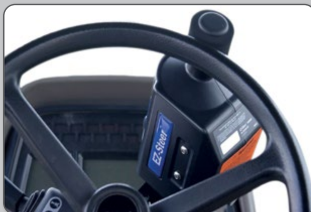
Figura 34 – Atuador elétrico de atrito instalado na direção.
