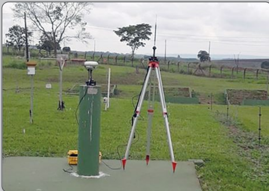
Figura 25 – Montagem correta da estação RTK.
