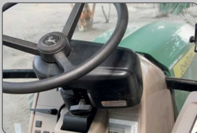
Figura 31 – Atuador elétrico instalado na barra de direção.
