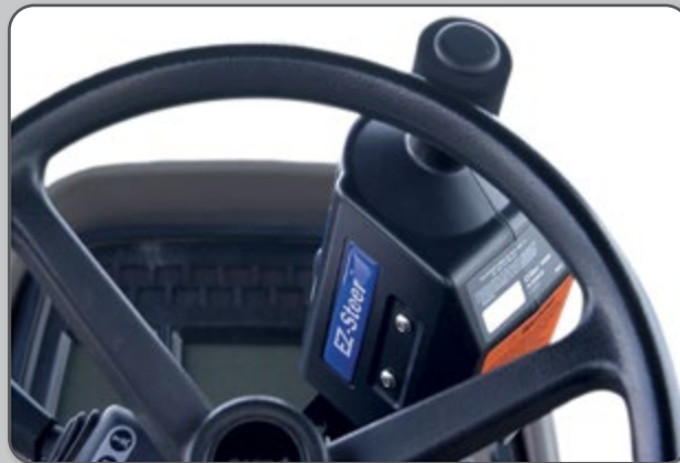
Figura 34 – Atuador elétrico de atrito instalado na direção.
