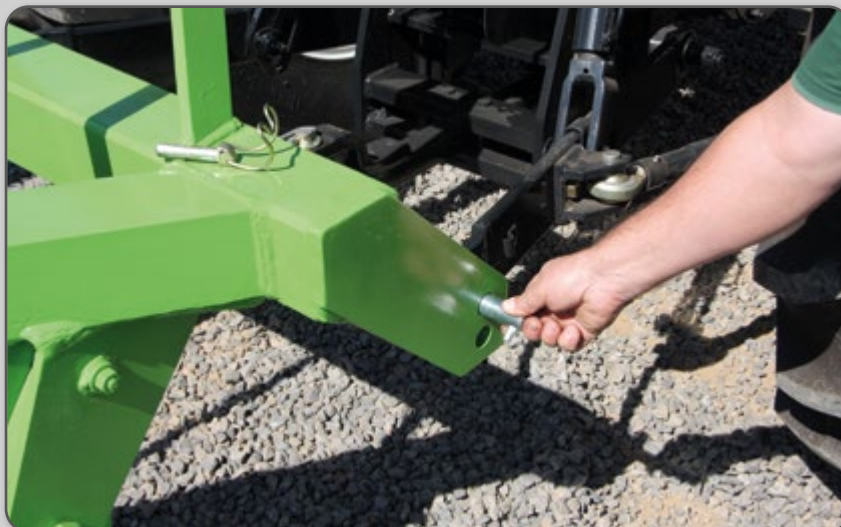
Figura 45 – Acoplamento do braço de levante inferior direito.
