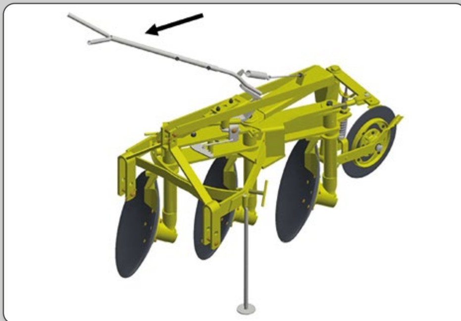
Figura 64 – Arado de disco reversível com acionamento mecânico manual.
