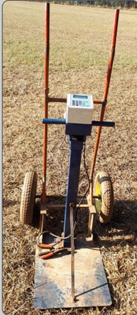
Figura 20 – Penetrógrafo com célula de carga.
