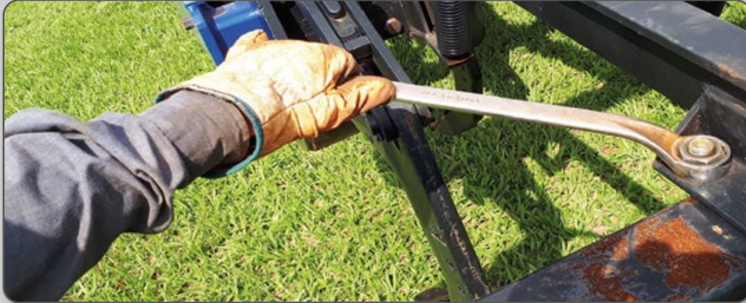
Figura 72 – Reaperto de parafusos.
