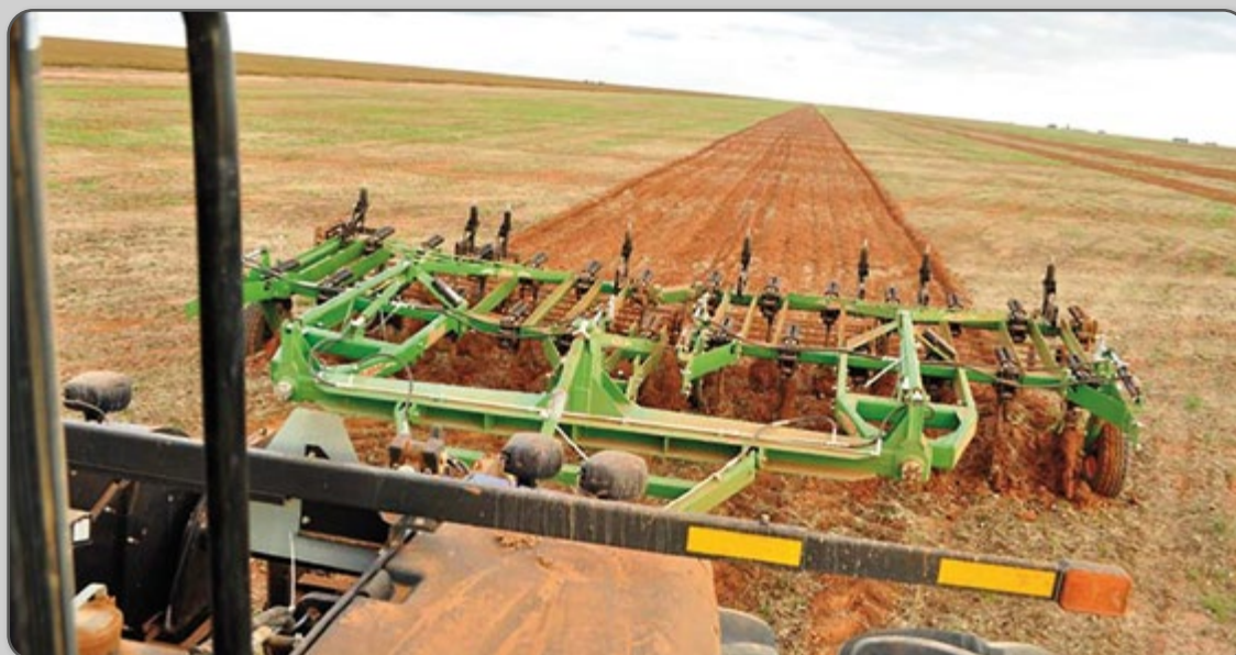
Figura 4 – Solo preparado após uma única passagem de escarificador.
