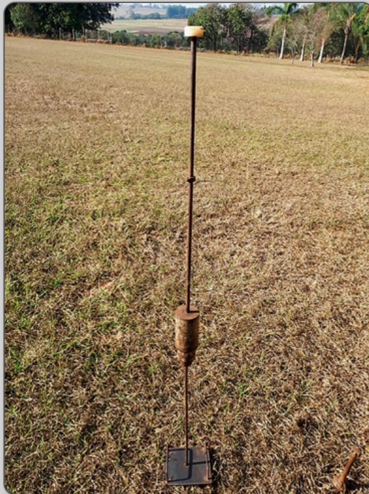
Figura 19 – Penetrômetro de impacto.
