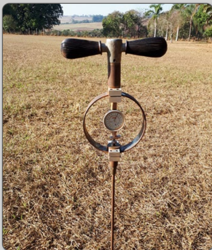
Figura 18 – Penetrômetro de mola.
