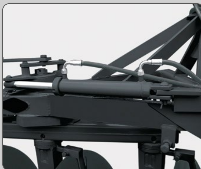
Figura 65 – Cilindro hidráulico do arado reversível com acionamento mecânico hidráulico.
