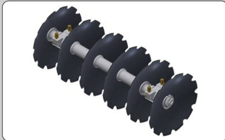
Figura 86 – Representação de uma seção de discos recortados.
