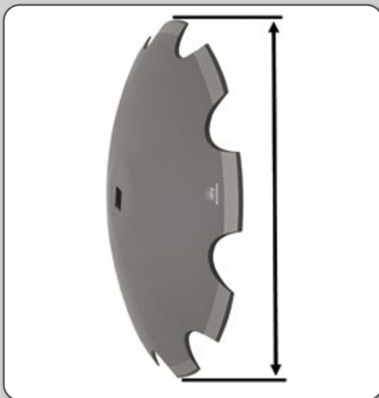
Figura 82 – Diâmetro dos discos da grade.
