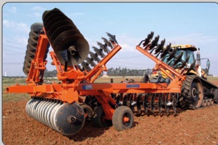
Figura 88 – Grade utilizando as rodas para transporte com as seções de disco recolhidas.
