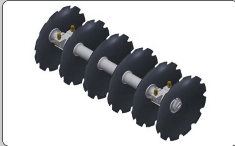
Figura 86 – Representação de uma seção de discos recortados.
