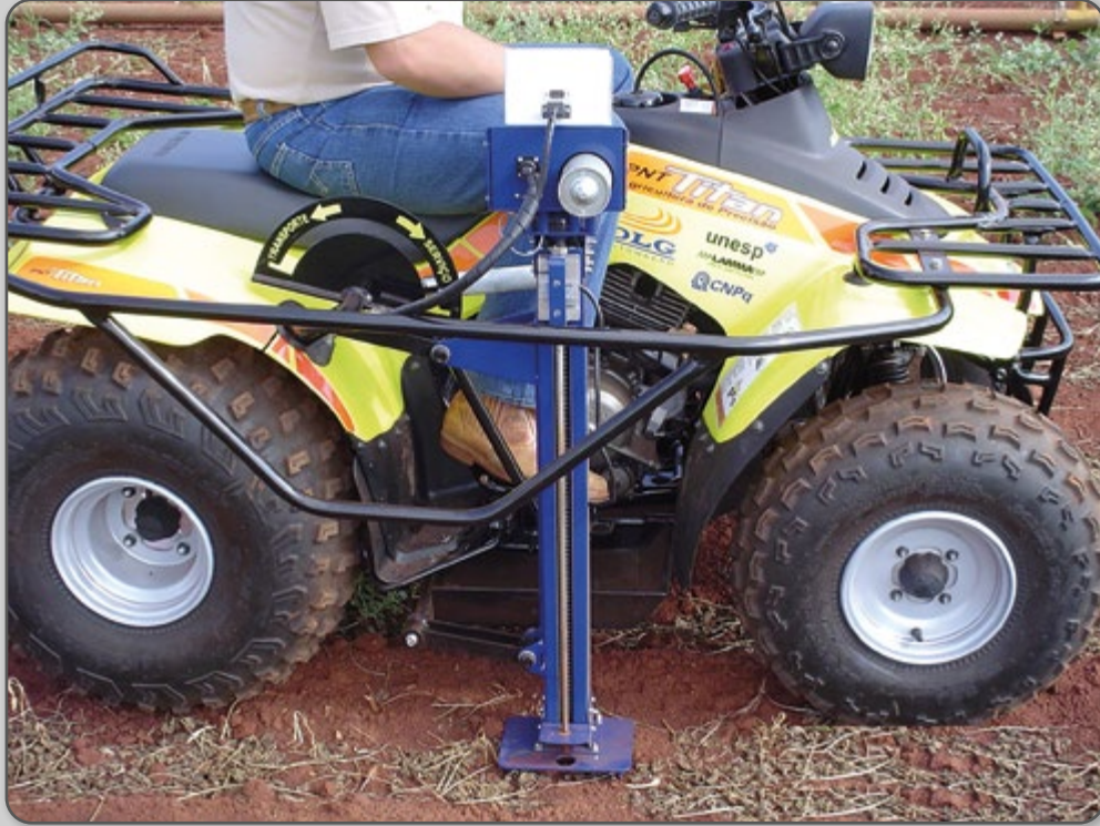
Figura 21 – Penetrógrafo acoplado a um quadriciclo.
