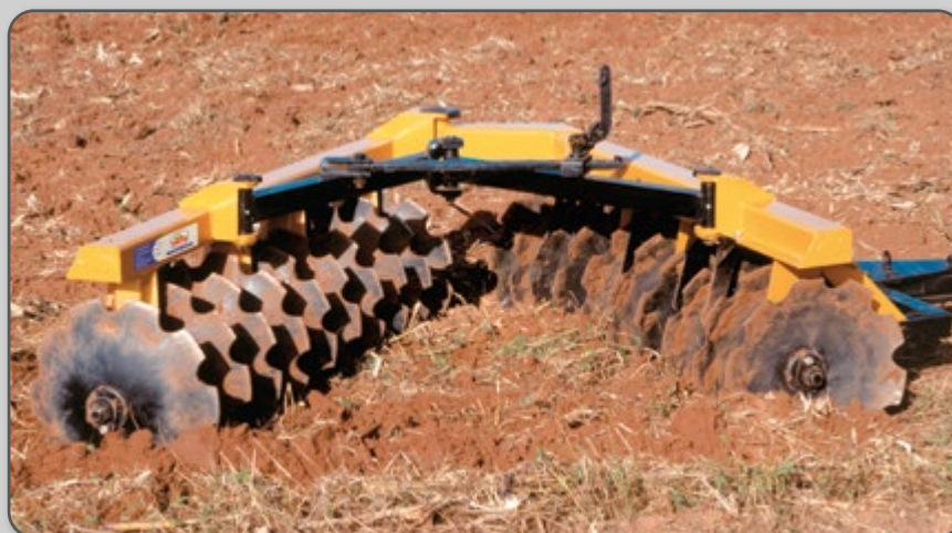
Figura 94 – Grade com sistema mecânico manual para regulagem do ângulo horizontal.
