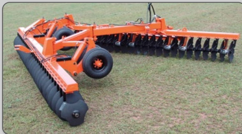
Figura 78 – Grade de discos de dupla ação (Grade deslocada ou off set ).
