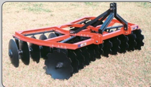
Figura 80 – Grade de discos ultraleve.
