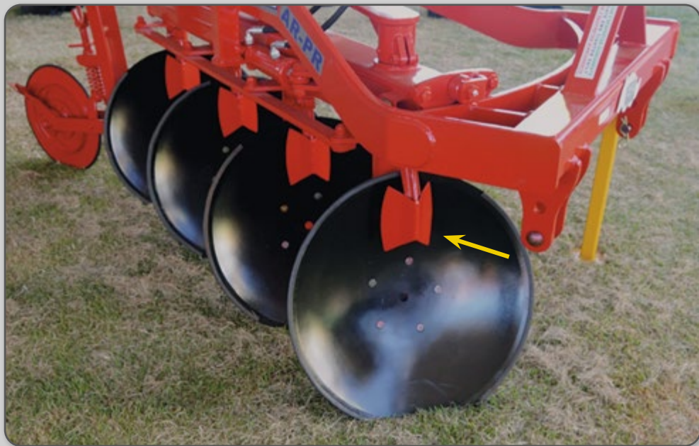
Figura 56 – Limpador do disco de arado.
