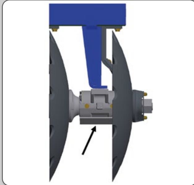
Figura 84 – Detalhe do mancal da grade entre os discos.
