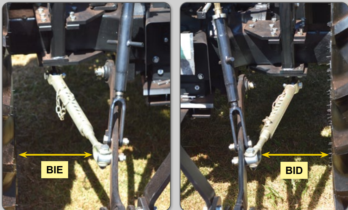
Figura 47 – Medição da distância dos braços de levante inferiores ao rodado.
