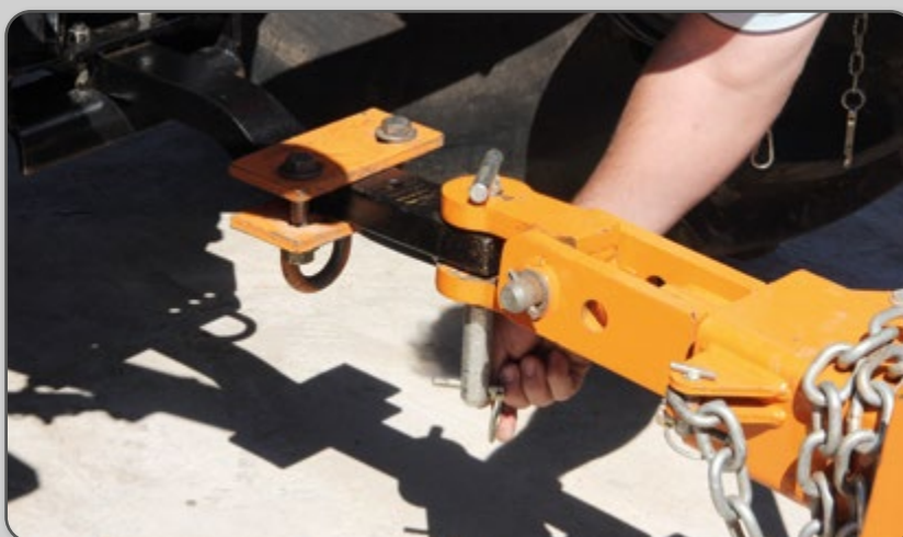
Figura 46 – Engate do cabeçalho do equipamento com a barra de tração do trator.
