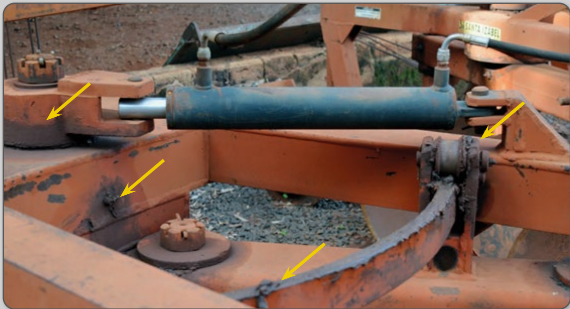
Figura 71 – Arado de disco com pontos de excesso de graxa.
