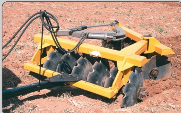
Figura 93 – Grade com cilindro hidráulico para regulação do ângulo horizontal.
