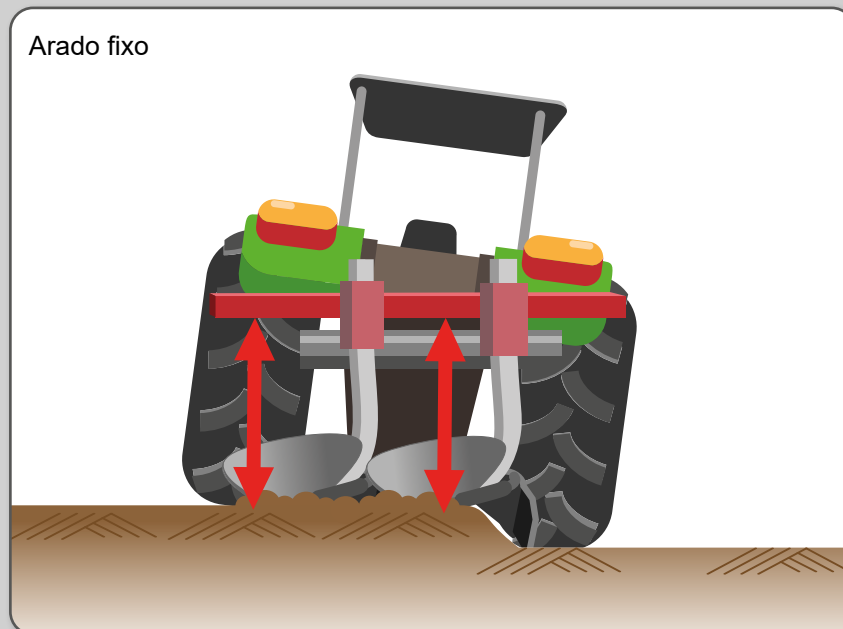
Figura 48 – Braços de levante inferiores do SH3P paralelos ao solo.
