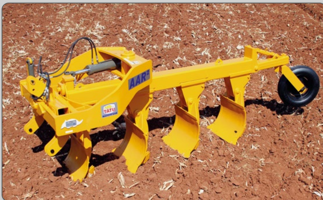
Figura 39 – Arado de aivecas retangulares reversível com roda de controle de profundidade.
