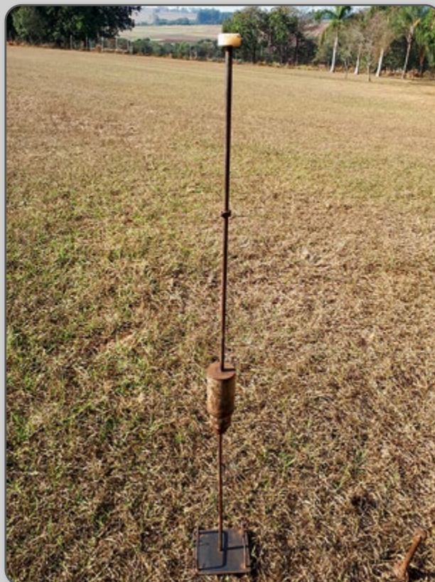
Figura 19 – Penetrômetro de impacto.
