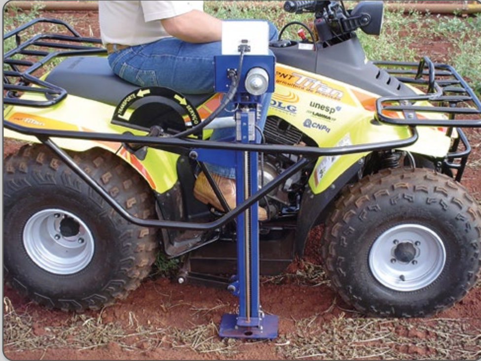
Figura 21 – Penetrógrafo acoplado a um quadriciclo.
