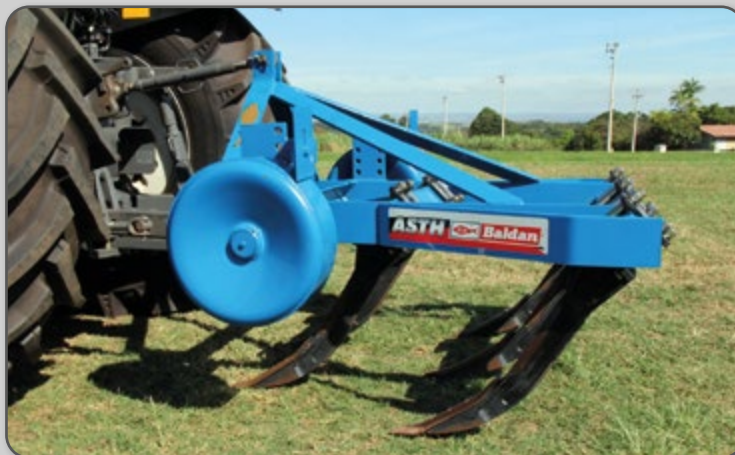
Figura 27 – Implemento montado no SH3P do trator.
