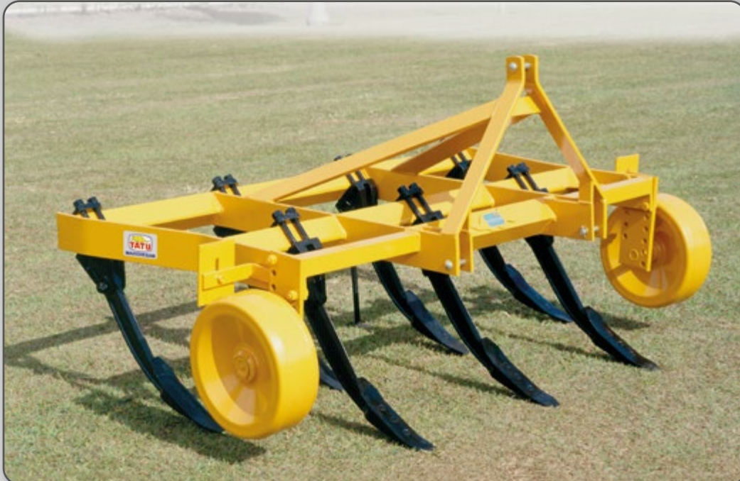
Figura 23 – Exemplo de implemento agrícola: subsolador.
