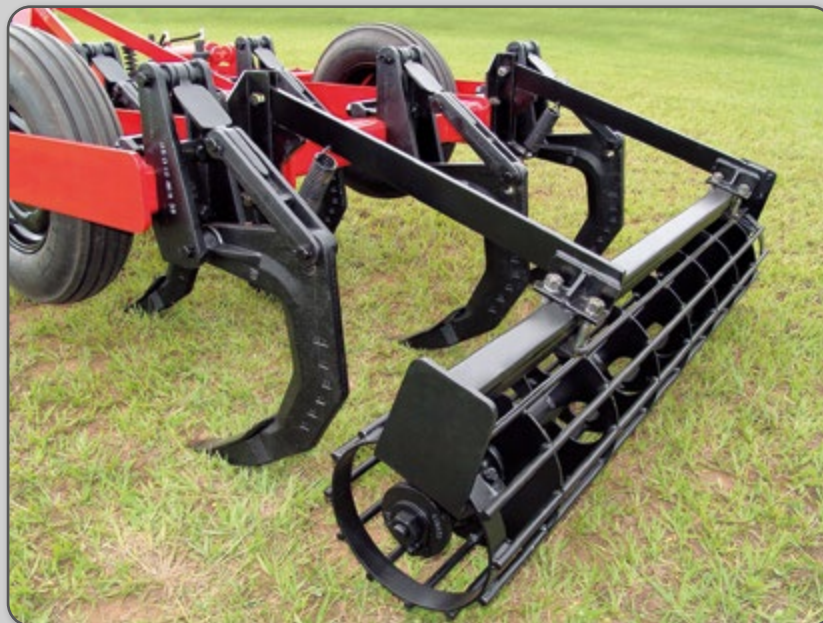
Figura 40 – Rolo destorroador/nivelador do escarificador.
