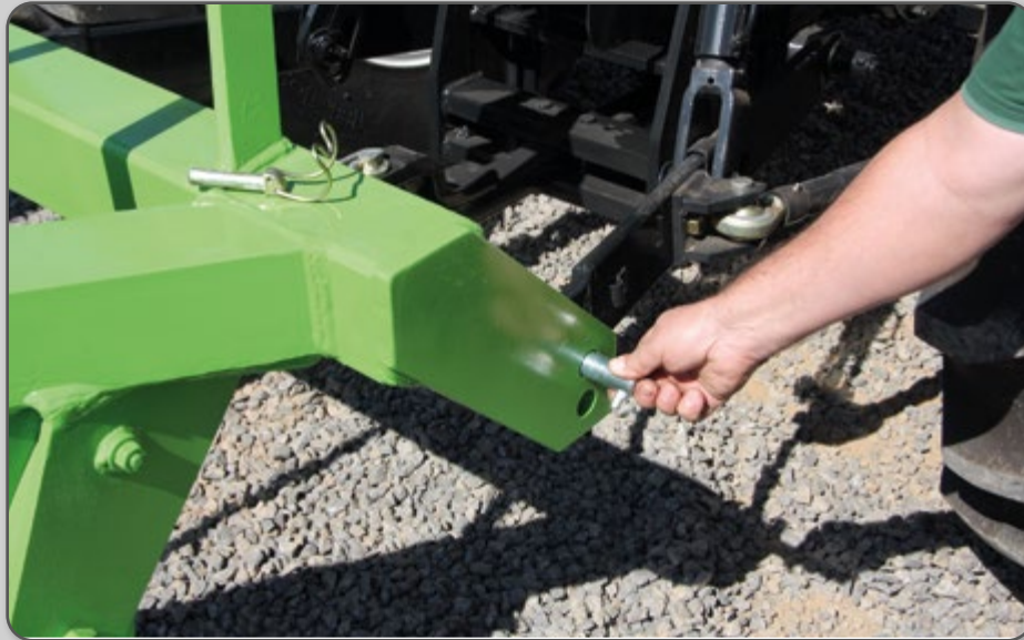
Figura 44 – Acoplamento do braço de levante inferior direito.
