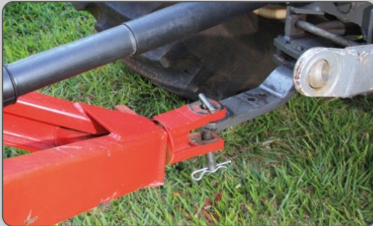
Figura 26 – Máquina acoplada à barra de tração do trator.
