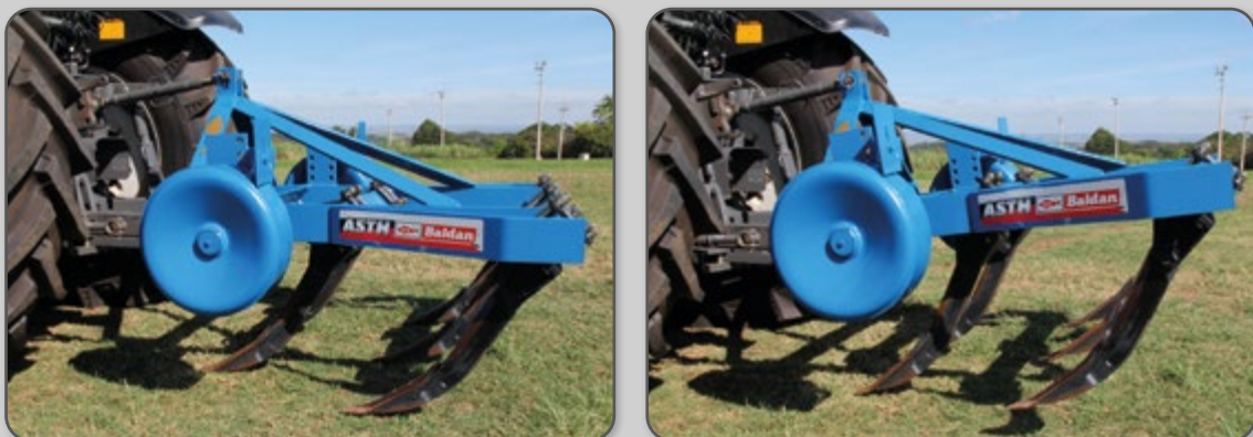
Figura 48 – Nivelamento longitudinal pelo terceiro ponto do trator do subsolador montado.
