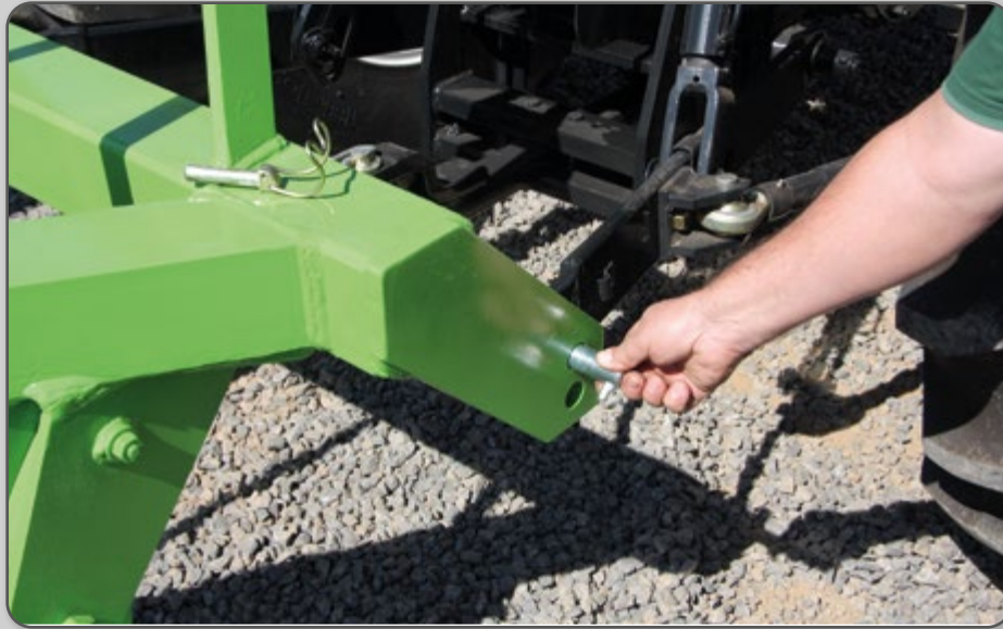
Figura 44 – Acoplamento do braço de levante inferior direito.
