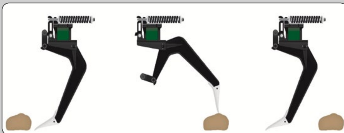
Figura 54 – Sistema de desarme automático da haste do escarificador.
