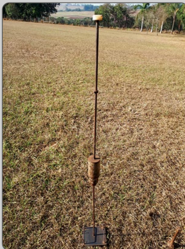
Figura 19 – Penetrômetro de impacto.
