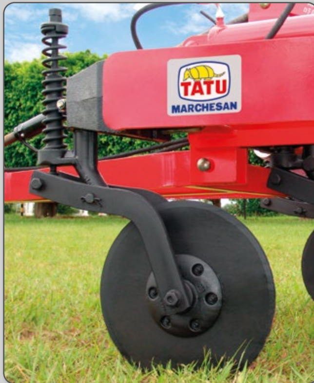
Figura 39 – Disco de corte do escarificador com mola para regulagem da pressão.
