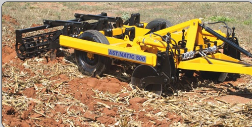
Figura 28 – Escarificador preparando o solo.
