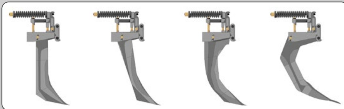
Figura 33 – Tipos de hastes: reta, inclinada, curva e parabólica.
