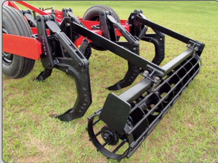
Figura 40 – Rolo destorroador/nivelador do escarificador.
