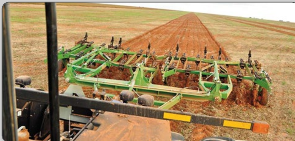
Figura 4 – Solo preparado após uma única passagem de escarificador.
