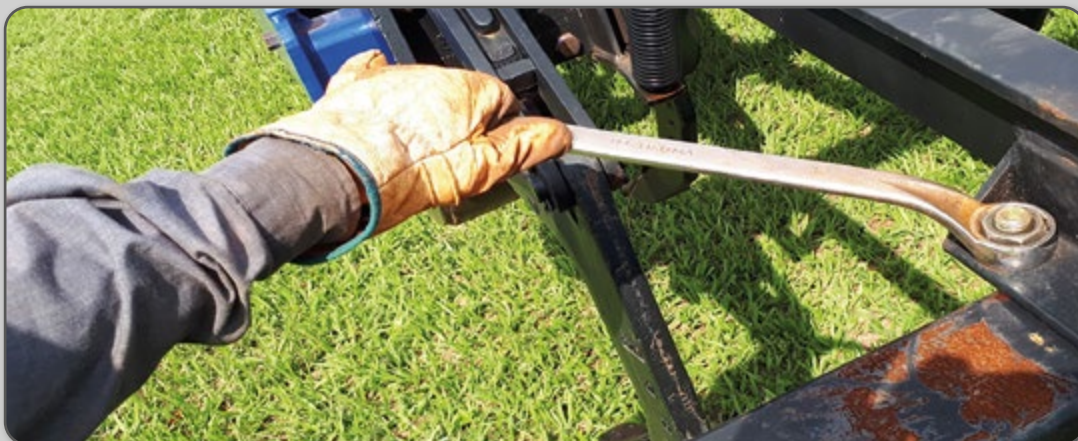
Figura 63 – Reaperto de parafusos.
