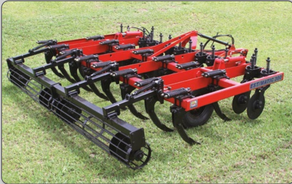
Figura 24 – Exemplo de máquina agrícola: escarificador com discos e rolo destorroador.
