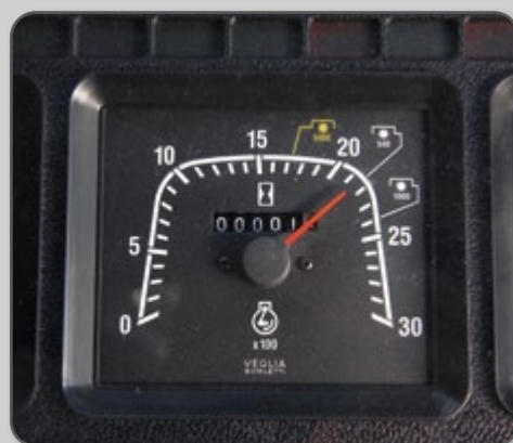
Figura 48 – Painel do trator com diferentes possibilidades de rotação da TDP.
