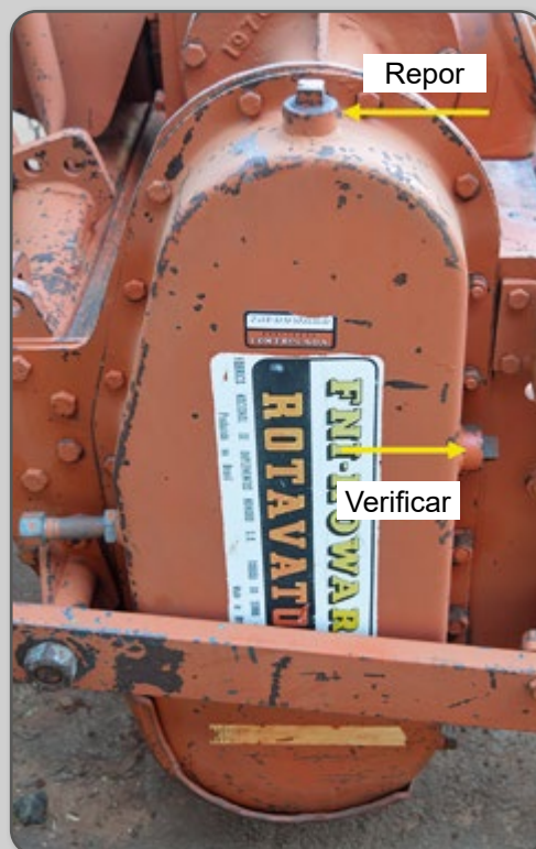
Figura 57 – Verificação e reposição do nível de óleo.
