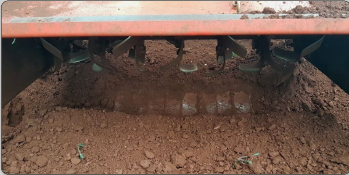
Figura 31 – Espelhamento do solo causado pelo uso de lâminas em L.
