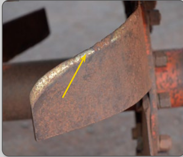
Figura 58 – Verificação do desgaste das lâminas.
