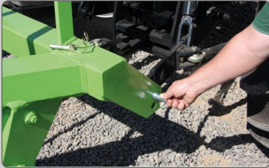
Figura 43 – Acoplamento do braço de levante inferior direito.
