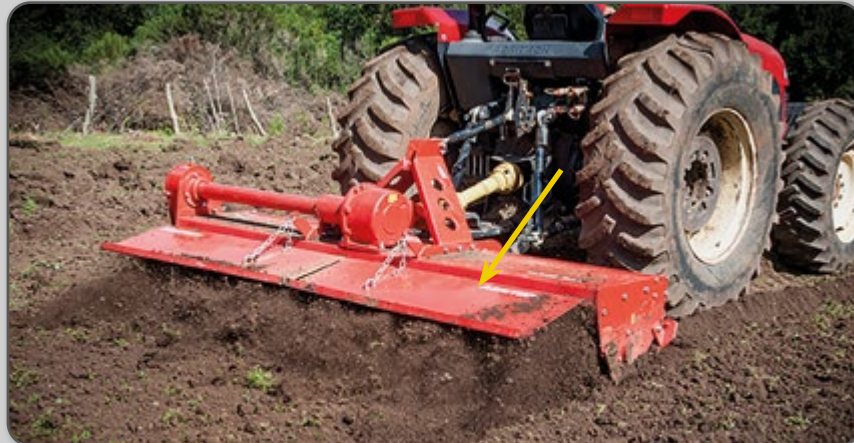
Figura 36 – Placa de impacto da enxada rotativa.
