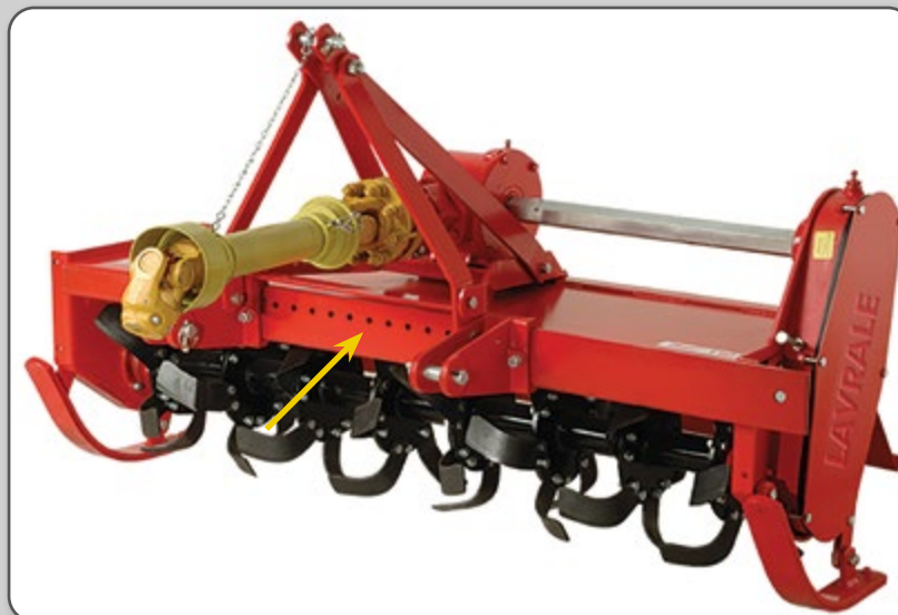
Figura 50 – Enxada rotativa que possibilita deslocamento lateral.
