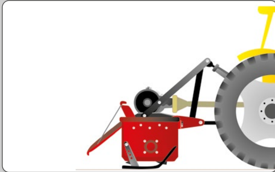
Figura 46 – Máquina com eixo cardã paralelo ao solo na posição ideal de trabalho.
