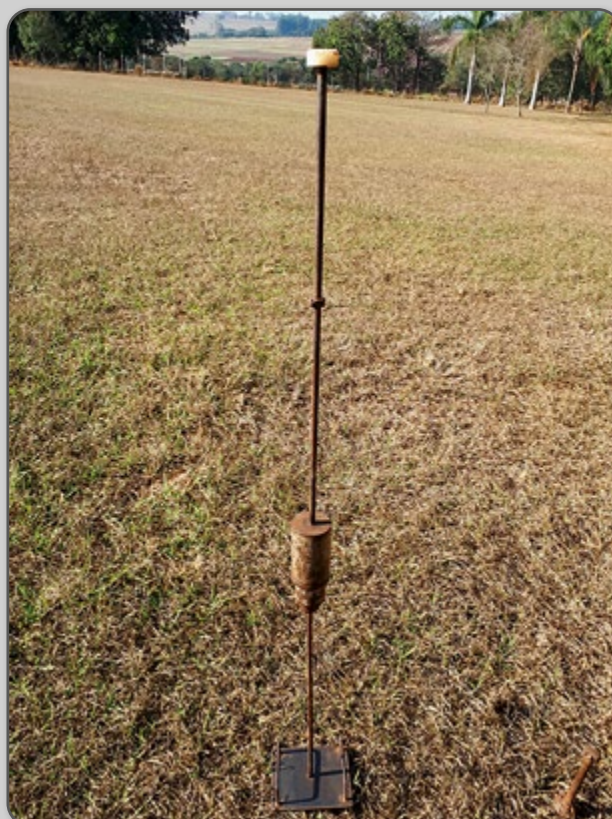
Figura 19 – Penetrômetro de impacto.
