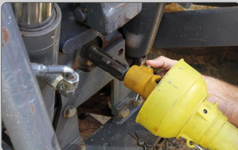
Figura 45 – Acoplamento do eixo cardã à TDP do trator.
