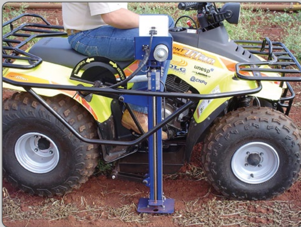
Figura 21 – Penetrógrafo acoplado a um quadriciclo.
