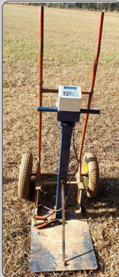
Figura 20 – Penetrógrafo com célula de carga.
