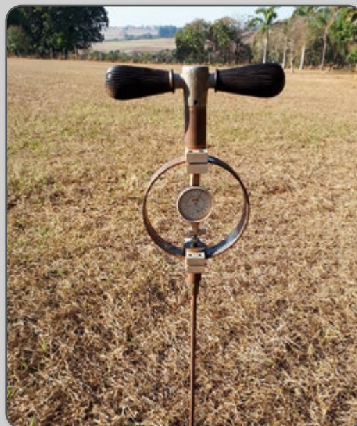
Figura 18 – Penetrômetro de mola.
