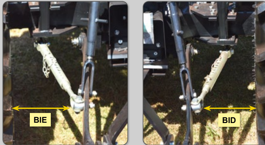
Figura 49 – Medição da distância dos braços de levante inferiores ao rodado.
