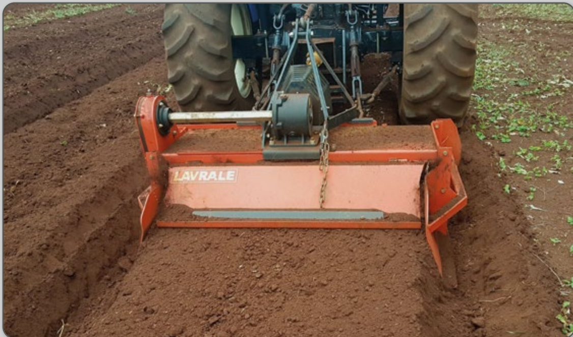
Figura 56 – Preparo do solo para horticultura com enxada rotativa.
