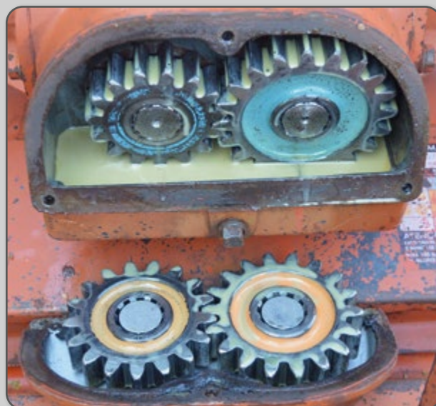
Figura 34 – Engrenagens de mudança de rotação dentro da caixa de transmissão.
