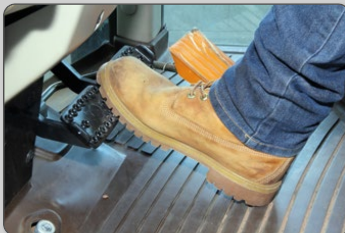
Figura 102 – Acionamento dos pedais de freio simultaneamente.
