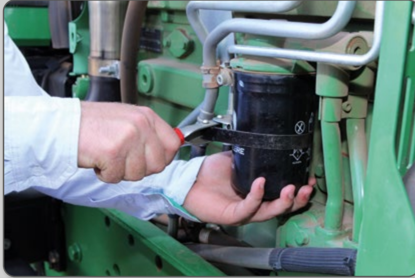
Figura 66 – Remoção do filtro de óleo.
