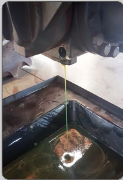
Figura 91 – Drenagem do óleo do diferencial dianteiro.
