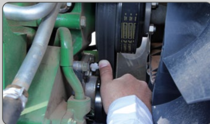
Figura 55 – Verificação da tensão da correia.
