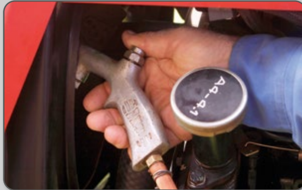
Figura 54 – Limpeza da colmeia do radiador com ar comprimido.
