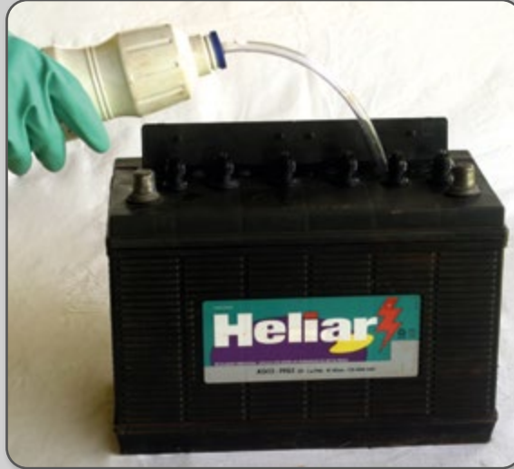
Figura 120 – Adição de água destilada na bateria.
