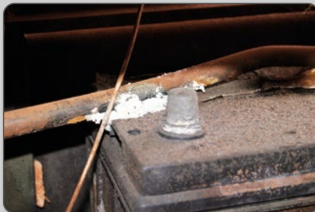
Figura 115 – Formação de zinabre na bateria.
