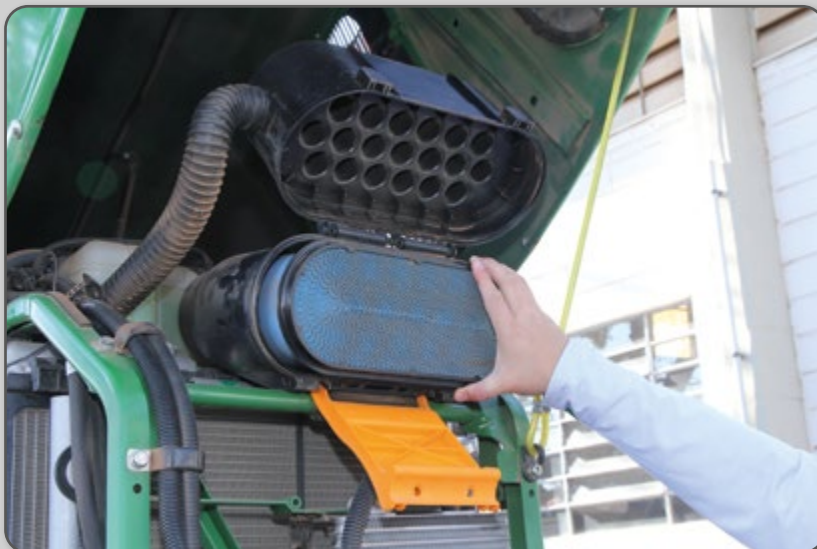
Figura 22 – Removendo o elemento filtrante principal.
