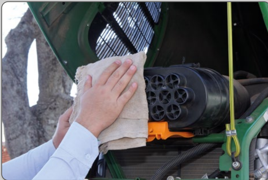
Figura 26 – Obstrução de ar no sistema de alimentação.
