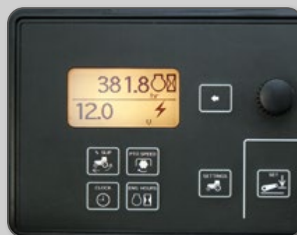
Figura 121 – Carga da bateria sendo exibida no painel de instrumentos do operador.
