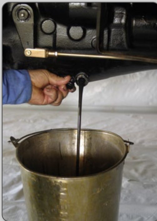
Figura 76 – Remoção do óleo da transmissão.
