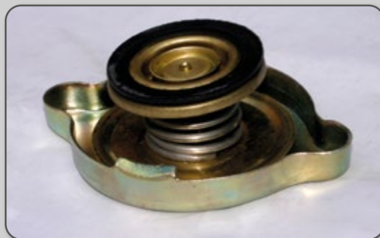
Figura 50 – Representação da mola e da vedação da tampa do radiador.
