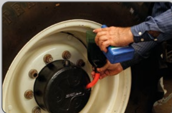
Figura 95 – Adição de óleo no redutor final dianteiro.
