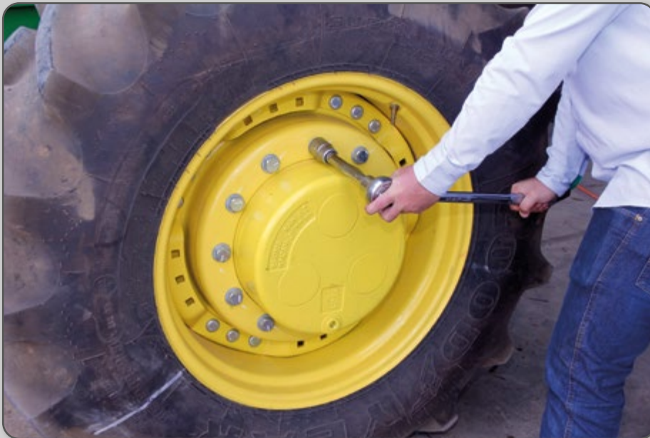
Figura 82 – Reaperto dos parafusos do rodado.
