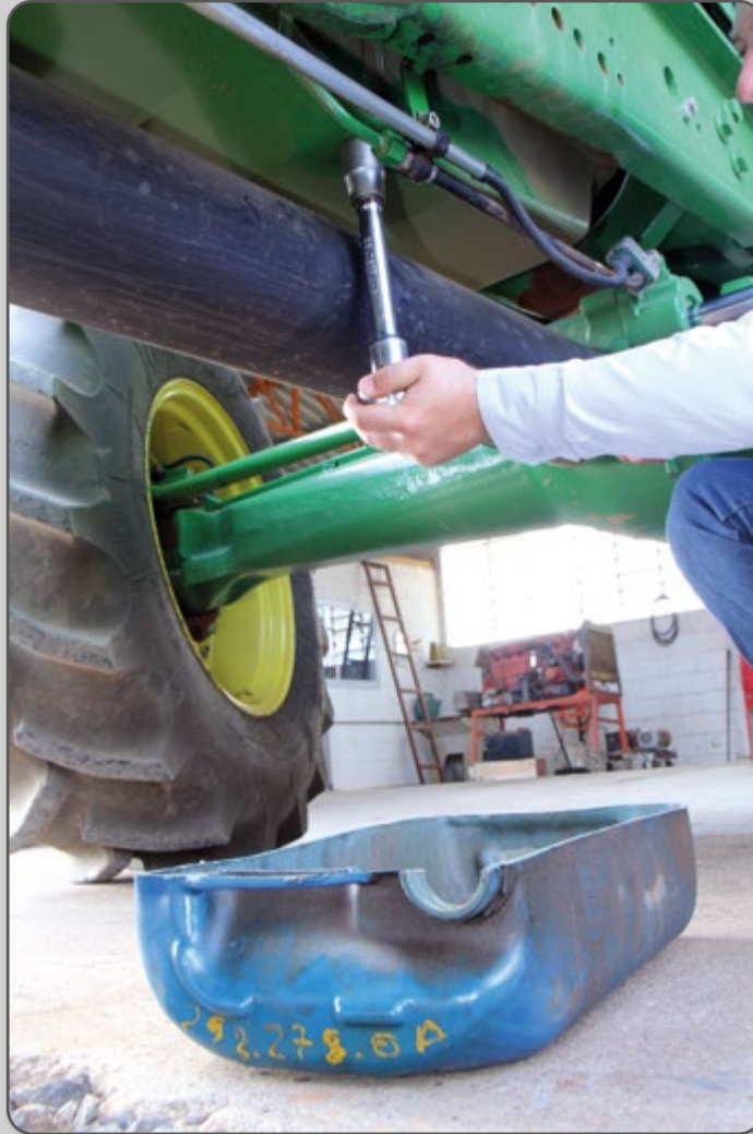
Figura 65 – Remoção do bujão de dreno do cárter.
