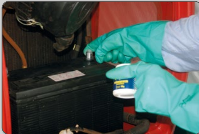
Figura 118 – Aplicação de vaselina nos bornes da bateria.
