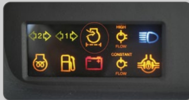
Figura 20 – Indicador de restrição do filtro de ar.
