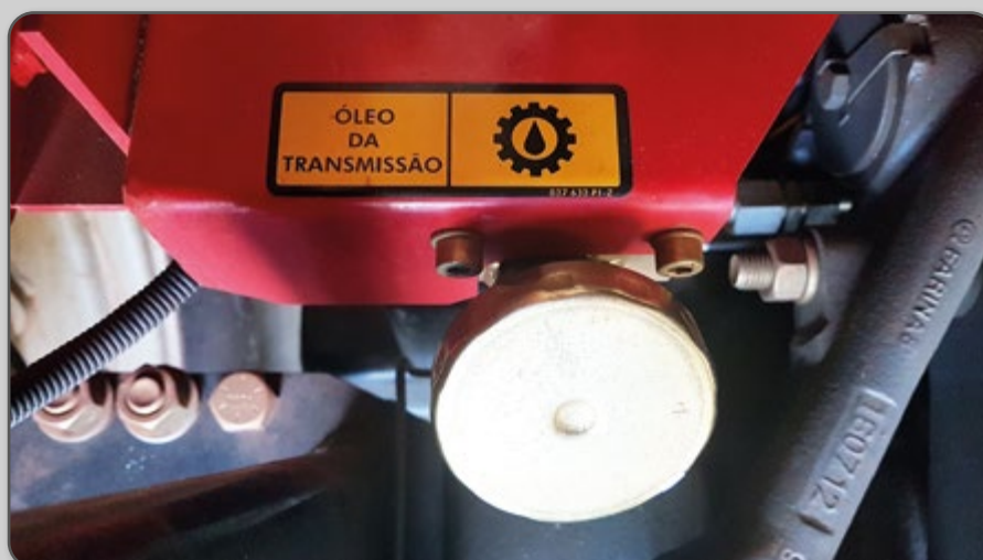
Figura 74 – Bocal para adição de óleo da transmissão.
