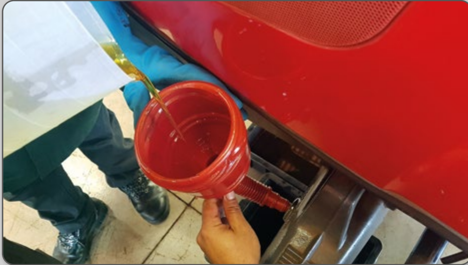
Figura 92 – Adição de óleo no diferencial dianteiro.
