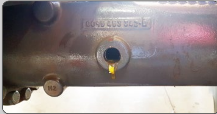
Figura 88 – Verificação do nível de óleo no diferencial dianteiro.
