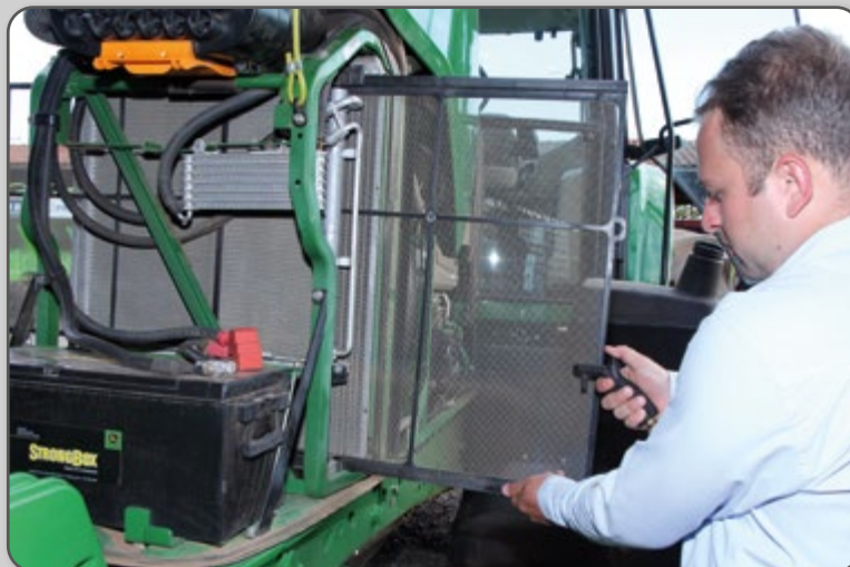
Figura 53 – Limpeza da tela do radiador com ar comprimido.
