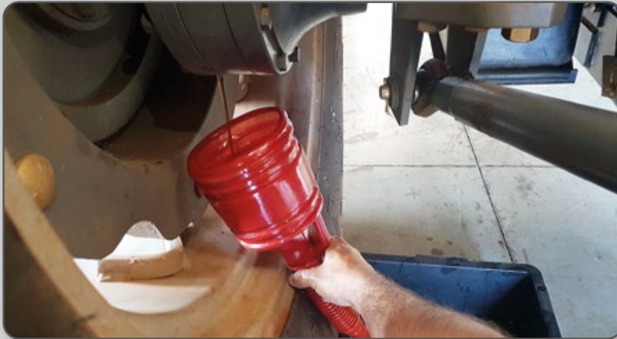
Figura 77 – Remoção do óleo nos redutores finais traseiros.
