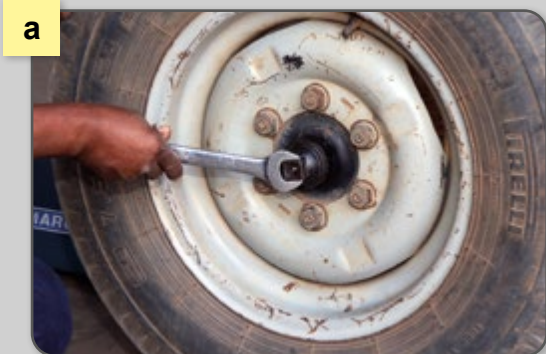
Figura 85 – Remoção a) da tampa do cubo e b) da trava da porca castelo.
