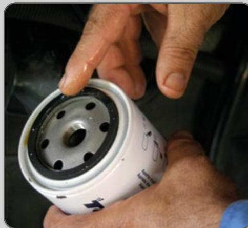
Figura 67 – Aplicação de óleo na junta do filtro.
