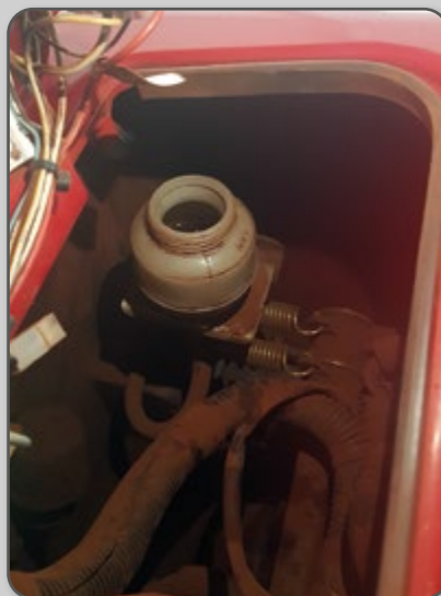
Figura 103 – Reservatório do fluido de freio.
