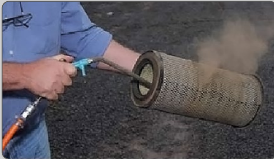
Figura 23 – Limpeza do filtro.
