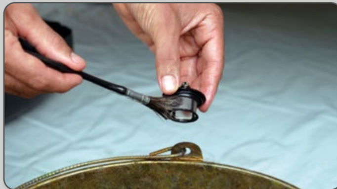
Figura 33 – Limpeza do filtro de tela da bomba alimentadora.
