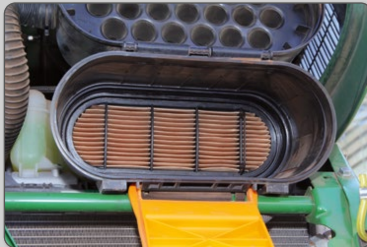
Figura 17 – Elemento filtrante de segurança.
