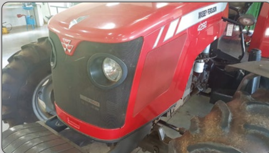
Figura 14 – Pré-purificação do ar por meio de tela no capô.
