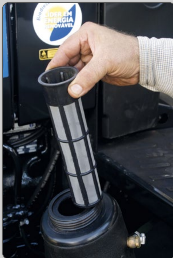
Figura 30 – Bocal do tanque com o filtro de abastecimento.
