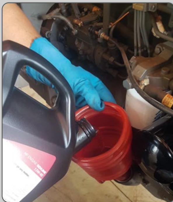
Figura 68 – Abastecimento de óleo lubrificante pelo bocal de abastecimento.
