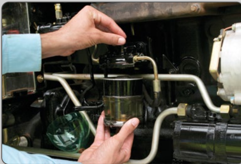
Figura 32 – Remoção do copo sedimentador.
