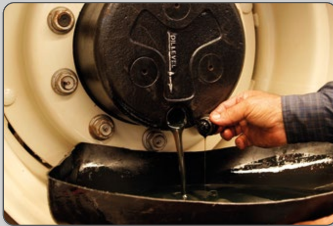
Figura 94 – Remoção do bujão na posição mais baixa.
