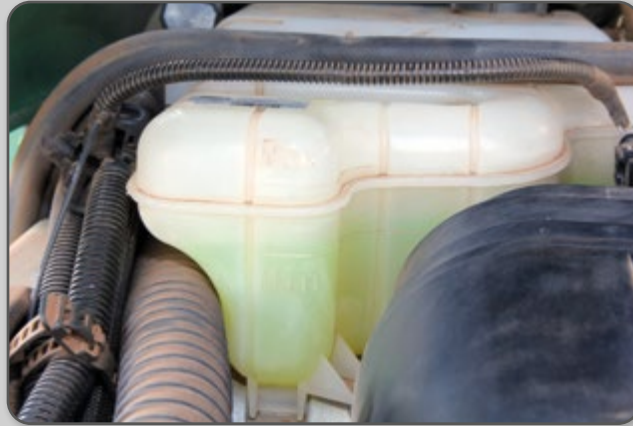
Figura 49 – Reservatório de expansão.
