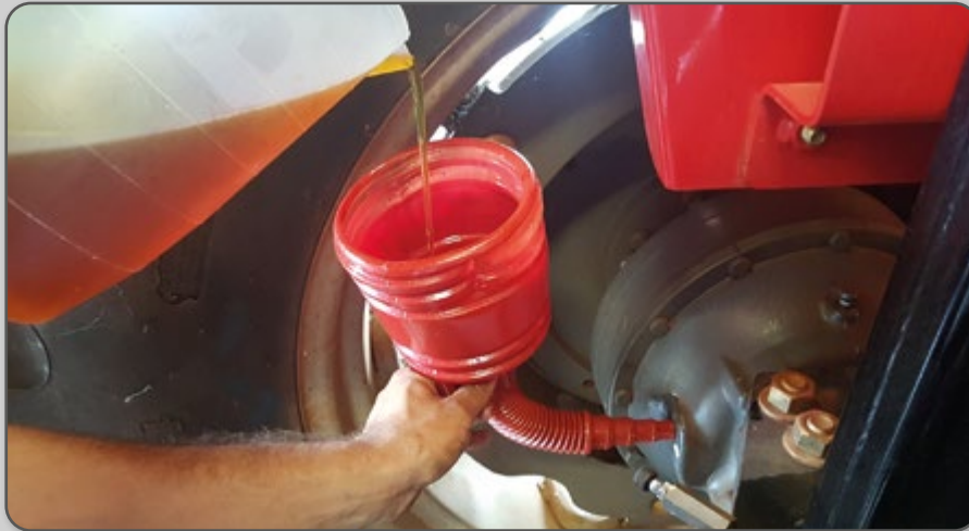
Figura 75 – Adição de óleo nos redutores finais traseiros.
