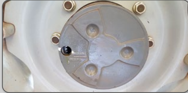
Figura 90 – Verificação do nível de óleo no redutor final dianteiro.
