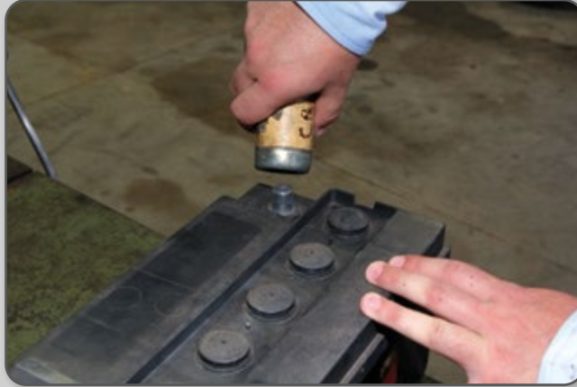
Figura 117 – Limpeza dos bornes da bateria com escova.
