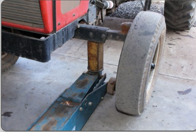
Figura 87 – Representação de um pneu com desgaste excessivo.
