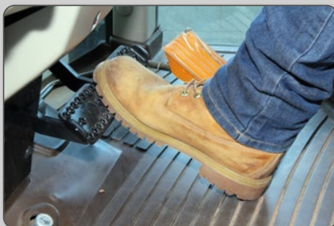
Figura 102 – Acionamento dos pedais de freio simultaneamente.
