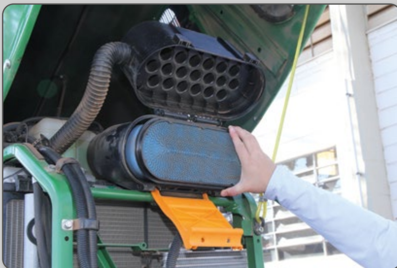
Figura 22 – Removendo o elemento filtrante principal.
