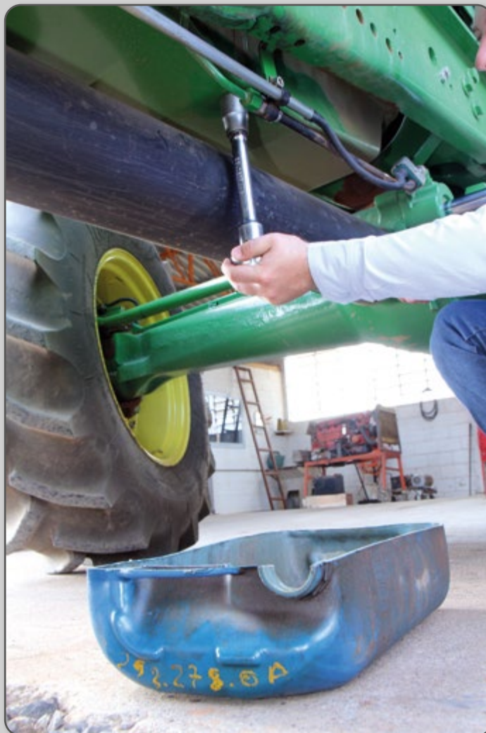
Figura 65 – Remoção do bujão de dreno do cárter.
