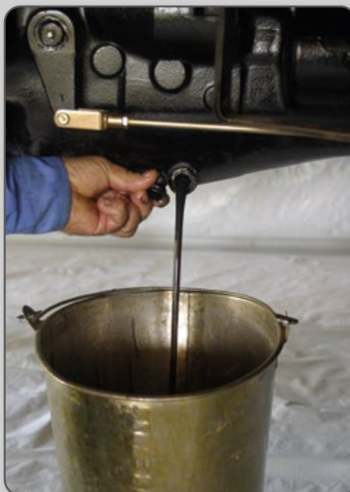
Figura 76 – Remoção do óleo da transmissão.
