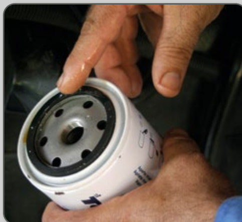
Figura 67 – Aplicação de óleo na junta do filtro.
