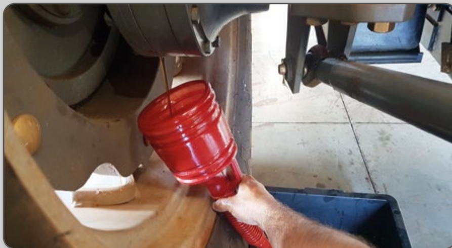
Figura 77 – Remoção do óleo nos redutores finais traseiros.
