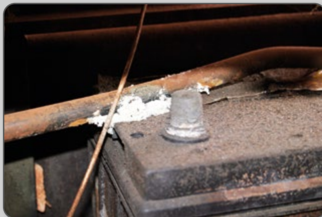
Figura 115 – Formação de zinabre na bateria.
