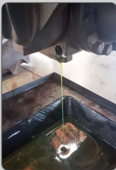
Figura 91 – Drenagem do óleo do diferencial dianteiro.
