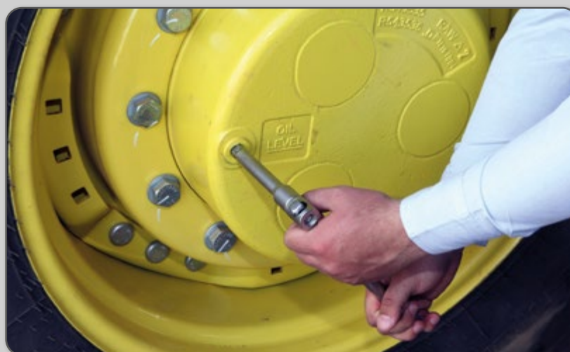
Figura 89 – Remoção do bujão do redutor da roda na posição horizontal.
