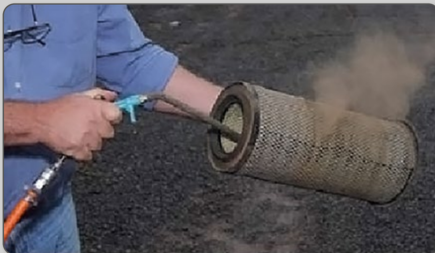
Figura 23 – Limpeza do filtro.
