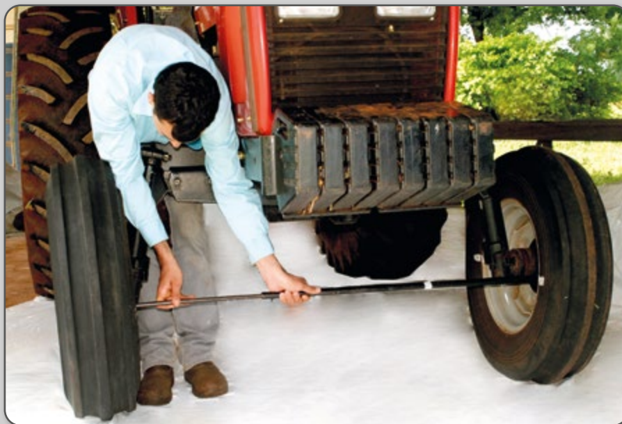
Figura 98 – Medição da abertura posterior das rodas em trator 4x2 (Parte da frente do aro).
