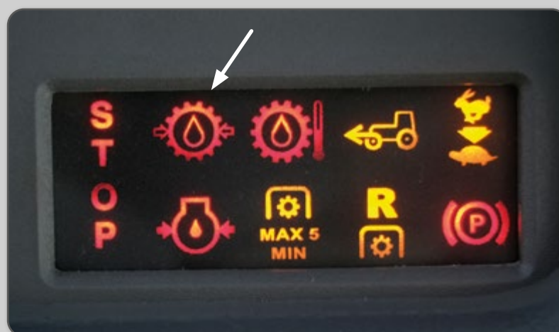
Figura 79 – Luz indicadora da pressão do óleo da transmissão.
