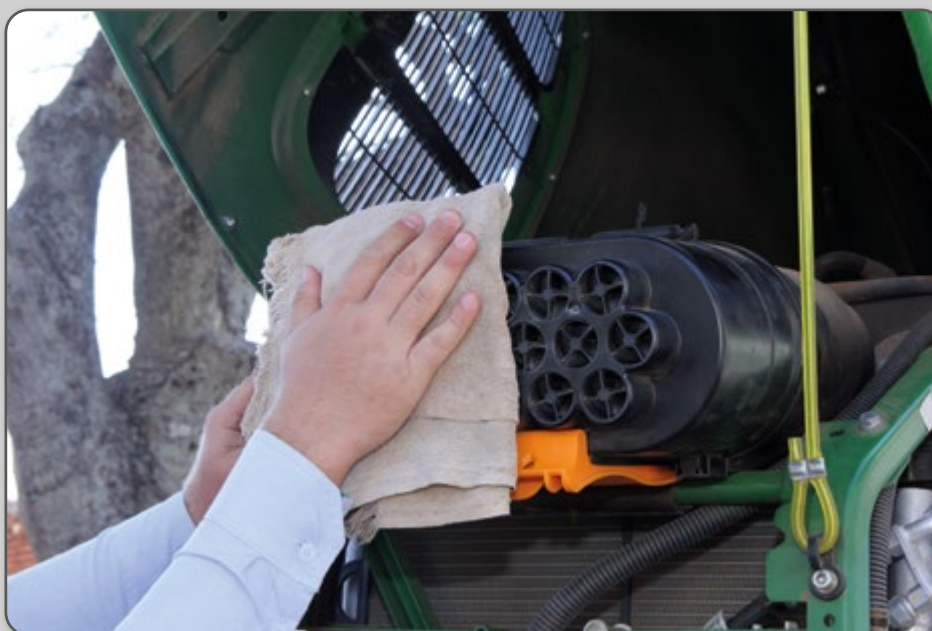
Figura 26 – Obstrução de ar no sistema de alimentação.
