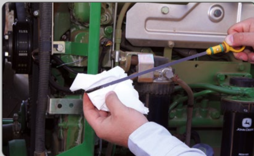
Figura 64 – Verificação do nível de óleo na vareta.
