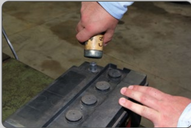
Figura 117 – Limpeza dos bornes da bateria com escova.
