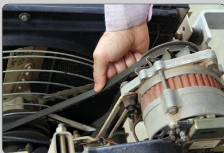
Figura 122 – Verificação da tensão da correia do alternador.
