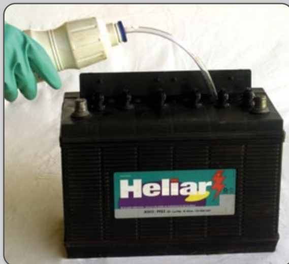
Figura 120 – Adição de água destilada na bateria.
