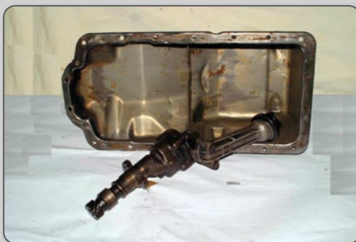
Figura 59 – Cárter e bomba de óleo do motor.
