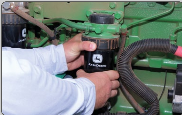
Figura 36 – Remoção de um filtro de combustível de forma manual.
