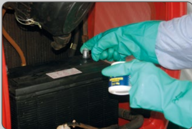
Figura 118 – Aplicação de vaselina nos bornes da bateria.
