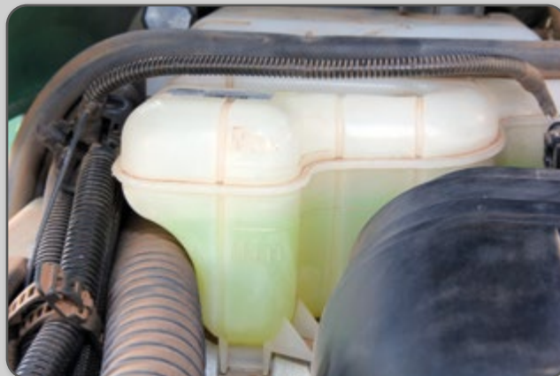
Figura 49 – Reservatório de expansão.
