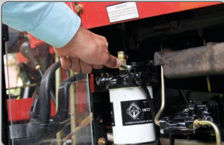
Figura 35 – Apertando o parafuso central após a colocação de filtro de combustível novo.
