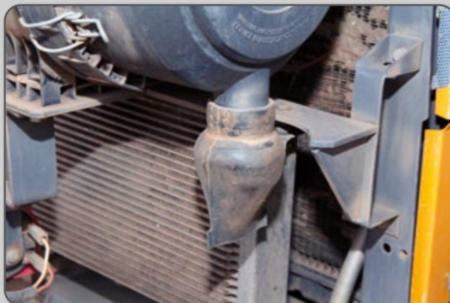
Figura 19 – Válvula de descarga do ejedor de poeira.
