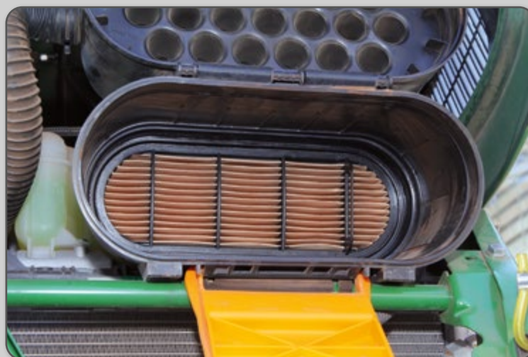
Figura 17 – Elemento filtrante de segurança.
