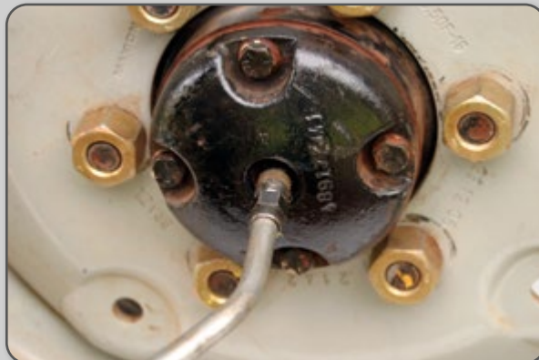
Figura 70 – Lubrificação com graxa.
