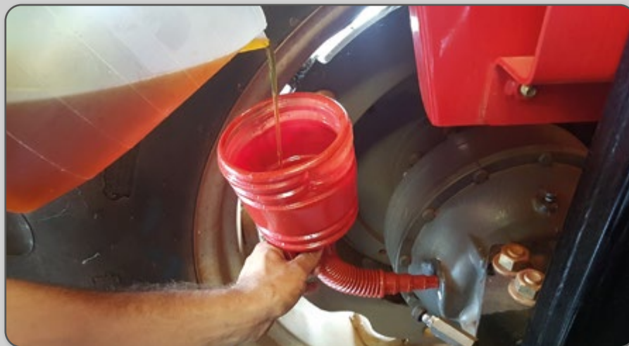
Figura 75 – Adição de óleo nos redutores finais traseiros.
