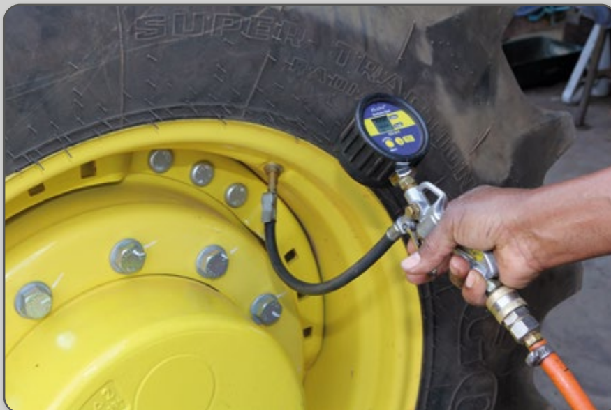
Figura 83 – Calibração dos pneus.
