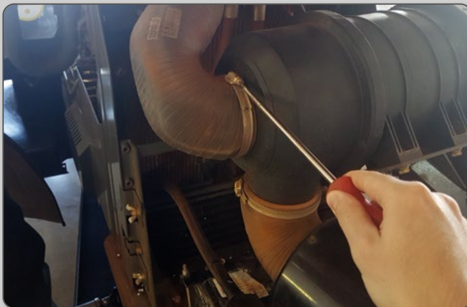
Figura 27 – Reaperto da abraçadeira do sistema de alimentação de ar.
