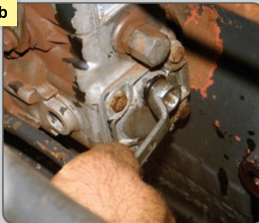
Figura 38 – a) Bujão de enchimento e b) Bujão de nível da bomba injetora.
