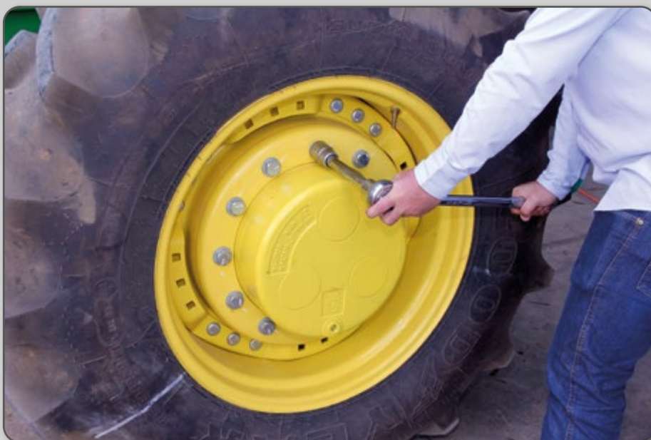
Figura 82 – Reaperto dos parafusos do rodado.
