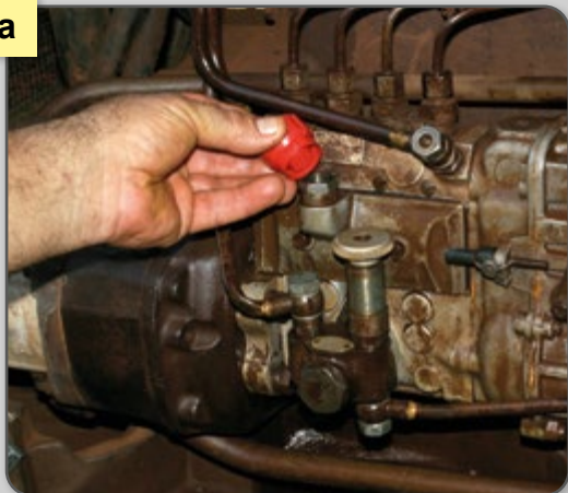
Figura 38 – a) Bujão de enchimento e b) Bujão de nível da bomba injetora.
