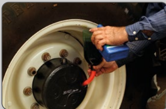
Figura 95 – Adição de óleo no redutor final dianteiro.
