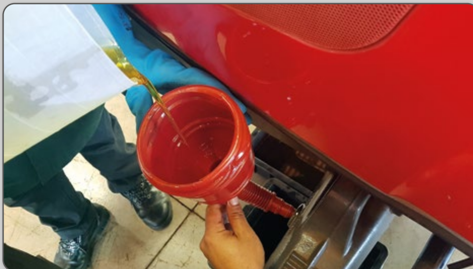
Figura 92 – Adição de óleo no diferencial dianteiro.
