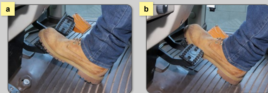
Figura 101 – Acionamento a) do freio esquerdo e b) do freio direito.
