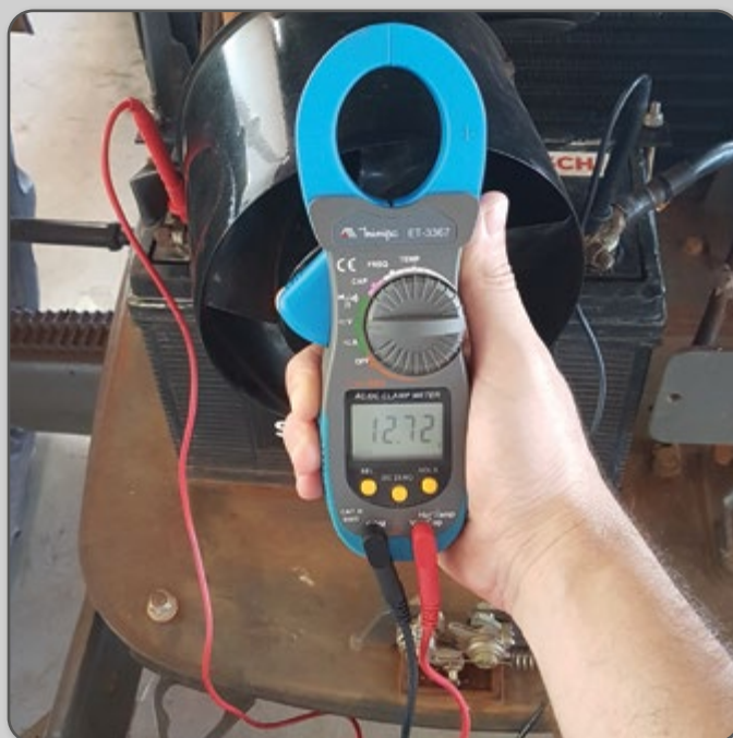
Figura 109 – Verificação da carga da bateria com multímetro.
