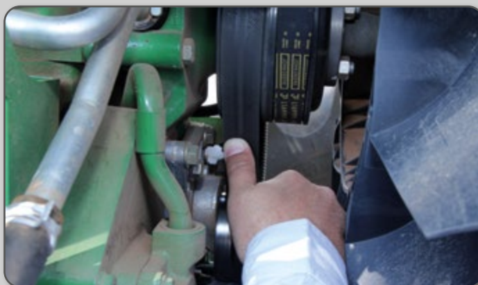
Figura 55 – Verificação da tensão da correia.
