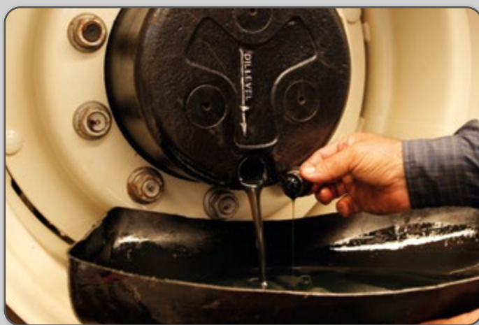
Figura 94 – Remoção do bujão na posição mais baixa.
