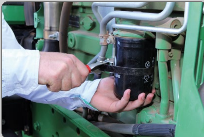
Figura 66 – Remoção do filtro de óleo.
