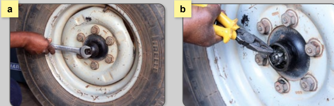
Figura 85 – Remoção a) da tampa do cubo e b) da trava da porca castelo.
