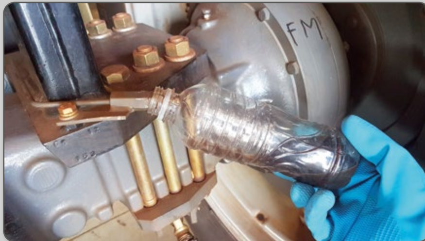
Figura 104 – Drenagem do fluido de freio.
