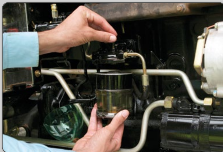
Figura 32 – Remoção do copo sedimentador.
