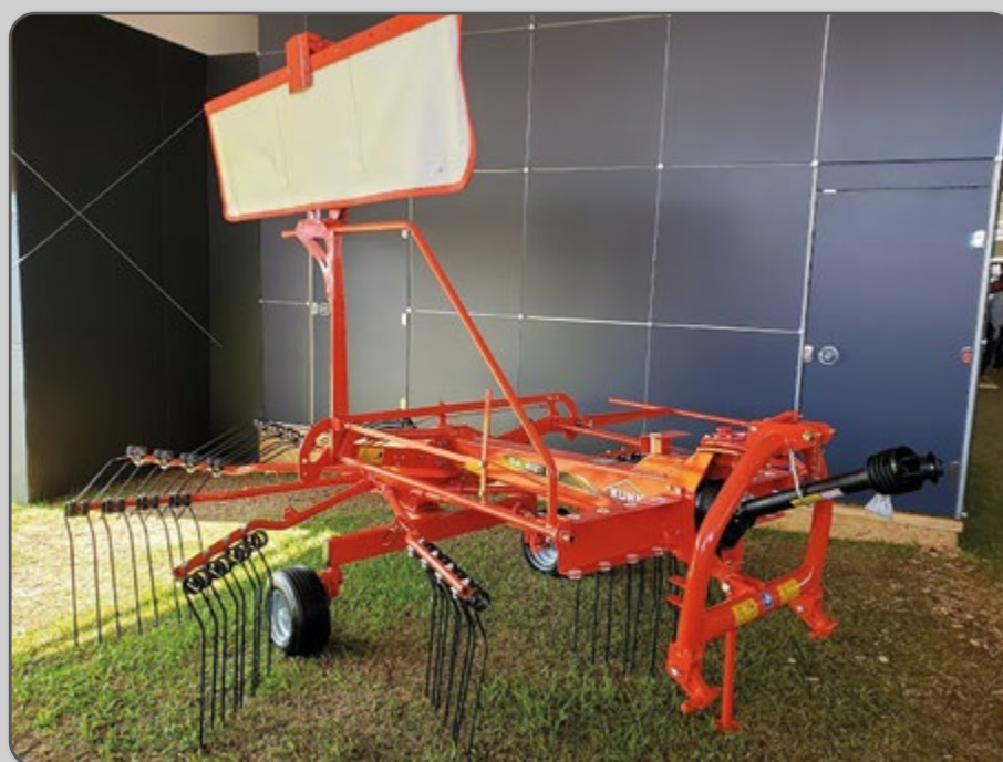
Figura 53 – Ancinhos enleiradores para preparar o material para ser recolhido pela enfardadora.
