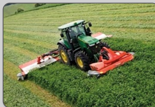
Figura 44 – Segadeira de linha de corte frontal e traseira, com largura de trabalho de 9 metros.
