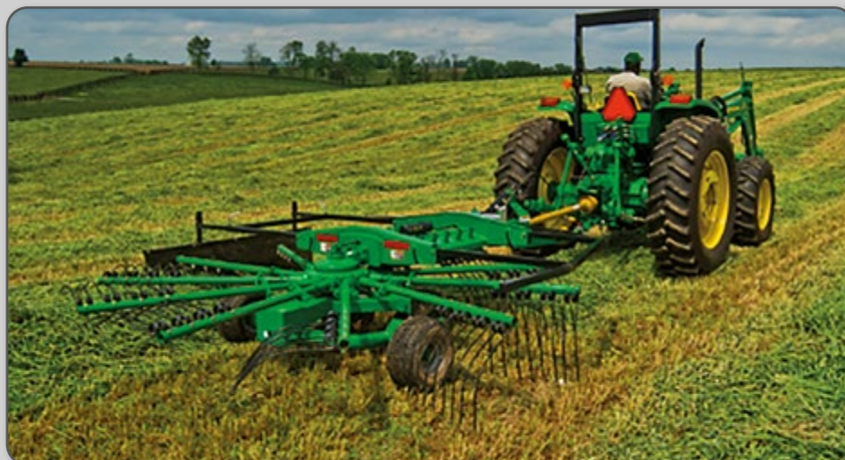
Figura 57 – Ancinho rotativo realizando o processo de revolvimento.
