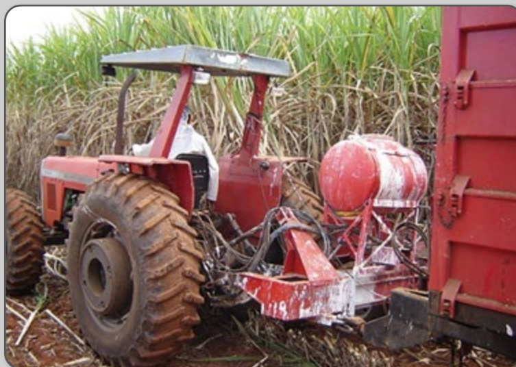
Figura 25 – Aplicação de cal virgem direto na colhedora.
