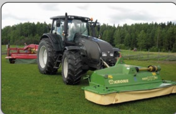
Figura 44 – Segadeira de linha de corte frontal e traseira, com largura de trabalho de 9 metros.
