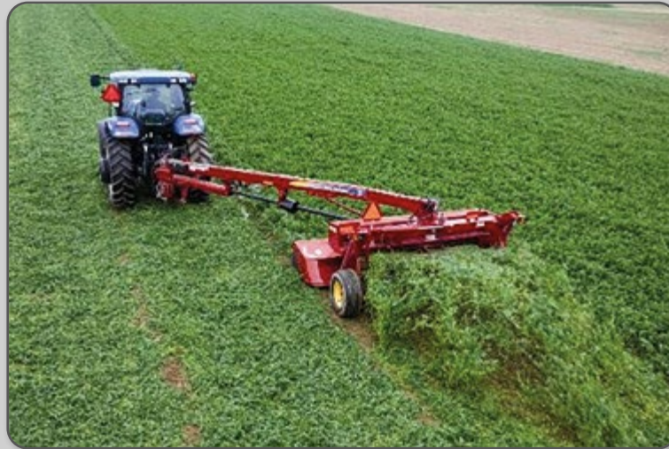
Figura 43 – Segadeira de arrasto, com visão dos discos de corte.
