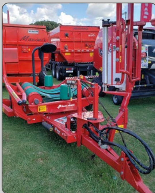
Figura 59 – Plastificadora para empacotamento do fardo.
