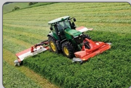
Figura 44 – Segadeira de linha de corte frontal e traseira, com largura de trabalho de 9 metros.
