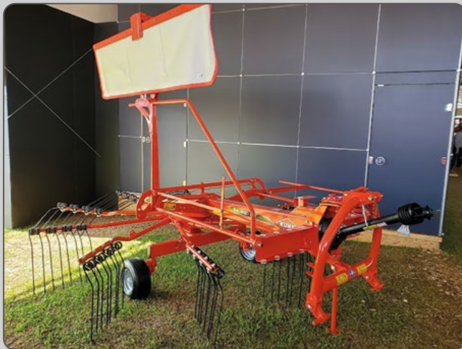
Figura 53 – Ancinhos enleiradores para preparar o material para ser recolhido pela enfardadora.
