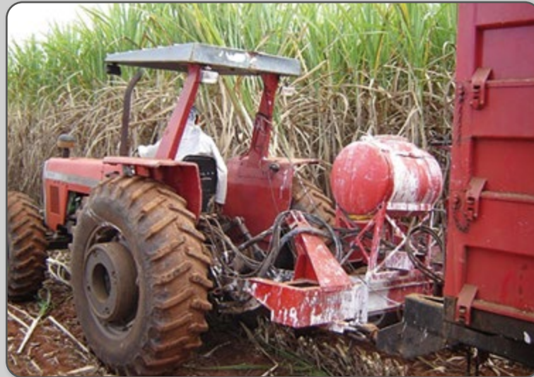
Figura 25 – Aplicação de cal virgem direto na colhedora.
