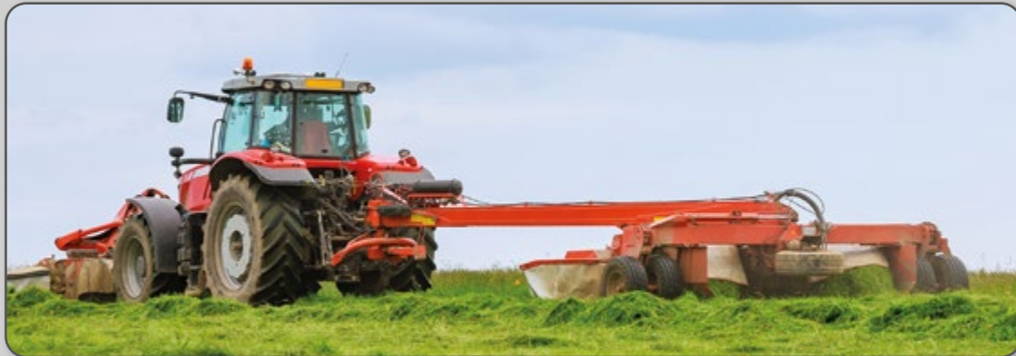
Figura 45 – Segadeira de arrasto realizando o corte pela parte frontal e expulsando a forragem colhida para trás.
