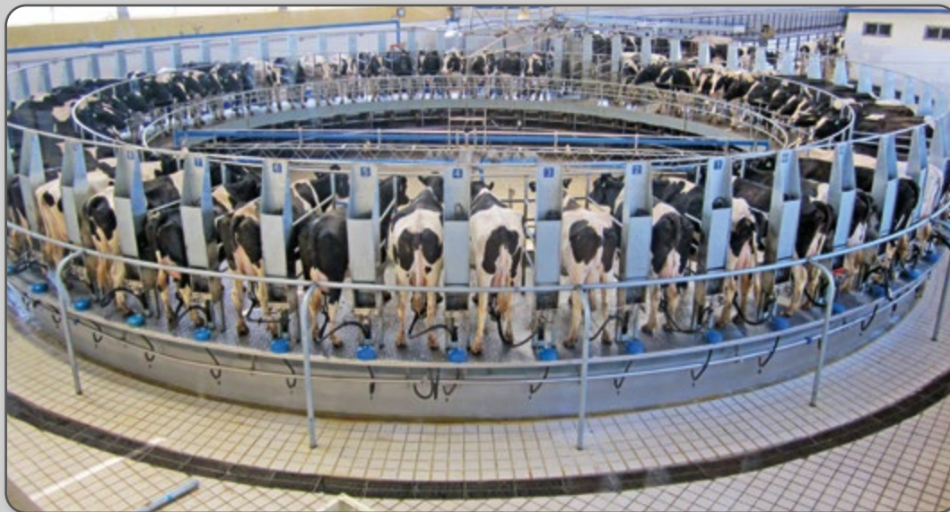
Figura 9 – Sala de ordenha com equipamento do tipo carrossel.
