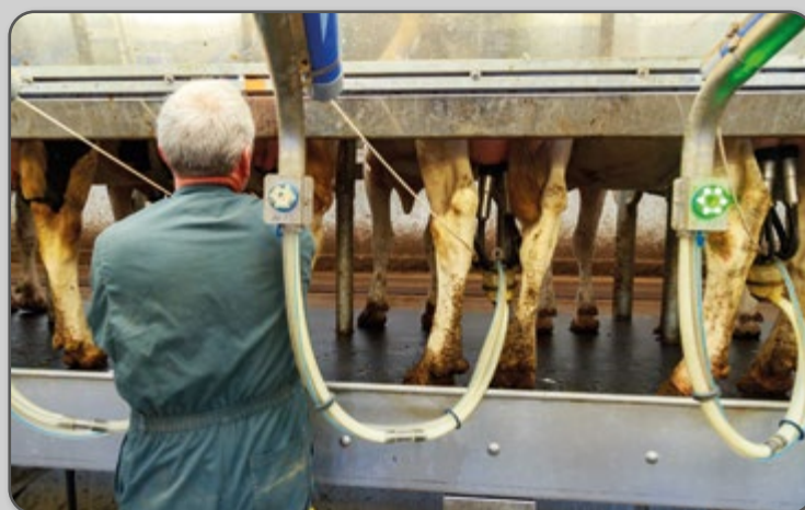
Figura 8 – Sala de ordenha com equipamento do tipo paralelo.
