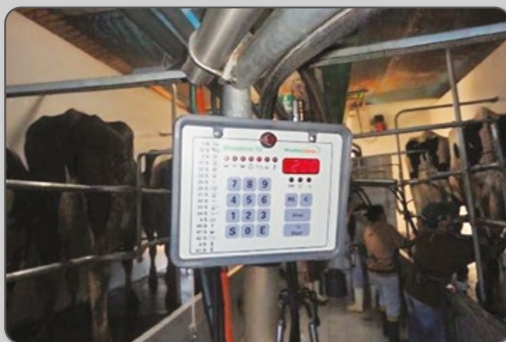
Figura 52 – Painel controlador do medidor de leite.
