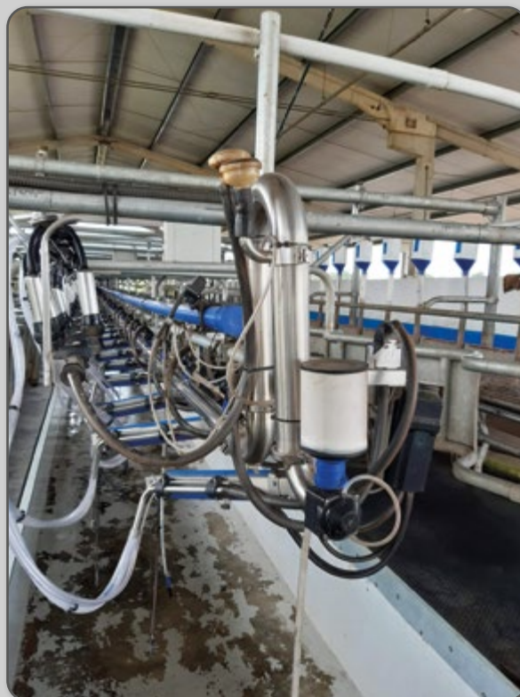
Figura 47 – Sistema trombone: injetor de água e ar simultâneo.
