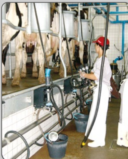
Figura 13 – Equipamento canalizado: linha baixa.
