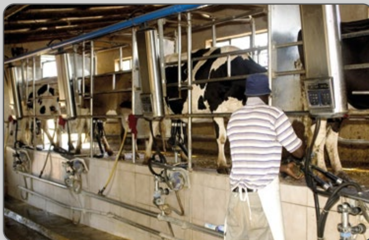
Figura 7 – Sala de ordenha com equipamento do tipo tandem.
