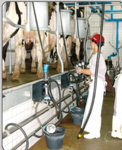
Figura 13 – Equipamento canalizado: linha baixa.
