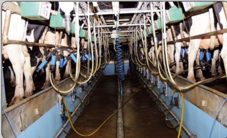
Figura 6 – Sala de ordenha com equipamento do tipo “espinha de peixe”.
