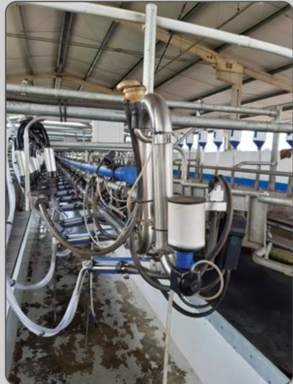
Figura 47 – Sistema trombone: injetor de água e ar simultâneo.
