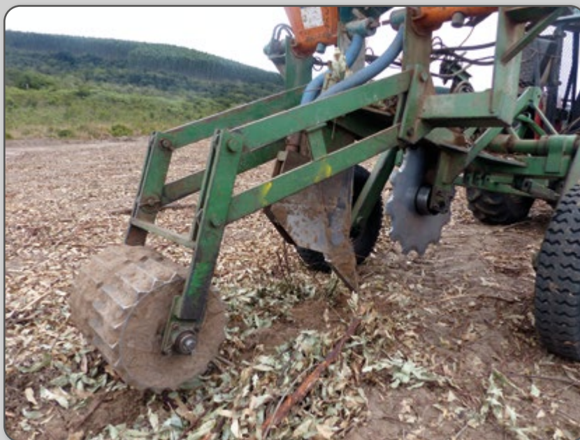
Figura 88 – Implemento florestal (subsolador + grade + disco).
