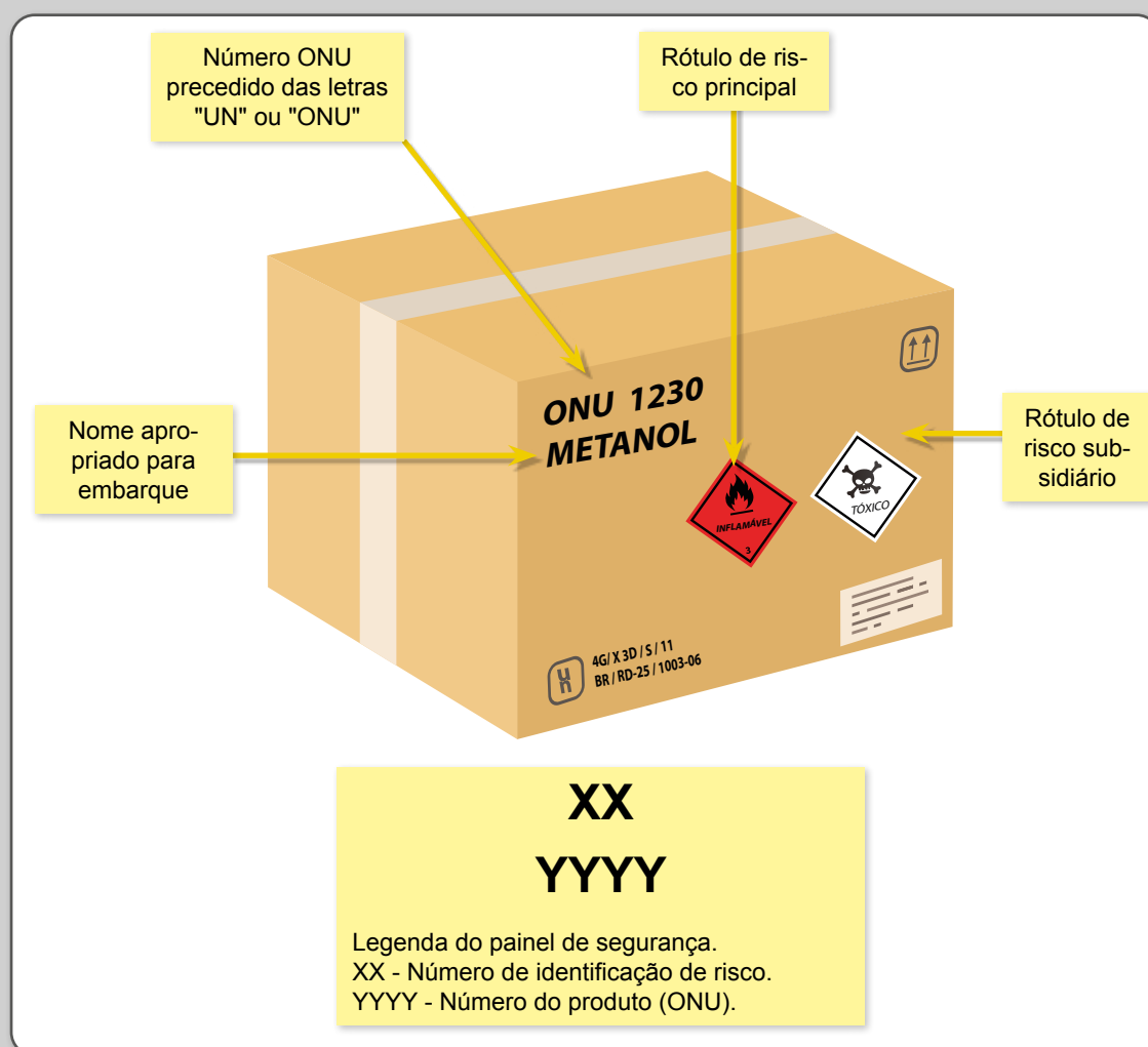
Figura 1 – Identificação do n° ONU na embalagem de agrotóxicos (acima) e no painel de segurança do veículo (abaixo).
