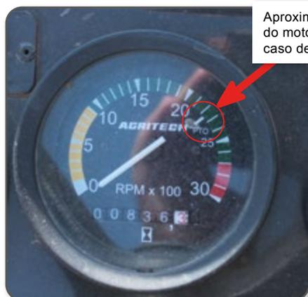
Aproximadamente 2250 rpm na rotação do motor para dar 540 rpm da TDP, para o caso deste trator.
