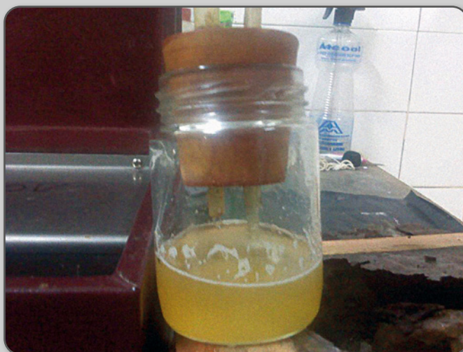
Figura 51 – Vidro adaptado em bomba de vácuo para extração de mel, sendo importante que as mangueiras dentro do vidro não se encostem ao mel
