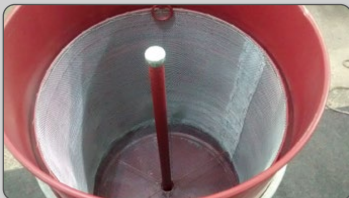
Figura 33 – Derretedor de cera a vapor
